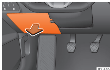
Abb. 216 Auf der Fahrerseite in der Instrumententafel: Abdeckung des Sicherungskastens.
