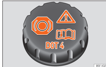
Abb. 224 Motorraum: Deckel des Bremsflüssigkeitsbehälters
