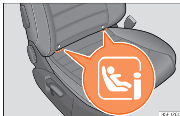
Abb. 40 Beifahrersitz: Einbaupunkt der Halteösen i-Size.
