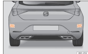
Abb. 128 Bereich hinter dem Fahrzeug: Bereiche der Radarsensoren.
