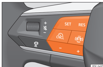
Abb. 132 Am Multifunktionslenkrad: Tasten zur Bedienung des Geschwindigkeitsbegrenzers.
