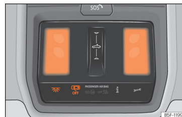
Abb. 105 Ausschnitt aus Dachhimmel: Innenbeleuchtung vorn.
