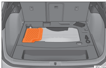
Abb. 231 Plug-in-Hybridfahrzeuge (PHEV): Einbauort der Batterie im Kofferraum
