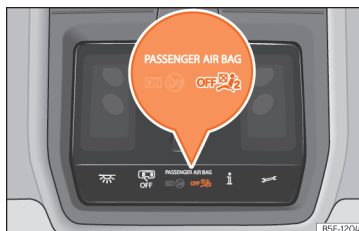
Abb. 28 In der Dachkonsole: Kontrollleuchte für Airbag Beifahrerseite aus.
