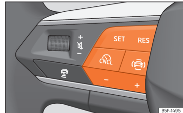
Abb. 131 Am Multifunktionslenkrad: Tasten zur Bedienung der Geschwindigkeitsregelanlage.
