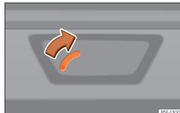
Abb. 84 Ausschnitt Gepäckraum: Notfallentriegelung (Leon Sportstourer).
