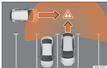
Abb. 158 Schematische Abbildung des Ausparkassistenten: Überwacher Bereich des ausparkenden Fahrzeugs.
