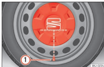
Abb. 192 Korrekte Anbringung der Radvollblende für Stahlfelgen.
