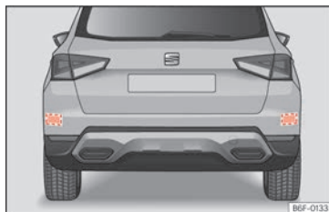
Abb. 95 Bereich hinter dem Fahrzeug: Bereiche der Radarsensoren.
