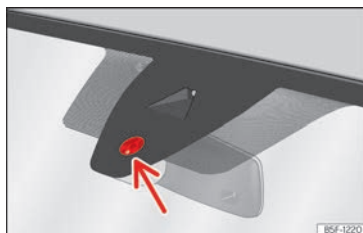
Abb. 74 Sensitive Fläche des Regensensors.
