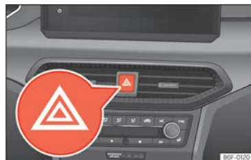
Abb. 41 Schalttafel: Schalter für die Warnblinkanlage
