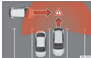
Abb. 130 Schematische Abbildung des Ausparkassistenten: Überwachter Bereich des ausparkenden Fahrzeugs.
