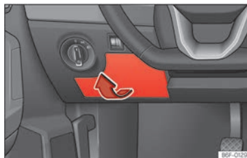
Abb. 167 Auf der Fahrerseite in der Schalttafel: Abdeckung des Sicherungskastens.
