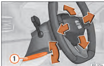
Abb. 68 Hebel auf der linken unteren Seite der Lenksäule.
