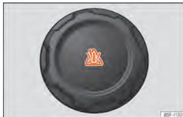
Abb. 209 Frontraum: Verschlussdeckel des Kühlmittelausgleichsbehälters.
