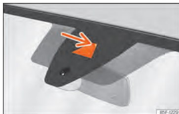
Abb. 107 An der Frontscheibe: Kamerasichtfenster des Spurhalteassistenten.
