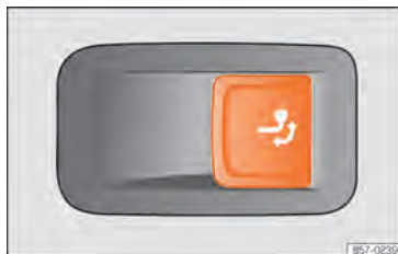
Abb. 182 Auf der rechten Seite im Gepäckraum: Taste zur Entriegelung der Anhängerkupplung.
