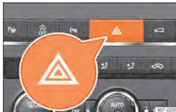
Abb. 41 Instrumententafel: Schalter für die Warnblinkanlage
