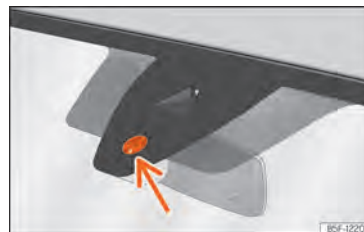
Abb. 85 Sensitive Fläche des Regensensors.
