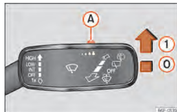
Abb. 84 Scheibenwischerhebel: Regensensor A einstellen.
