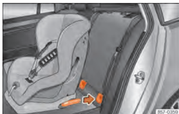
Abb. 37 Rückseite: Einbau des Kindersitzes mit dem ISOFIX-System.
