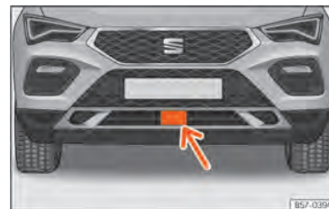
Abb. 105 Im vorderen Stoßfänger: Radarsensor.
