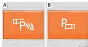
Abb. 135 Mittelkonsole: Taste für Einparkhilfe (je nach Ausführung).
