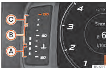
Abb. 6 Digitales Kombi-Instrument SEAT Digital Cockpit: Motorkühlmitteltemperatur-Anzeige.
