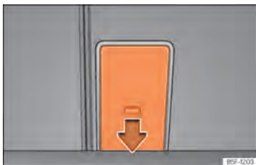
Abb. 179 Im Gepäckraum: Öffnung der Durchladeeinrichtung.
