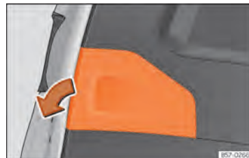
Abb. 204 Geöffnete Heckklappe: Abdeckung entfernen.
