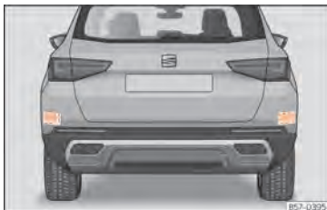
Abb. 108 Bereich hinter dem Fahrzeug: Bereiche der Radarsensoren.
