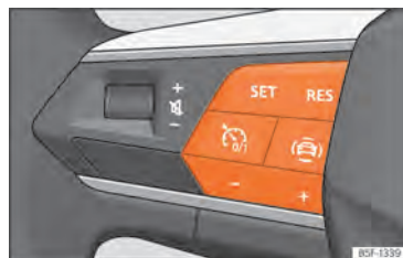
Abb. 112 Am Multifunktionslenkrad: Tasten zur Bedienung des Geschwindigkeitsbegrenzers.
