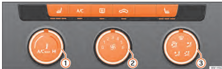
Abb. 90 In der Mittelkonsole: Bedienelemente der manuellen Klimaanlage.
