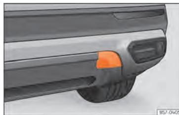
Abb. 198 Auf der rechten Seite des hinteren Stoßfängers: Abdeckung entfernen.
