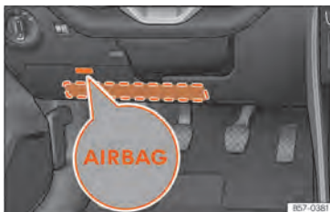
Abb. 31 Auf der Fahrerseite: Einbauort des Knieairbags.
