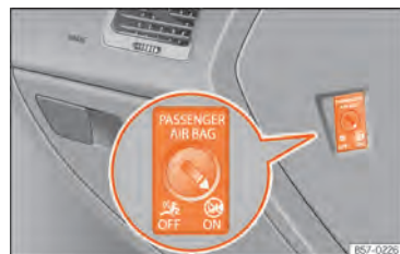
Abb. 26 Schlüsselschalter zum Ein- und Abschalten des Beifahrerairbags.
