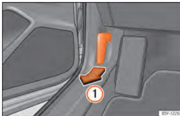
Abb. 206 Entriegelungshebel im Fahrerfußraum.
