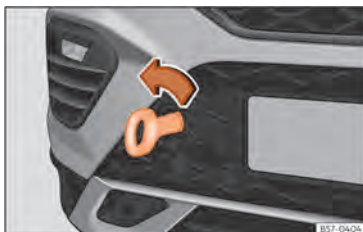
Abb. 197 Vorderer Stoßfänger rechts: Eingeschraubte Abschleppöse
