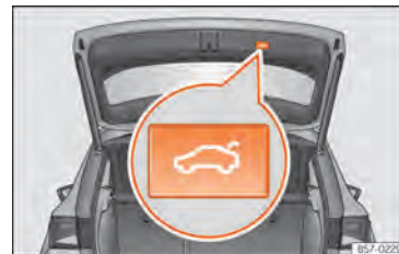
Abb. 57 Heckklappe: Taste zum Schließen der Heckklappe.
