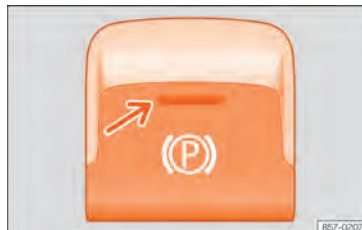
Abb. 131 Im unteren Bereich der Mittelkonsole: Taste für die elektronische Parkbremse.
