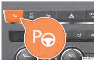
Abb. 138 In der Mittelkonsole oben: Taste zum Einschalten des Parklenkassistenten.
