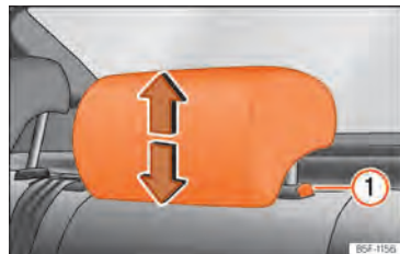
Abb. 73 Kopfstütze hinten: Kopfstützeinstellung.
