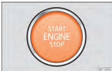
Abb. 94 Im unteren Bereich der Mittelkonsole: Starterknopf.
