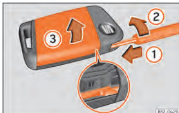
Abb. 46 Fahrzeugschlüssel: Deckel des Batteriefachs öffnen.
