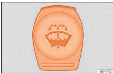
Abb. 211 Im Motorraum: Blauer Deckel des Scheibenwaschbehälters.
