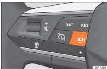
Abb. 104 Linke Seite des Multifunktionslenkrads: Taste für die Fahrerassistenzsysteme (modellabhängig).
