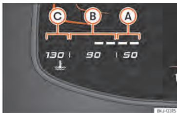
Abb. 5 Digitales Kombi-Instrument Basic: Motorkühlmitteltemperatur-Anzeige.
