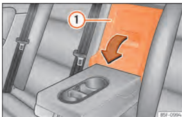
Abb. 178 An der Rücksitzlehne: Öffnung der Durchladeeinrichtung.
