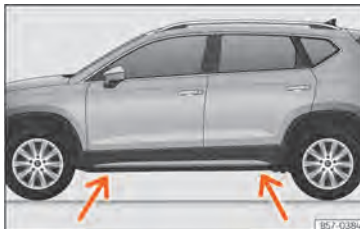
Abb. 226 Aufnahmepunkte für den Wagenheber.
