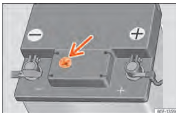
Abb. 216 Sichtfenster an der Oberseite der 12-Volt-Fahrzeugbatterie (Prinzipdarstellung).
