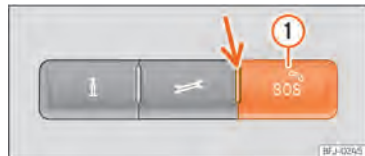
Abb. 42 In der Dachkonsole: Schalter für Sprachdienste
