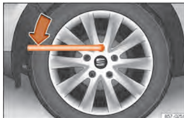
Abb. 224 Radwechsel: Radschrauben lockern.
