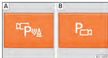
Abb. 147 Mittelkonsole: Taste zum manuellen Ein-/Ausschalten der Rundumsicht in Verbindung mit dem Parklenkassistenten ([A]) oder mit dem hinteren Park Pilot ([B]).
