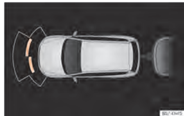
Abb. 134 Bildschirmanzeige der Einparkhilfe im Anhängerbetrieb.
