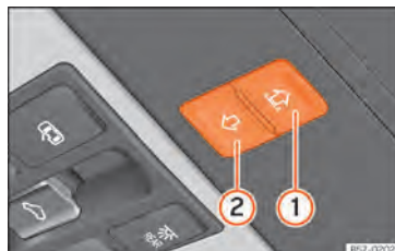
Abb. 65 Im Dachhimmel: Funktionsfläche zur Bedienung des Sonnenschutzrollos.
