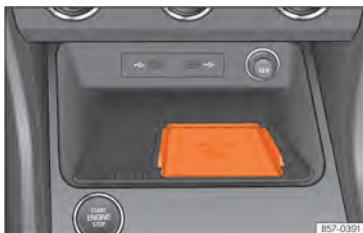
Abb. 166 In der Mittelkonsole: Aufnahme für die Mobiltelefonkopplung.
