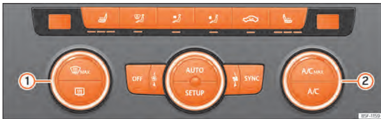
Abb. 89 In der Mittelkonsole: Bedienelemente der Climatronic.
