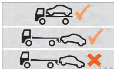
Abb. 195 Mit einem Abschleppfahrzeug transportieren: Fahrzeuge mit automatischem Getriebe und Frontantrieb.
