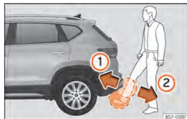
Abb. 59 Heckklappe mit sensorgesteuerter Öffnung [Easy Open].
