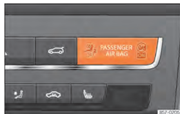
Abb. 27 Schalttafel: Kontrollleuchte für abgeschalteten Beifahrerairbag.
