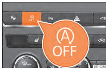
Abb. 96 Mittelkonsole: Systemtaste Start-Stopp.
