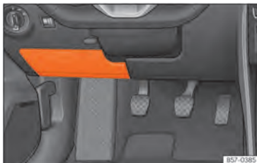
Abb. 200 Auf der Fahrerseite in der Instrumententafel: Abdeckung des Sicherungskastens.
