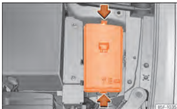
Abb. 202 Im Motorraum: Abdeckung des Sicherungskastens.
