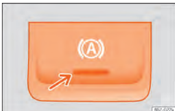
Abb. 132 Im unteren Bereich der Mittelkonsole: Funktionstaste Auto Hold.
