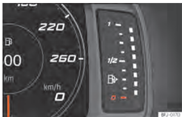
Abb. 4 Kombi-Instrument SEAT Digital Cockpit: Kraftstoffvorratsanzeige.
