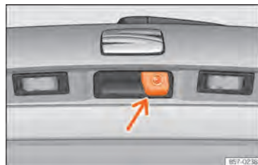
Abb. 110 Im Griff der Heckklappe: Umfeldkamera.
