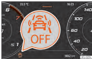
Abb. 123 Auf dem Display des Kombi-Instruments: Anzeige, dass Front Assist ausgeschaltet ist.
