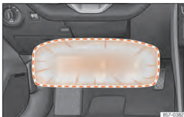
Abb. 32 Auf der Fahrerseite: Wirkungsbereich des Knieairbags.
