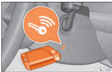
Abb. 95 Rechts an der Lenksäule: Notstart.
