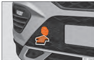
Abb. 196 Auf der rechten Seite des vorderen Stoßfängers: Abdeckung entfernen.
