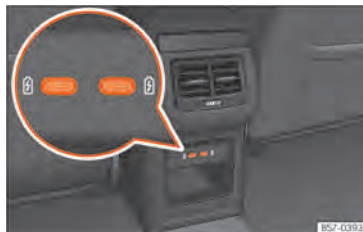
Abb. 159 Mittelkonsole hinten: USB-Anschlüsse mit Steckdosenfunktion.
