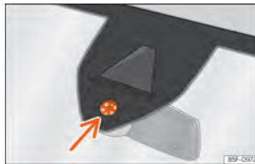
Abb. 91 Feuchtigkeits- und Temperatursensor der Windschutzscheibe.
