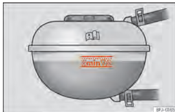
Abb. 208 Im Frontraum: Markierung am Kühlmittelausgleichsbehälter.
