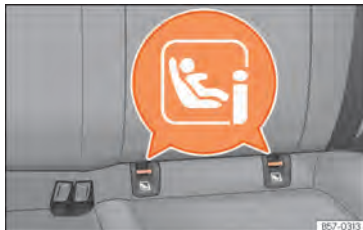
Abb. 36 Rückseite: Einbauort der Halteösen ISOFIX oder i-Size.
