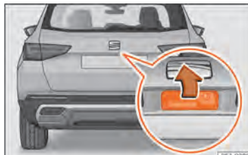
Abb. 56 Heckklappe: Öffnen von außen
