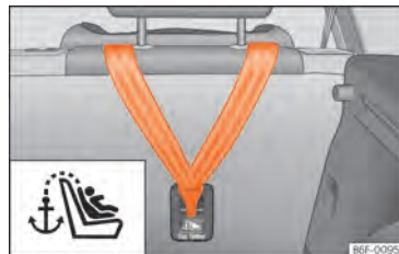
Abb. 38 Rückseite der Rücksitzbank: Halteösen für den Top Tether Haltegurt.
