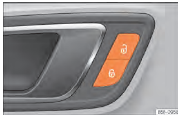
Abb. 51 An der Fahrertür: Zentralverriegelungstaster.
