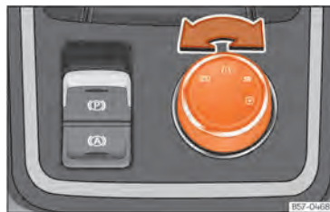
Abb. 102 Mittelkonsole: Drehschalter (Driving Experience button).
