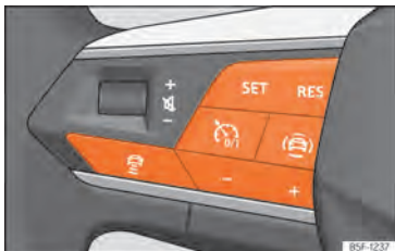
Abb. 115 Am Multifunktionslenkrad: Tasten zur ACC-Bedienung.
