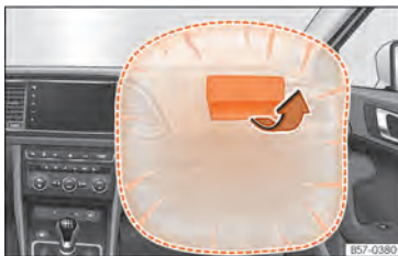
Abb. 25 Beifahrerairbag in der Instrumententafel
