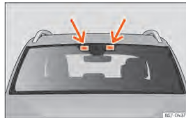
Abb. 92 Bereiche für das Anbringen elektronischen Zubehörs.
