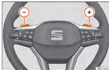
Abb. 100 Lenkrad: die Hebel für Automatikgetriebe.
