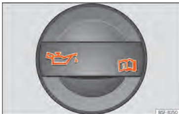
Abb. 215 Deckel der Motoröl-Einfüllöffnung im Motorraum.
