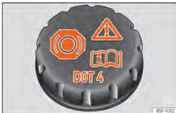
Abb. 210 Motorraum: Deckel des Bremsflüssigkeitsbehälters.
