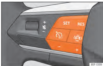
Abb. 111 Am Multifunktionslenkrad: Tasten zur Bedienung der Geschwindigkeitsregelanlage.
