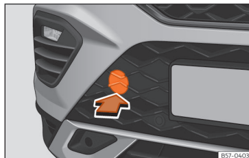
Abb. 194 Auf der rechten Seite des vorderen Stoßfängers: Abdeckung entfernen.
