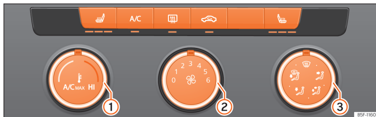
Abb. 93 In der Mittelkonsole: Bedienelemente der manuellen Klimaanlage.
