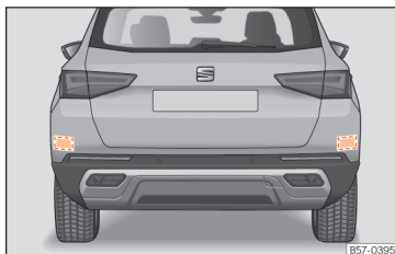
Abb. 111 Bereich hinter dem Fahrzeug: Bereiche der Radarsensoren.
