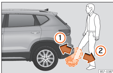
Abb. 62 Heckklappe mit sensorgesteuerter Öffnung (Easy Open).
