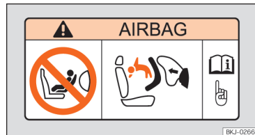
Abb. 37 Airbag-Label: an der Sonnenblende Beifahrerseite.
