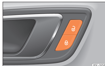
Abb. 54 In der Fahrertür: Zentralverriegelungstaster.
