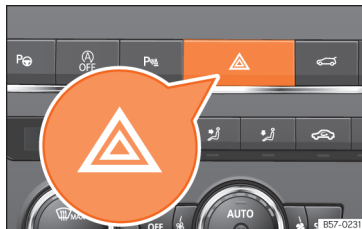
Abb. 44 Instrumententafel: Schalter für die Warnblinkanlage
