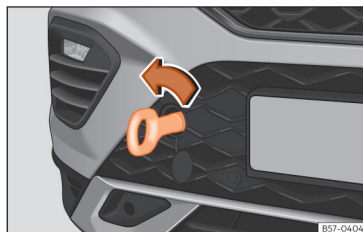
Abb. 195 Vorderer Stoßfänger rechts: Eingeschraubte Abschleppöse
