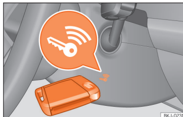
Abb. 98 Rechts an der Lenksäule: Notstart.
