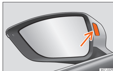
Abb. 127 Kontrollleuchte des Spurwechselassistenten.
