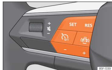
Abb. 114 Am Multifunktionslenkrad: Tasten zur Bedienung der Geschwindigkeitsregelanlage.
