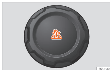
Abb. 207 Frontraum: Verschlussdeckel des Kühlmittelausgleichsbehälters.
