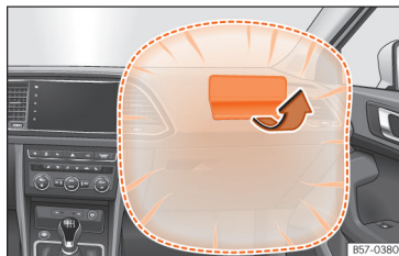
Abb. 28 Beifahrerairbag in der Instrumententafel
