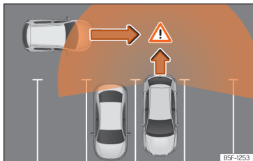
Abb. 151 Schematische Abbildung des Ausparkassistenten: Überwachter Bereich des ausparkenden Fahrzeugs.
