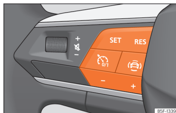
Abb. 115 Am Multifunktionslenkrad: Tasten zur Bedienung des Geschwindigkeitsbegrenzers.
