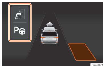
Abb. 139 Am Bildschirm des Kombi-Instruments: Anzeige des Parklenkassistenten mit eingeschränkter Sicht.
