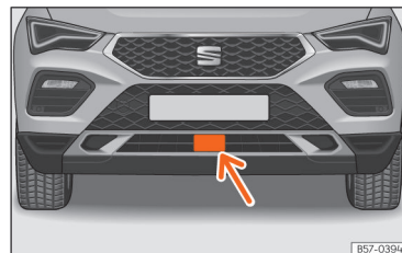
Abb. 108 Im vorderen Stoßfänger: Radarsensor.
