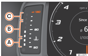
Abb. 8 Digitales Kombi-Instrument SEAT Digital Cockpit: Motorkühlmitteltemperatur-Anzeige.
