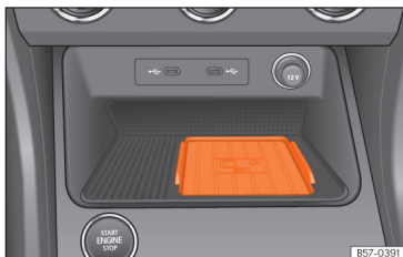
Abb. 165 In der Mittelkonsole: Aufnahme für die Mobiltelefonkopplung.
