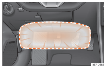
Abb. 35 Auf der Fahrerseite: Wirkungsbereich des Knieairbags.
