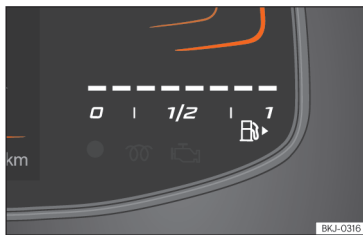
Abb. 5 Kombi-Instrument Basic: Kraftstoffvorratsanzeige.
