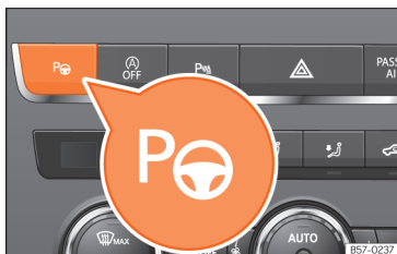
Abb. 138 In der Mittelkonsole oben: Taster für Parklenkassistent.
