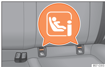
Abb. 39 Rücksitz: Einbauort der Halteösen ISOFIX oder i-Size.
