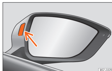
Abb. 128 Kontrollleuchte des Spurwechselassistenten.
