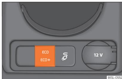
Abb. 138 Im unteren Teil der Mittelkonsole: Fahrprofilauswahltaste.
