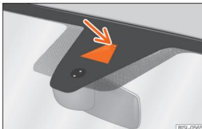
**Abb. 140** An der Windschutzscheibe: Kamerasichtfenster des Spurhalteassistenten.
