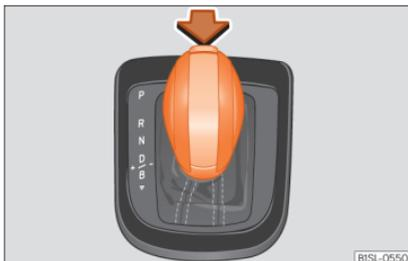
Abb. 137 Wählhebel für Fahrstufenauswahl
