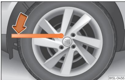
Abb. 33 Radwechsel: Radschrauben lockern.
