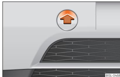
**Abb. 42** Stoßfänger vorn rechts: Abdeckung entfernen.
