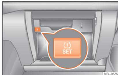
**Abb. 171** im Handschuhfach: Taste für die Reifendruckkontrollanzeige.
