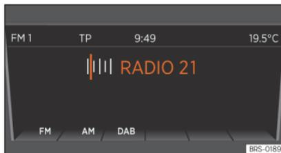
**Abb. 119** Hauptmenü RADIO: Speicherebene und Frequenzbereich auswählen.
