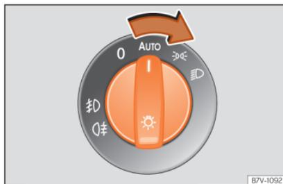
**Abb. 78** Instrumententafel: Lichtschalter.
