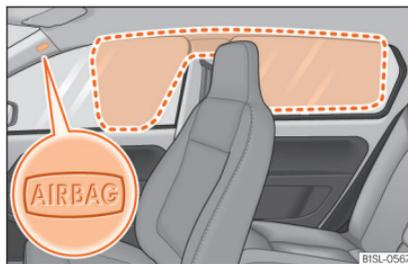
**Abb. 19** Einbauort und Entfaltungsbereich des Kopfairbags.
