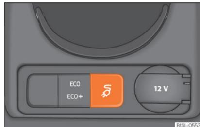
**Abb. 155** Im unteren Bereich der Mittelkonsole: Lademodusaste.
