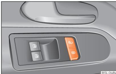
Abb. 69 An der Fahrertür: Zentralverriegelungstasten.
