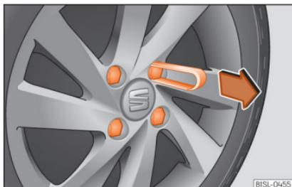
**Abb. 31** Rad: Radschrauben mit Deckel.
