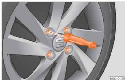
**Abb. 37** Radwechsel: Radschrauben mit dem Schraubendrehergriff lockern.
