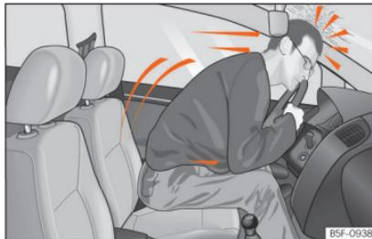
**Abb. 7** Der nicht angegurtete Fahrer schleudert nach vorn.
