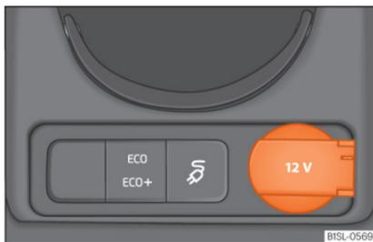
**Abb. 105** Mittelkonsole vorn: 12-Volt-Steckdose im Ablagefach und USB-Schnittstelle.
