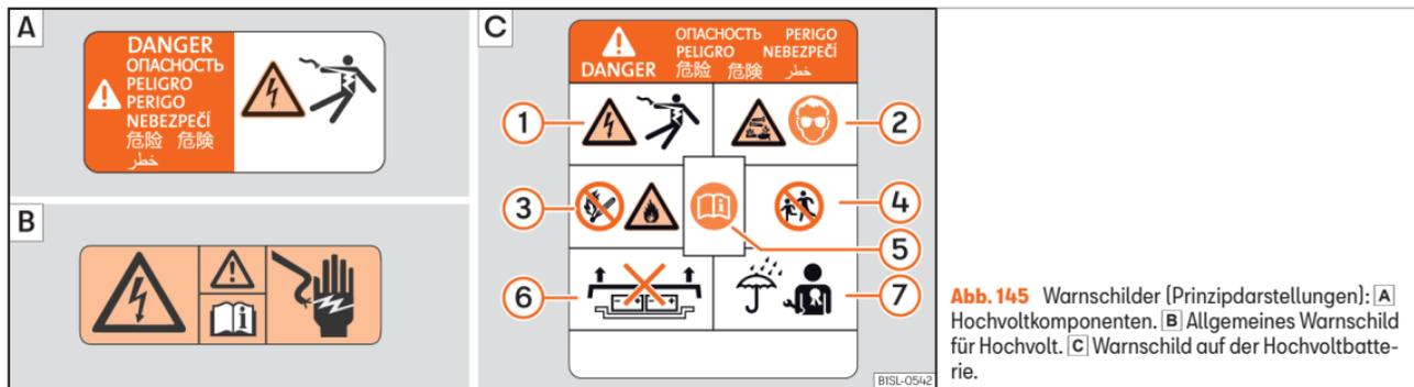
**Abb. 145** Warnschilder [Prinzipdarstellungen]: **A**) Hochvoltkomponenten. **B**) Allgemeines Warnschild für Hochvolt. **C**) Warnschild auf der Hochvoltbatterie.
