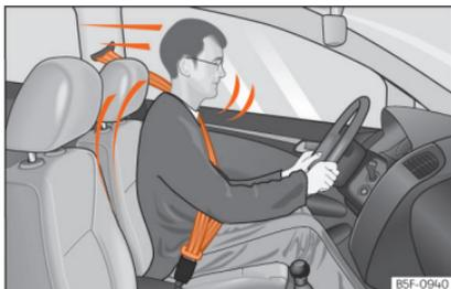
**Abb. 6** Richtig angeschnallte Fahrer werden bei einem plötzlichen Bremsmanöver nicht nach vorne geschleudert.
