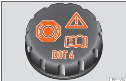
Abb. 165 Motorraum: Deckel des Bremsflüssigkeitsbehälters.
