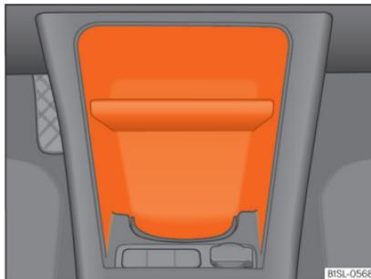
**Abb. 101** In der Mittelkonsole vorn: Ablagen.
