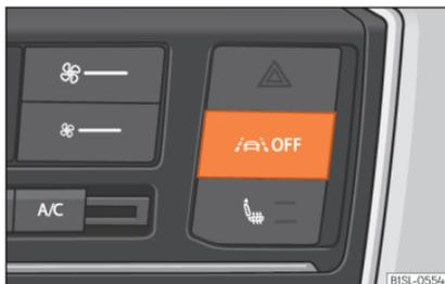
**Abb. 141** In der Mittelkonsole: Taste zum Einschalten des Spurhalteassistenten
