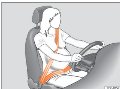
**Abb. 12** Gurtbandverlauf bei schwangeren Frauen.
