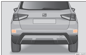
Abb. 241 Heckansicht des Fahrzeugs: Bereiche der Radarsensoren.
