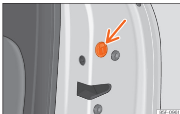
Abb. 98 Notfallsperre der Tür.
