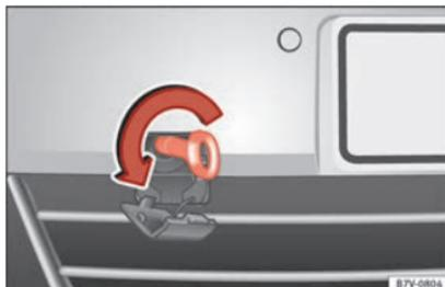
Abb. 73 Im Stoßfänger vorn rechts: Abschleppöse einschrauben.
