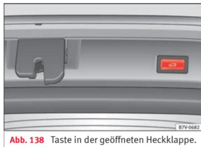
**Abb. 138** Taste in der geöffneten Heckklappe.
