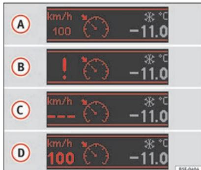
**Abb. 218** Display des Kombiinstruments: Zustandsanzeigen der GRA.
