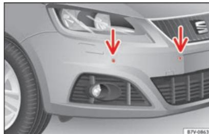
**Abb. 209** Sensoren der Parkdistanzkontrolle vorn im Stoßfänger.
