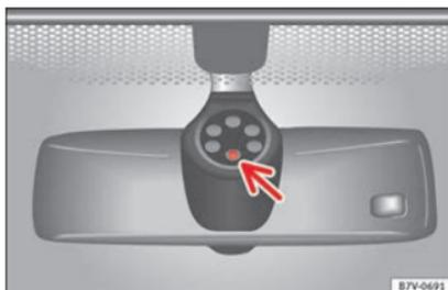
Abb. 145 Sensitive Fläche des Regensensors.
