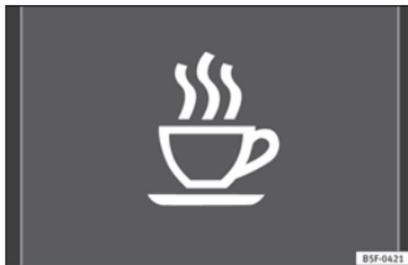
**Abb. 226** Im Display des Kombiinstrumentes: Symbol für Müdigkeitserkennung.
