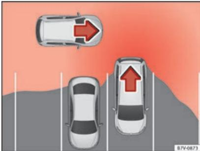
**Abb. 224** Schematische Abbildung des Ausparkassistenten: Überwachter Bereich des ausparkenden Fahrzeugs.
