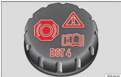
**Abb. 245** Im Motorraum: Deckel des Bremsflüssigkeitsbehälters
