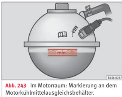
Abb. 243 Im Motorraum: Markierung an dem Motorkühlmittelausgleichbehälter.
