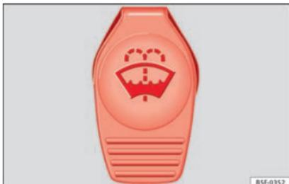
Abb. 246 Im Motorraum: Deckel des Scheibenwaschbehälters.
