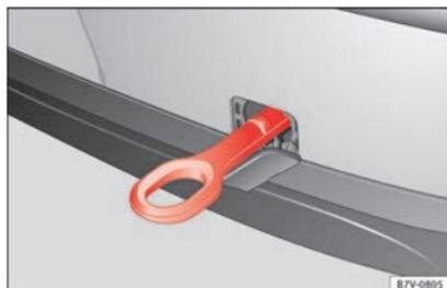
**Abb. 105** Im Stoßfänger hinten rechts: eingeschraubte Abschleppöse.
