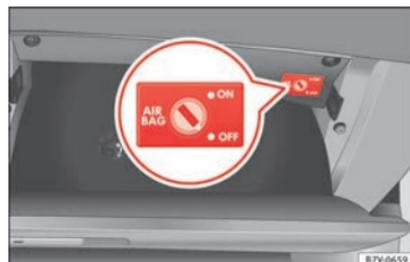
Abb. 93 Im Handschuhfach, auf der Beifahrerseite: Schlüsselschalter zum Ab- und Einschalten des Beifahrer-Frontalairbags.
