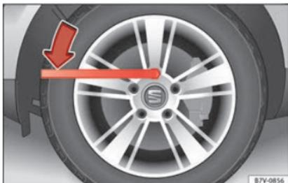
Abb. 68 Radwechsel: Radschrauben lockern.
