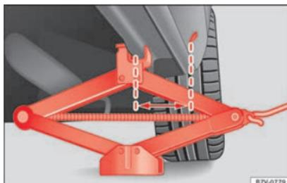
**Abb. 71** Wagenheber hinten an der linken Fahrzeugseite angesetzt.
