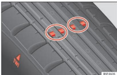
Abb. 251 Reifenprofil: Verschleißanzeiger.
