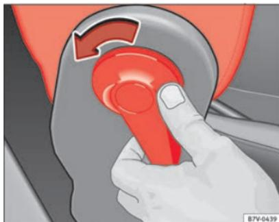
Abb. 160 Klappbare Beifahrersitzlehne ent-
