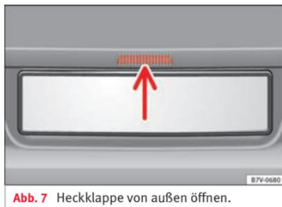
**Abb. 7** Heckklappe von außen öffnen.
