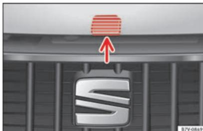
Abb. 238 Entriegelungshebel zum Öffnen der Motorraumklappe im Kühlergrill.
