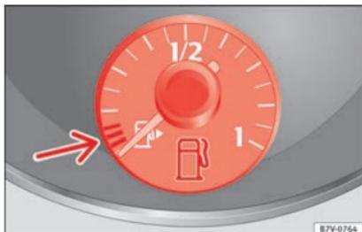
**Abb. 233** Im Kombiinstrument: Kraftstoffvorratsanzeige für Benzin und Diesel.
