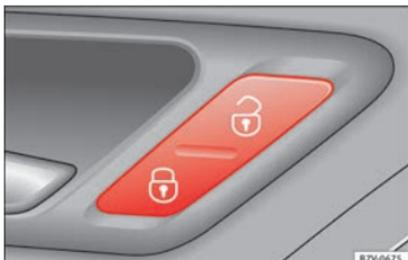
Abb. 130 An der Fahrertür: Zentralverriegelungstaster.
