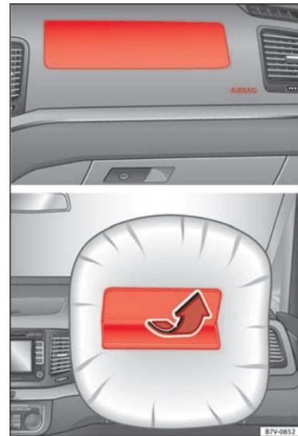
Abb. 27 Einbauort und Wirkungsbereich des Beifahrer-Frontairbags.
