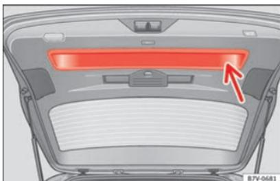
**Abb. 137** Offene Heckklappe: Griffmulde zum Zuziehen
