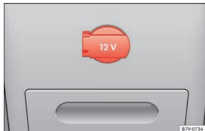
Abb. 193 Hintere Seite der Mittelkonsole: 12-Volt-Steckdose.
