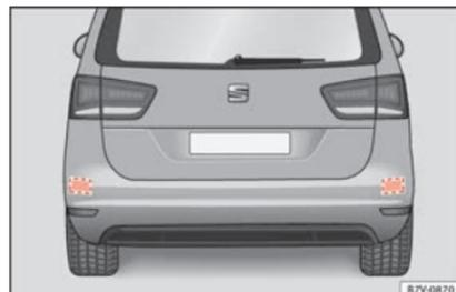
Abb. 221 Bereich hinter dem Fahrzeug: Bereiche der Radarsensoren.
