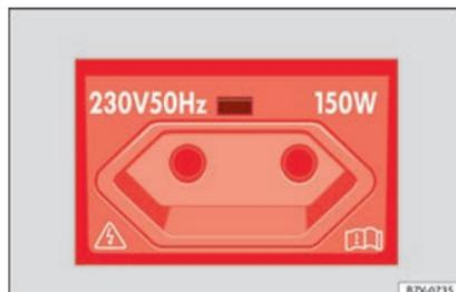
Abb. 194 Ausschnitt aus der hinteren Mittelkonsole: 230 Volt Eurosteckdose.
