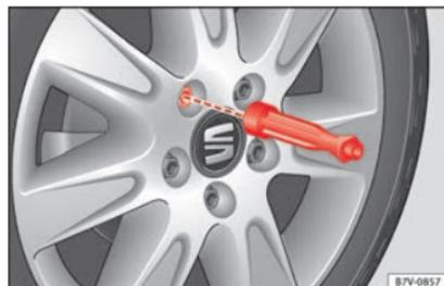
**Abb. 72** Radwechsel: Radschrauben mit dem Schraubendrehergriff abschrauben.
