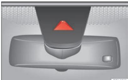
**Abb. 219** An der Frontscheibe: Kamerasichtfenster des Spurhalteassistenten.
