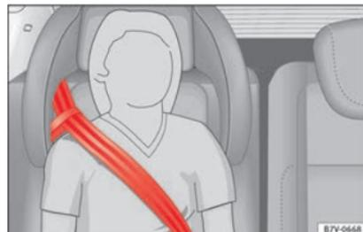
**Abb. 97** Integrierter Kindersitz: Gurtbandverlauf mit Gurtführungsschleufe.
