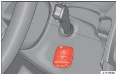
**Abb. 200** Notstart bei Fahrzeugen mit KESSY.
