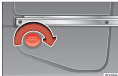
**Abb. 235** Hinten links im Gepäckraum: AdBlue-Tank, hinter einer Abdeckung.
