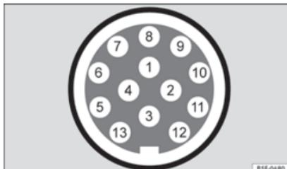
**Abb. 229** Schematische Darstellung: Zuweisung der Steckverbinderstifte für Anhängerstrom.
