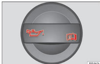
Abb. 241 Im Motorraum: Deckel der Motoröl-Einfüllöffnung.
