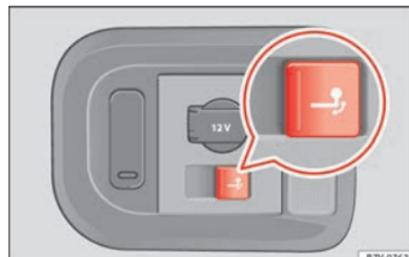
**Abb. 228** Gepäckraum rechts: Taste zum elektrischen Schwenken des Kugelkopfs.
