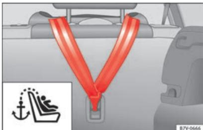
Abb. 39 Eingehängter oberer Befestigungsgurt im Gepäckraum.
