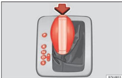
Abb. 202 Wählhebel des automatischen Getriebes mit Sperrtaste (Pfeil).
