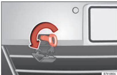
**Abb. 104** Im Stoßfänger vorn rechts: Abschleppöse einschrauben.
