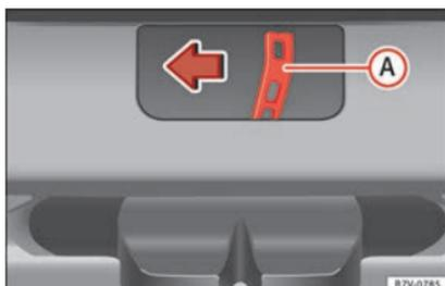
Abb. 9 Vom Gepäckraum aus: Heckklappe notentriegeln.
