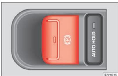
**Abb. 201** Detail der Mittelkonsole: Schalter für elektronische Parkbremse.
