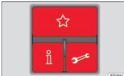
**Abb. 123** Drei-Tasten-Modul im Himmel: Bedienelemente des Telefonsteuerungssystems.
