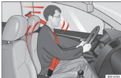
**Abb. 85** Angegurteter Fahrer, der bei einem plötzlichen Bremsmanöver vom richtig angelegten Sicherheitsgurt aufgefangen wird.
