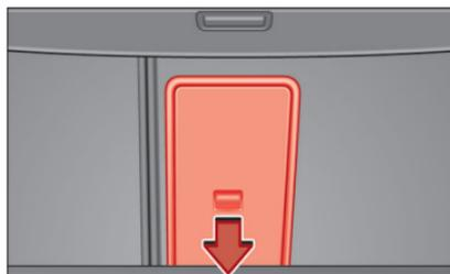
**Abb. 150** Im Gepäckraum: Öffnung der Durchladeeinrichtung.
