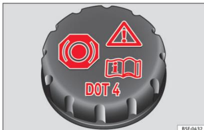
**Abb. 61** Motorraum: Deckel des Bremsflüssigkeitsbehälters
