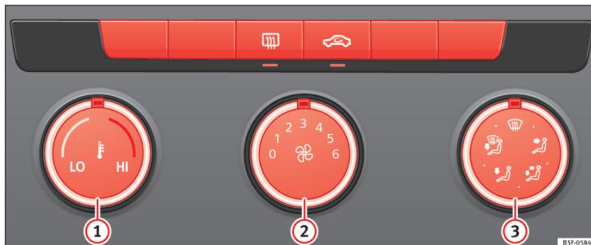
**Abb. 56** Mittelkonsole: Systembedienungen für Heiz- und Frischluft
