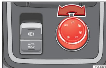
**Abb. 190** Mittelkonsole: Drehknopf (Driving Experience button).
