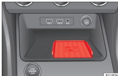
**Abb. 119** Mittelkonsole: Connectivity Box
