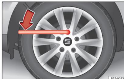
**Abb. 70** Rad: Radschrauben lockern.
