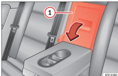
**Abb. 149** An der Rücksitzlehne: Öffnung der Durchladeeinrichtung.
