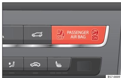
**Abb. 50** Kontrolllampchen für Abschaltung des und Beifahrerairbags.
