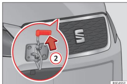
**Abb. 10** Hebel unter der Motorraumklappe. » »
