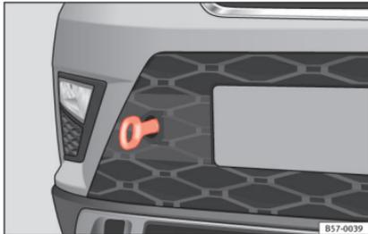
**Abb. 73** Vorderer Stoßfänger rechts: Eingeschraubte Abschleppöse
