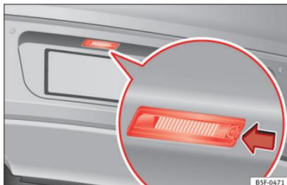
**Abb. 111** Im Stoßfänger hinten: Kennzeichenbeleuchtung.
