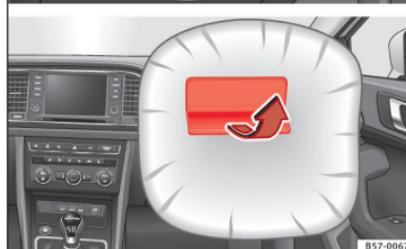
**Abb. 20** Beifahrerairbag in der Instrumententafel
