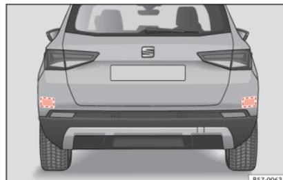
**Abb. 186** Bereich hinter dem Fahrzeug: Bereiche der Radarsensoren.
