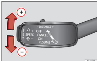
**Abb. 172** Auf der linken Seite der Lenksäule: dritter Hebel für die Betätigung der automatischen Distanzregelung.
