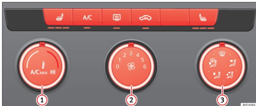
**Abb. 55** In der Mittelkonsole: Bedienelemente der manuellen Klimaanlage.
