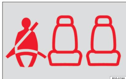
**Abb. 85** Kombiinstrument: Anzeige, dass der Platz hinten rechts besetzt und der entsprechende Sicherheitsgurt angelegt ist.
