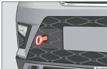
**Abb. 96** Auf der rechten Seite des vorderen Stoßfängers: Eingeschraubte Abschleppöse.
