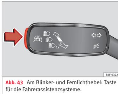
Abb. 43 Am Blinker- und Fernlichthebel: Taste für die Fahrerassistenzsysteme.
