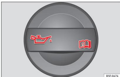
Abb. 205 Deckel der Motoröl-Einfüllöffnung im Motorraum
