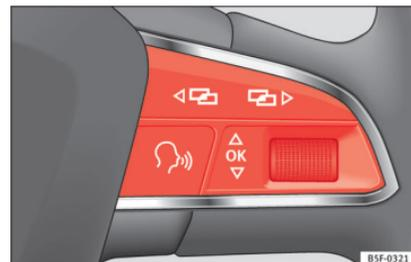
Abb. 42 Rechte Seite Multifunktions-Lenkrad: Steuertasten.
