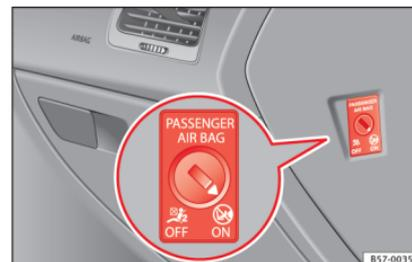
**Abb. 21** Schalter für Beifahrer-Frontairbag.
