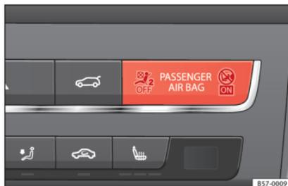
**Abb. 91** Kontrollleuchte in der Instrumententafel für abgeschalteten Beifahrer-Frontairbag.
