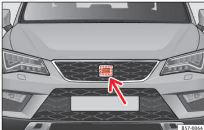
**Abb. 170** Im Frontbereich hinter dem SEAT-Emblem: Radarsensor.
