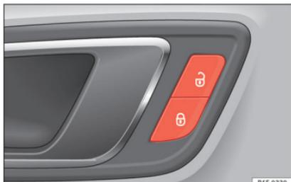
Abb. 2 Fahrertür: Taste Zentralverriegelung.
