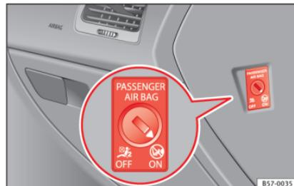
**Abb. 92** Schalter für Beifahrer-Frontairbag.
