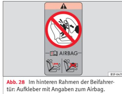
Auf der Sonnenblende und/oder dem hinteren Türrahmen der Beifahrerseite ist ein Aufkleber mit wichtiger Information zum Beifahrer-Airbag angebracht.
