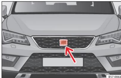
**Abb. 178** Im Frontbereich hinter dem SEAT-Emblem: Radarsensor.
