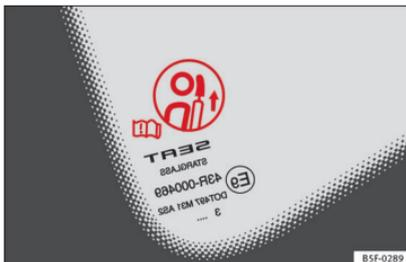
Abb. 84 Warnschild für Kopfstützenstellung
