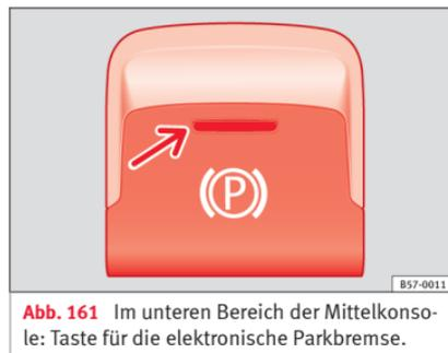
**Abb. 161** Im unteren Bereich der Mittelkonsole: Taste für die elektronische Parkbremse.
