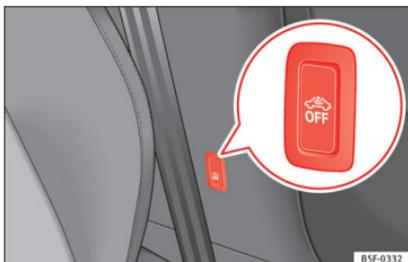
**Abb. 127** Taste für Innenraum-/Abschleppschutzüberwachung
