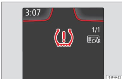
**Abb. 209** Kombiinstrument: Warnung Reifendruckverlust.
