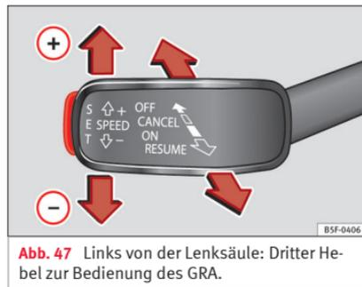
**Abb. 47** Links von der Lenksäule: Dritter Hebel zur Bedienung des GRA.
