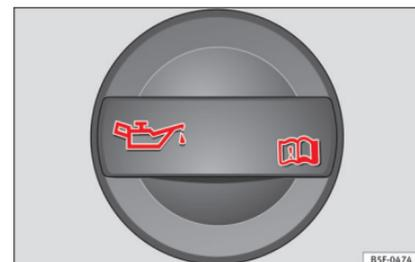
**Abb. 59** Deckel der Motoröl-Einfüllöffnung im Motorraum
