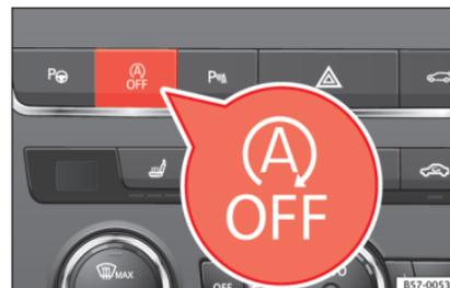
Abb. 165 Mittelkonsole: Systemtaste Start-Stopp.
