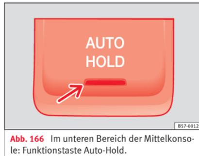
**Abb. 166** Im unteren Bereich der Mittelkonsole: Funktionstaste Auto-Hold.
