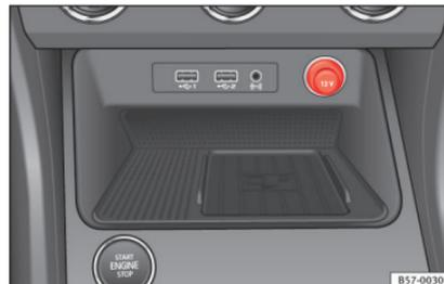
Abb. 145 In der Mittelkonsole hinten: 12-Volt-Steckdose.
