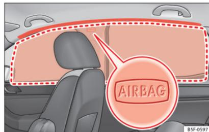
Abb. 26 Einbauort der Kopfairbags
