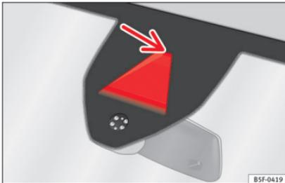
Abb. 184 Kameravisualisierung des Spurhalteassistenten.
