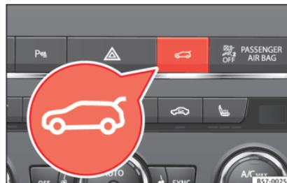
**Abb. 129** Mittelkonsole: Taste zum Öffnen und Schließen der Gepäckraumklappe.
