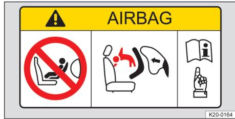
Abb. 1 Airbag-Aufkleber an der Sonnenblende (Prinzipdarstellung).
