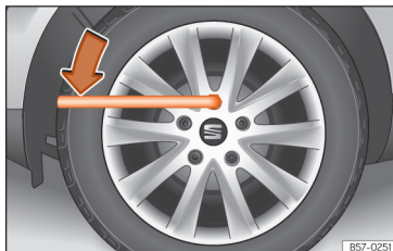
Abb. 38 Radwechsel: Radschrauben lockern.
