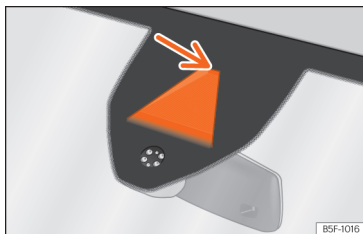
Abb. 281 An der Windschutzscheibe: Kamerasichtfenster des Spurhalteassistenten.
