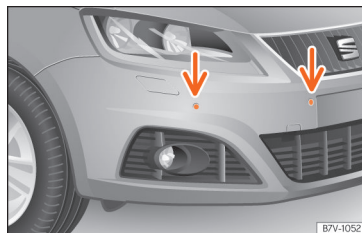
Abb. 272 Sensoren der Parkdistanzkontrolle vorn im Stoßfänger.
