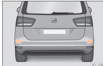
Abb. 261 Heckansicht des Fahrzeugs: Bereiche der Radarsensoren.
