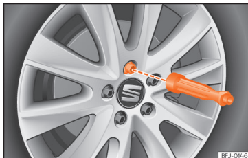
Abb. 49 Radwechsel: Radschrauben mit dem Schraubendrehergriff herausdrehen.
