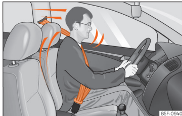
Abb. 7 Richtig angegurte Fahrer werden bei einem plötzlichen Bremsmanöver nicht nach vorne geschleudert.
