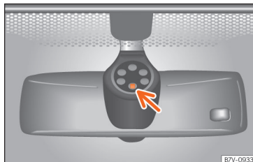
Abb. 122 Sensitive Fläche des Regensensors.
