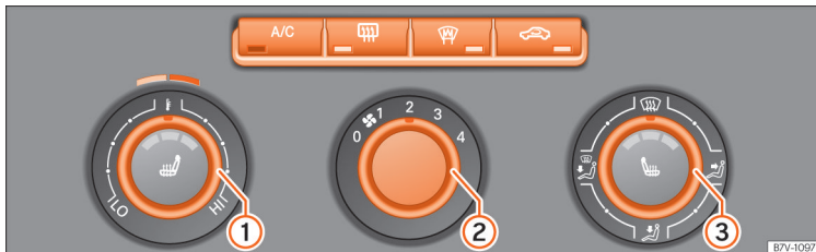
Abb. 174 In der Mittelkonsole: Bedienelemente für die Klimaanlage.
