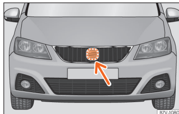
Abb. 247 Im Frontbereich hinter dem SEAT-Emblem: Radarsensor.
