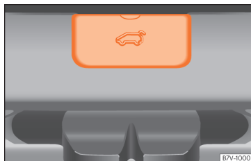
Abb. 107 Detail Gepäckraum: Zugang zur Notentriegelung.
