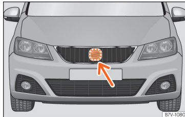
Abb. 251 Im Frontbereich hinter dem SEAT-Emblem: Radarsensor.
