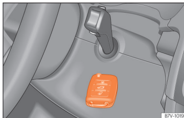
Abb. 235 Notstart bei Fahrzeugen mit Keyless Access.
