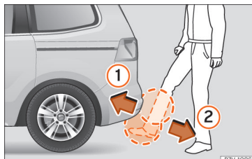
Abb. 106 Heckklappe mit sensorgesteuerter Öffnung (Easy Open).
