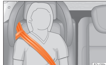
Abb. 35 Integrierter Kindersitz: Gurtbandverlauf mit Gurtführungsschleufe.
