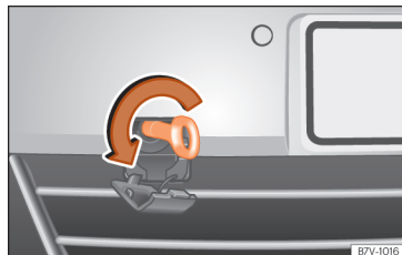
Abb. 56 Im Stoßfänger vorn rechts: Abschleppöse einschrauben.
