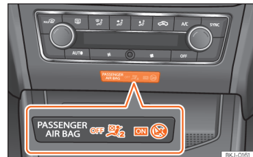
Abb. 97 Instrumententafel-Mittelteil: Kontrollleuchte für abgeschalteten Beifahrer-Frontairbag.
