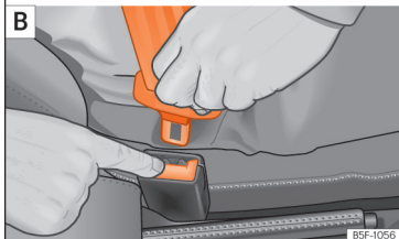
Abb. 94 Schlosszunge des Sicherheitsgurts in das Gurtschloss einstecken und vom Gurtschloss lösen.
