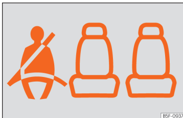
Abb. 90 Kombi-Instrument: Anzeige, dass der Platz hinten rechts besetzt und der entsprechende Sicherheitsgurt angelegt ist.
