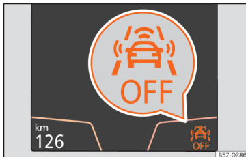
Abb. 233 Auf dem Bildschirm des Kombi-Instruments: Anzeige, dass Front Assist ausgeschaltet ist.
