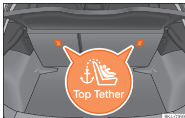
Abb. 39 Lage der Top Tether-Ösen im hinteren Teil des Rücksitzes
