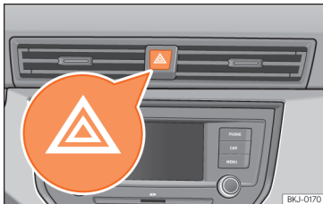
Abb. 44 Instrumententafel: Schalter für die Warnblinkanlage
