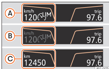
Abb. 228 Am Bildschirm des Kombi-Instruments: Anzeige des Zustands des Geschwindigkeitsbegrenzers.
