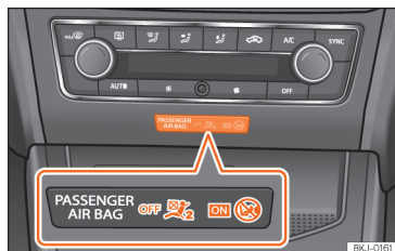
Abb. 26 Instrumententafel-Mittelteil: Kontrollleuchte für abgeschalteten Beifahrer-Frontairbag.
