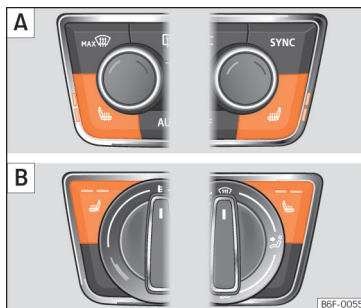
Abb. 151 In der Mittelkonsole: Regler für die Sitzheizung der Vordersitze. A : Ausführung mit Climatronic. B : Ausführung mit manueller Klimaanlage.
