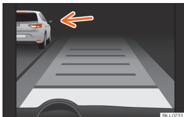
Abb. 240 Am Bildschirm des Kombi-Instruments: ACC aktiv, Fahrzeug auf der linken Seite erkannt
