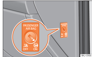
Abb. 96 Schlüsselschalter zum Ein- und Abschalten des Beifahrerairbags.
