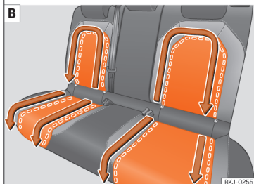
Abb. 153 Abnehmbare Schonbezüge ausbauen. A Sitz vorn links; B Sitze hinten
