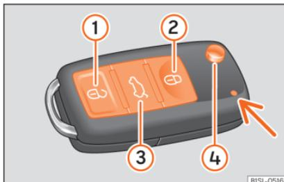
Abb. 63 Tasten im Funkschlüssel.
