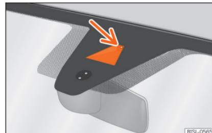
**Abb. 141** Kamerasichtfenster des Spurhalteassistenten.
