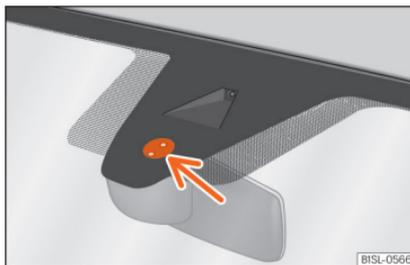
**Abb. 86** Sensitive Fläche des Regensensors.
