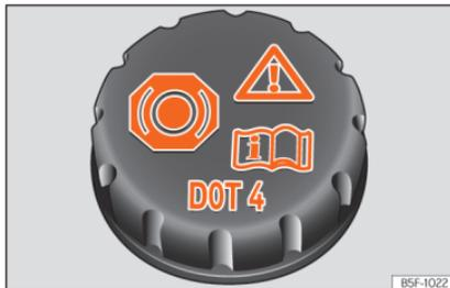
Abb. 163 Motorraum: Deckel des Bremsflüssigkeitsbehälters
