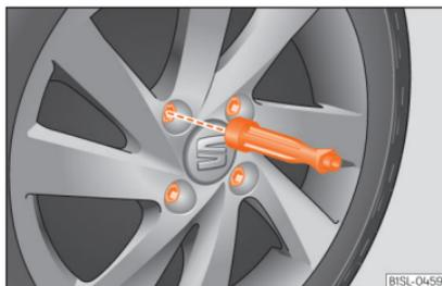
**Abb. 37** Radwechsel: Radschrauben mit dem Schraubendrehergriff abschrauben.
