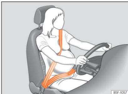
**Abb. 12** Gurtbandverlauf bei schwangeren Frauen.
