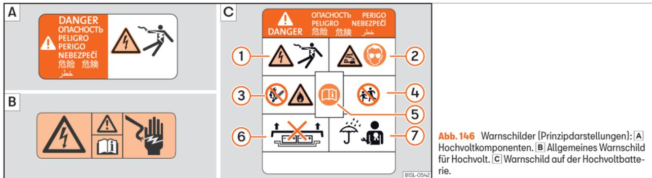
**Abb. 146** Warnschilder [Prinzipdarstellungen]: **A**) Hochvoltkomponenten. **B**) Allgemeines Warnschild für Hochvolt. **C**) Warnschild auf der Hochvoltbatterie.
