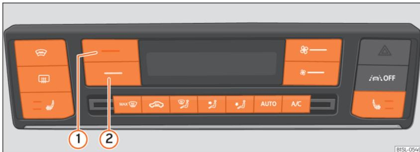
Abb. 109 In der Mittelkonsole: Bedienelemente der Climatronic.
