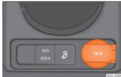
**Abb. 106** Mittelkonsole vorn: 12-Volt-Steckdose im Ablagefach und USB-Schnittstelle.
