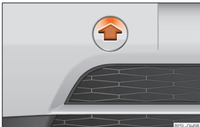
**Abb. 42** Vorderer Stoßfänger, rechte Seite: Abdeckung abziehen.
