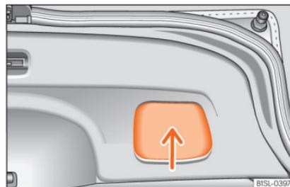
**Abb. 74** Offene Heckklappe: Griffmulde zum Zuziehen
