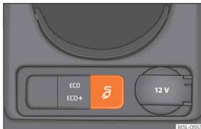
**Abb. 154** Im unteren Bereich der Mittelkonsole: Lademodustaste.
