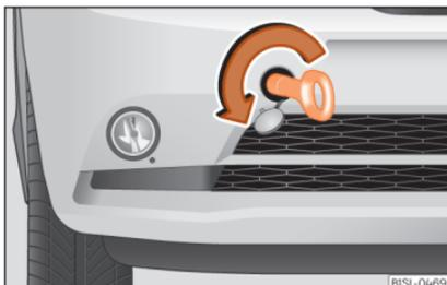
**Abb. 43** Vorderer Stoßfänger rechts: Eingeschraubte Abschleppöse
