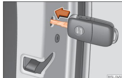
**Abb. 71** Notverriegelung des Fahrzeugs mit dem Fahrzeugschlüssel.
