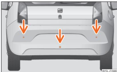
**Abb. 144** Sensoren der Parkdistanzkontrolle im hinteren Stoßfänger.
