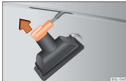
**Abb. 55** Kennzeichenleuchte: Lampenträger ausbauen.
