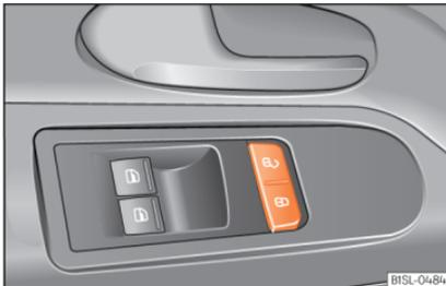
**Abb. 69** In der Fahrertür: Zentralverriegelungstasten.
