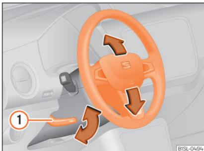
**Abb. 4** Hebel auf der linken unteren Seite der Lenksäule.
