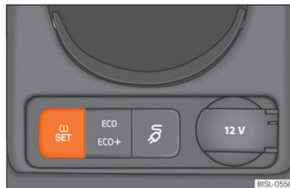
Abb. 169 Mittelkonsole: Taste für die Reifenkontrollanzeige
