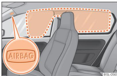
Abb. 19 Einbauort und Entfaltungsbereich des Kopfairbags.
