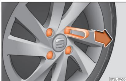
**Abb. 31** Rad: Radschrauben mit Deckel.
