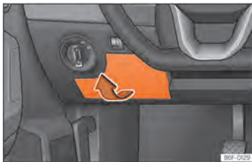
Abb. 159 Auf der Fahrerseite in der Instrumententafel: Abdeckung des Sicherungskastens.
