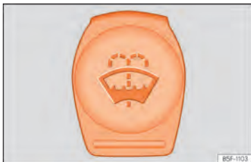
Abb. 174 Im Motorraum: Blauer Deckel des Scheibenwaschbehälters.
