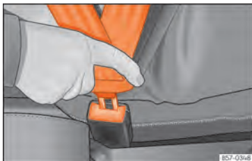
Abb. 21 Schlosszunge des Sicherheitsgurts in das Gurtschloss einstecken.
