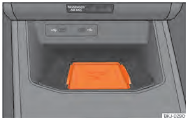
Abb. 135 In der Mittelkonsole: Aufnahme für die Mobiltelefonkopplung.
