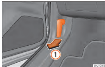
Abb. 169 Entriegelungshebel im Fahrerfußraum.
