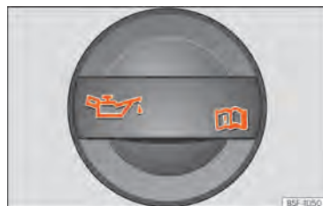
Abb. 178 Deckel der Motoröl-Einfüllöffnung im Motorraum.
