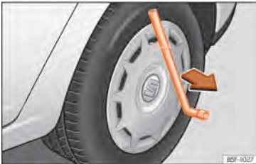
Abb. 185 Die Radvollblende vom Rad abnehmen.
