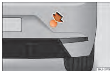
Abb. 157 Auf der rechten Seite des hinteren Stoßfängers: Abdeckung entfernen.
