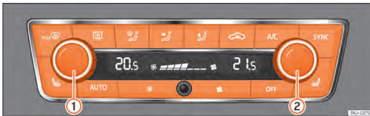
Abb. 80 In der Mittelkonsole: Bedienelemente der Climatronic.
