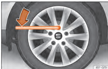
Abb. 188 Radwechsel: Radschrauben lockern.
