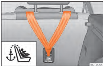
Abb. 37 Rückseite der Rücksitzbank: Halteösen für den Top Tether Haltegurt.
