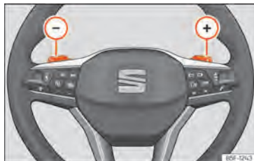
Abb. 89 Lenkrad: die Hebel für Automatikgetriebe.
