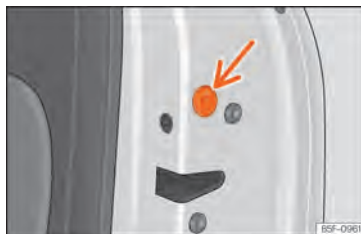
Abb. 53 Notfallsperre der Tür.
