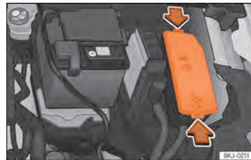
Abb. 160 Im Motorraum: Abdeckung des Sicherungskastens.
