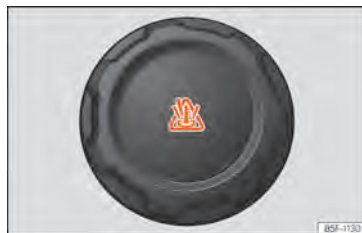
Abb. 172 Frontraum: Verschlussdeckel des Kühlmittelausgleichsbehälters.
