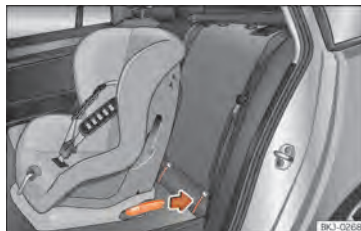
Abb. 36 Rücksitz: Einbau des Kindersitzes mit dem ISOFIX-System.
