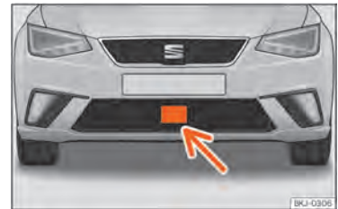
Abb. 94 Im vorderen Stoßfänger: Radarsensor.
