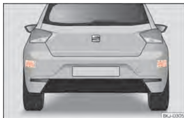
Abb. 97 Bereich hinter dem Fahrzeug: Bereiche der Radarsensoren.
