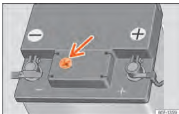
Abb. 179 Sichtfenster an der Oberseite der 12-Volt-Fahrzeugbatterie (Prinzipsdarstellung).
