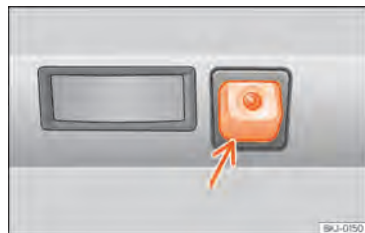
Abb. 99 Im Stoßfänger hinten: Einbauort der Kamera des Rückfahrassistenten.
