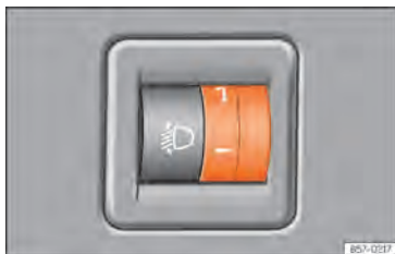
Abb. 72 Neben dem Lenkrad: Regler für die Leuchtweitenregulierung.
