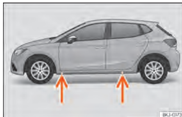
Abb. 190 Aufnahmepunkte für den Wagenheber.
