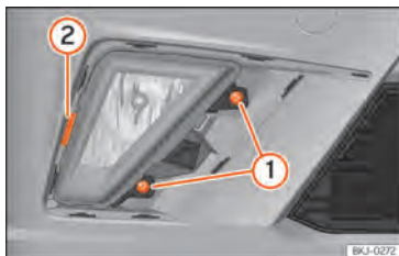
Abb. 165 Nebelscheinwerfer: Lampenträger ausbauen
