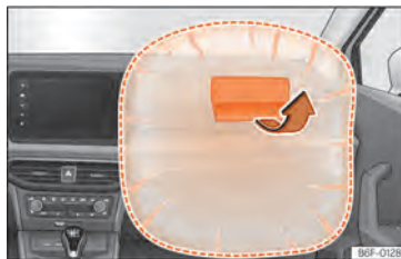
Abb. 26 Beifahrerairbag in der Instrumententafel
