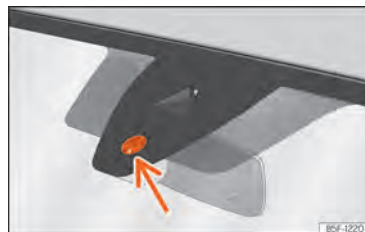
Abb. 76 Sensitive Fläche des Regensensors.
