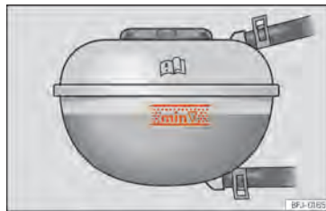
Abb. 171 Im Frontraum: Markierung am Kühlmittelausgleichsbehälter.
