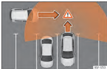
Abb. 124 Schematische Abbildung des Ausparkassistenten: Überwachter Bereich des ausparkenden Fahrzeugs.
