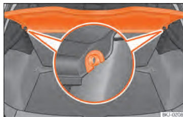
Abb. 137 Im Gepäckraum: Gepäckraumabdeckung aus- und einbauen.
