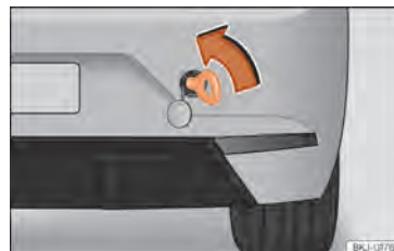
Abb. 158 Auf der rechten Seite des hinteren Stoßfängers: Eingeschraubte Abschleppöse.
