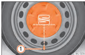
Abb. 184 Korrekte Anbringung der Radvollblende für Stahlfelgen.
