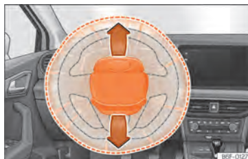
Abb. 25 Einbauort Fahrerairbag: im Lenkrad.
