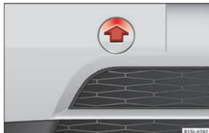
**Abb. 80** Im Stoßfänger vorn rechts: Abdeckung abnehmen.
