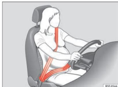
Abb. 73 Gurtbandverlauf bei schwangeren Frauen.
