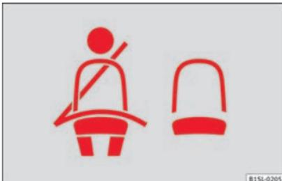
Abb. 68 Gurtstatusanzeige für die hinteren Sitzplätze im Display des Kombiinstrumentes.
