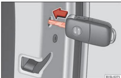
**Abb. 5** Notverriegelung des Fahrzeugs mit dem Fahrzeugschlüssel.
