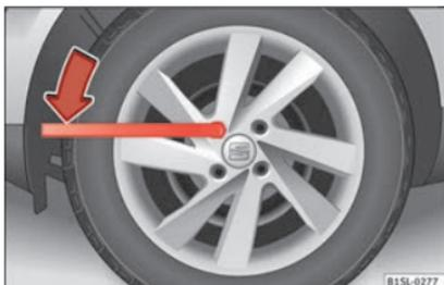
**Abb. 53** Radwechsel: Radschrauben lockern.
