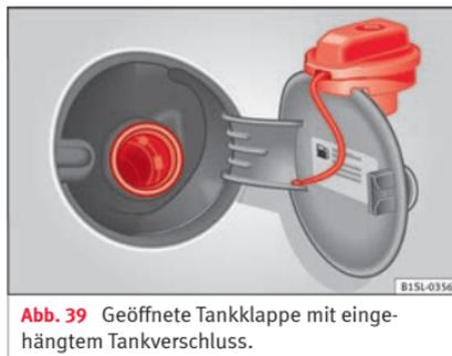
**Abb. 39** Geöffnete Tankklappe mit eingehängtem Tankverschluss.
