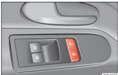
Abb. 2 An der Fahrertür: Zentralverriegelungstaster.
