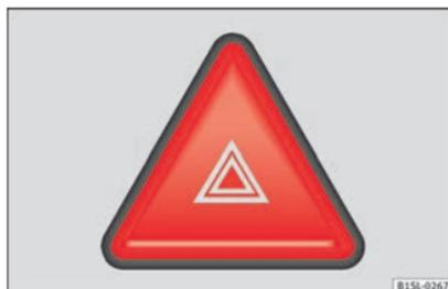
Abb. 31 Instrumententafel: Schalter für die Warnblinkanlage
