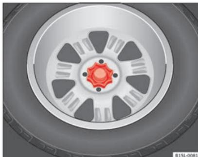
**Abb. 177** Im Gepäckraum: Handrad zur Befestigung des Reserverads.
