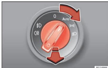
Abb. 29 Instrumententafel: Bedienelement Licht
