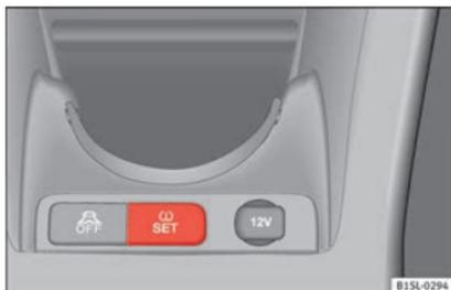
**Abb. 176** Mittelkonsole: Taste für die Reifenkontrollanzeige
