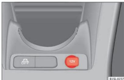
**Abb. 133** Mittelkonsole vorn: 12-Volt-Steckdose im Ablagefach.
