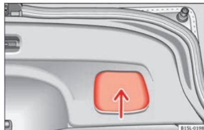
**Abb. 6** Offene Heckklappe: Griffmulde zum Zuziehen
