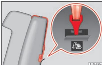
Abb. 27 Beispiel eines eingehängten oberen Befestigungsgurts.
