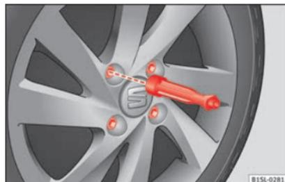
**Abb. 57** Radwechsel: Radschrauben mit dem Schraubendrehergriff abschrauben.
