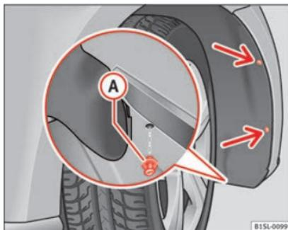
**Abb. 86** Im Radhaus vorn rechts: Befestigungsschrauben (Pfeile) herausdrehen und Spreizniete **A** entfernen.
