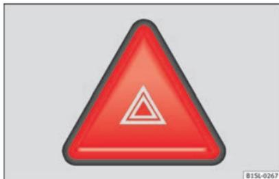
**Abb. 110** Instrumententafel: Taste zum Ein- und Ausschalten der Warnblinkanlage.
