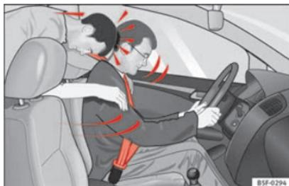
**Abb. 71** Der nicht angegurte Mitfahrer auf dem Rücksitz schleudert nach vorn auf den angegurten Fahrer.
