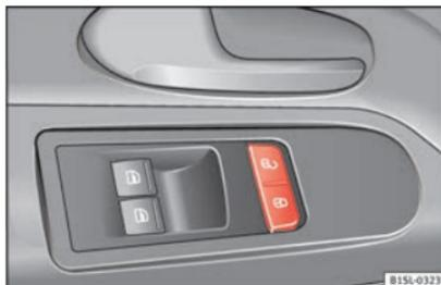
**Abb. 103** An der Fahrertür: Zentralverriegelungstaster.
