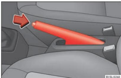
Abb. 146 Zwischen den Vordersitzen: Handbremse.
