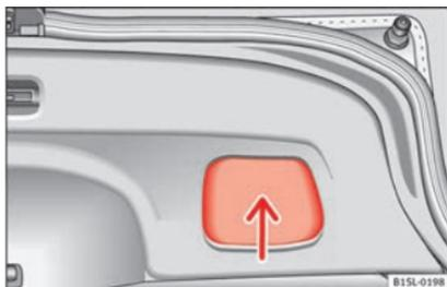
**Abb. 107** Offene Heckklappe: Griffmulde zum Zuziehen
