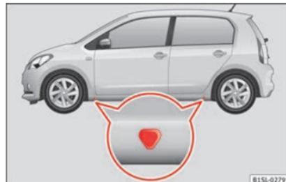
**Abb. 55** Aufnahmepunkte für den Wagenheber.
