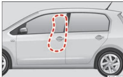
**Abb. 22** Auf der linken Fahrzeugseite: Entfaltungsbereich des Seitenairbags.
