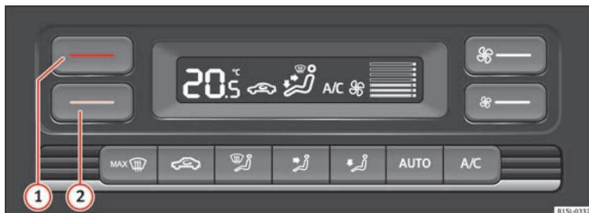
Abb. 37 Im oberen Teil der Mittelkonsole: Bedienelemente der Climatronic.
