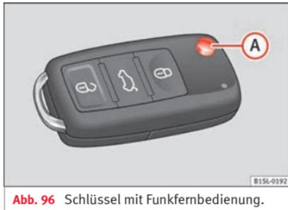
Abb. 96 Schlüssel mit Funkfernbedienung.
