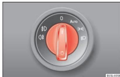
**Abb. 109** Neben dem Lenkrad: Darstellung einiger Varianten des Lichtschalters.
