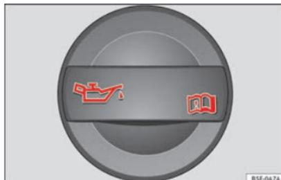
Abb. 169 Im Motorraum: Deckel der Motoröleinfüllöffnung.
