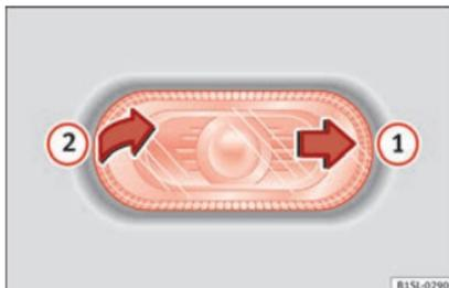
Abb. 92 Seitliche Blinkleuchte ausbauen.
