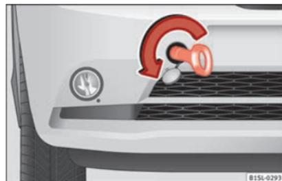
Abb. 58 Vorderer Stoßfänger rechts: Eingeschraubte Abschleppöse
