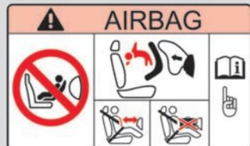
**Abb. 23** Sonnenblende auf der Beifahrerseite: Airbagaufkleber.
