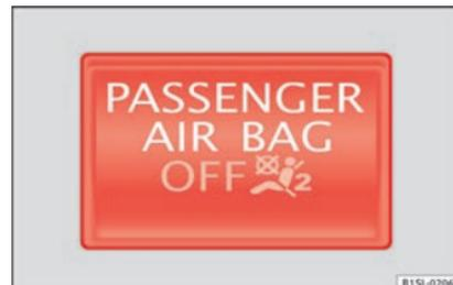
**Abb. 74** Kontrollleuchte in der Instrumententafel für abgeschalteten Beifahrer-Frontairbag.
