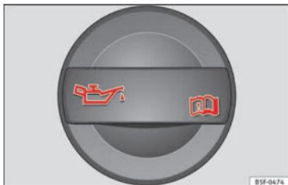
Abb. 41 Deckel der Motoröl-Einfüllöffnung im Motorraum
