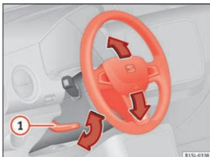
**Abb. 17** Lenkradposition mechanisch einstellen.
