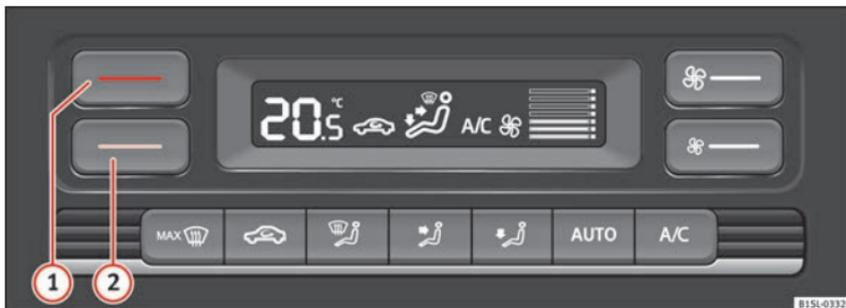
Abb. 144 Im oberen Teil der Mittelkonsole: Bedienelemente der Climatronic.
