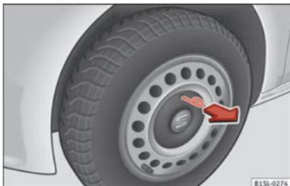
**Abb. 50** Radmittenblende an der Stahlfelge abziehen.
