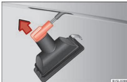
**Abb. 91** Kennzeichenleuchte: Lampenträger ausbauen.
