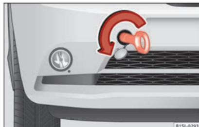
**Abb. 81** Im Stoßfänger vorn rechts: Abschleppöse einschrauben.
