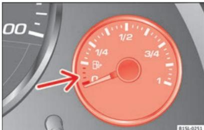
**Abb. 164** Im Kombiinstrument: Kraftstoffvorratsanzeige für Benzin.
