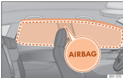
**Abb. 38** Einbauort und Entfaltungsbereich des Kopfairbags.
