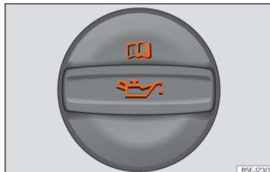
**Abb. 229** Deckel der Motoröl-Einfüllöffnung im Motorraum.
