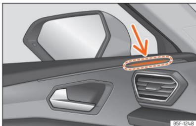
**Abb. 143** Kontrollleuchte des Spurwechselassistenten.
