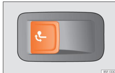
**Abb. 198** Auf der linken Seite im Gepäckraum: Taste zur Entriegelung der Anhängerkupplung.
