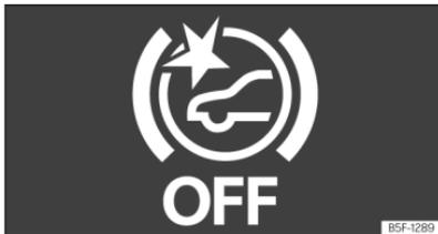
**Abb. 138** Auf dem Display des Kombi-Instruments: Anzeige, dass Front Assist ausgeschaltet ist.
