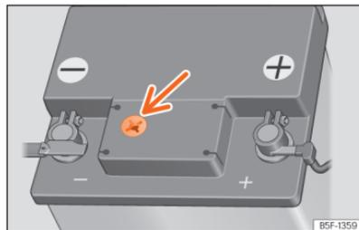
**Abb. 231** Sichtfenster an der Oberseite der 12-Volt-Fahrzeugaufbatterie (Prinzipdarstellung).
