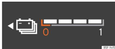
**Abb. 9** Digitales Kombi-Instrument: Anzeige des Batterieladezustands.
