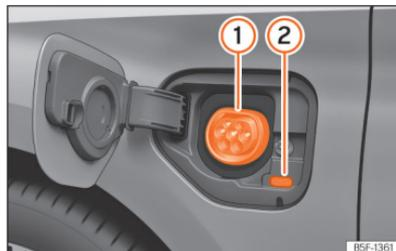
**Abb. 59** Hinter der Batterieklappe vorn links: Ladedose.
