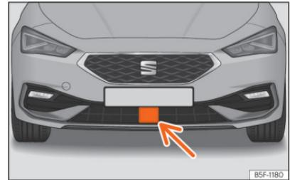
**Abb. 123** Im vorderen Stoßfänger: Radarsensor.
