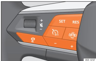
**Abb. 132** Am Multifunktionslenkrad: Tasten zur ACC-Bedienung.
