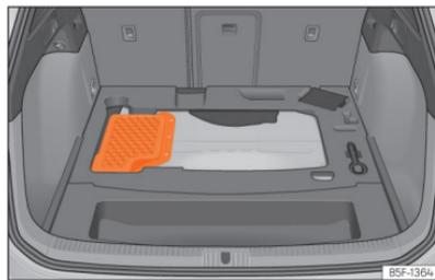
**Abb. 230** Plug-in-Hybridfahrzeuge (PHEV): Einbautort der Batterie im Kofferraum
