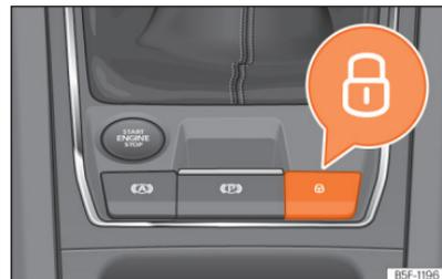
**Abb. 74** In der Mittelkonsole: Zentralverriegelungstaster
