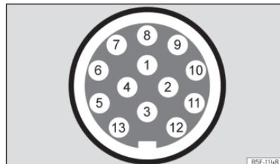
**Abb. 197** Schematische Darstellung: Zuweisung der Steckverbinderstifte für Anhängerstrom.
