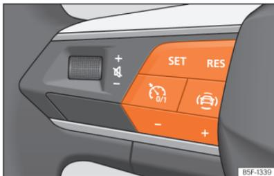
**Abb. 129** Am Multifunktionslenkrad: Tasten zur Bedienung der Geschwindigkeitsregelanlage.
