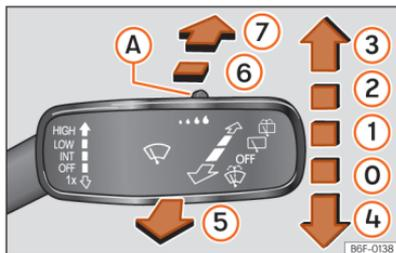
Abb. 105 Bedienung von Windschutz- und Heckscheibenwischer
