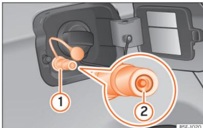
**Abb. 204** Geöffnete Tankklappe: Gas-Einfüllstutzen ①, Dichtungsring des Einfüllstutzens ②.
