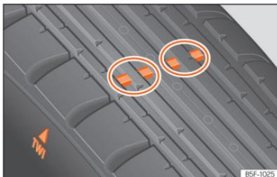
Abb. 234 Reifenprofil: Verschleißanzeiger.
