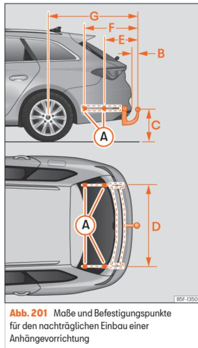
**Abb. 201** Maße und Befestigungspunkte für den nachträglichen Einbau einer Anhängervorrichtung
