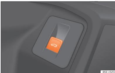
**Abb. 80** In der Fahrertür: Taste zum Öffnen und Schließen der Heckklappe.
