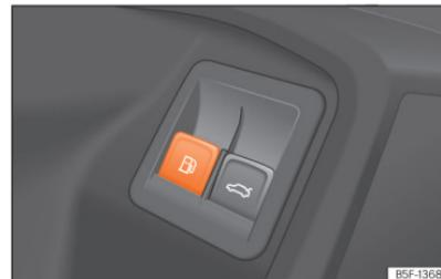
**Abb. 203** Fahrertür: Tankklappenentriegelung.
