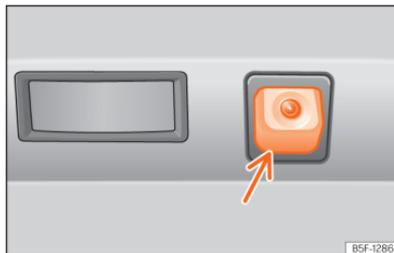
**Abb. 128** Im Stoßfänger hinten: Einbauport der Rückfahrkamera.
