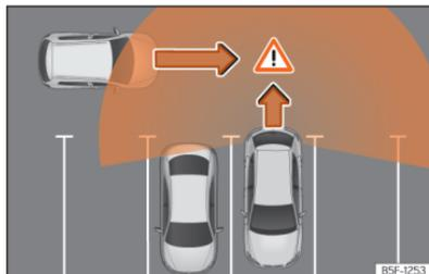
**Abb. 157** Schematische Abbildung des Ausparkassistenten: Überwacher Bereich des ausparkenden Fahrzeugs.
