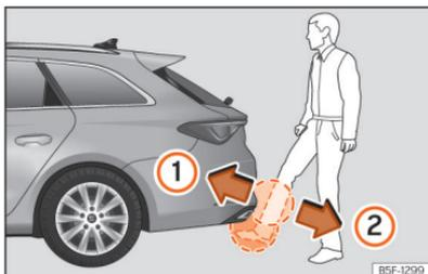
**Abb. 81** Heckklappe mit sensorgesteuerter Öffnung (Easy Open).
