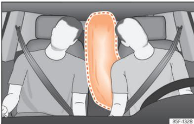
**Abb. 35** Vollständig entfalteter Center-Airbag (Entfaltungsbereich)
