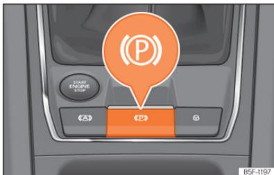
**Abb. 147** Im unteren Bereich der Mittelkonsole: Taste fr die elektronische Parkbremse.
