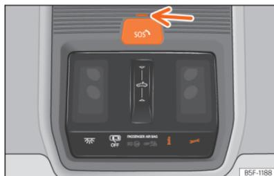
**Abb. 53** In der Dachkonsole: Schalter für Sprachdienste.
