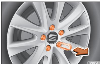
**Abb. 239** Rad: Radschrauben mit Deckel.
