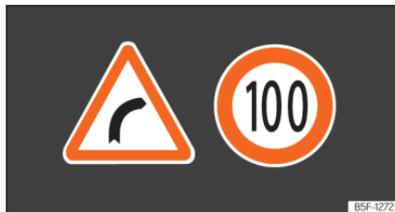
**Abb. 13** Im Display des Kombi-Instruments: Beispiel für erkannte Verkehrszeichen.
