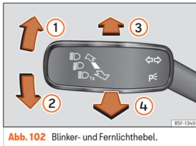
**Abb. 102** Blinker- und Fernlichthebel.
