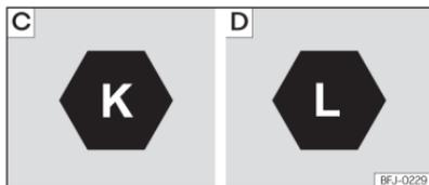
**Abb. 58** Kennzeichnung Gleichstrom (DC) und CCS-Fahrzeugstecker
