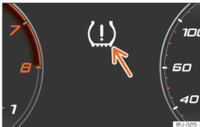
**Abb. 245** Kombi-Instrument: Warnung Reifendruckverlust.
