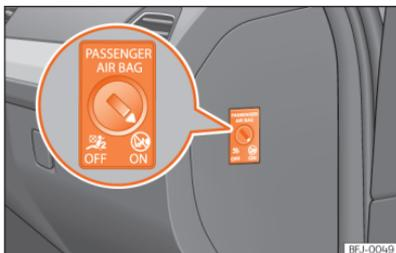
**Abb. 32** Schüsselschalter zum Ein- und Abschalten des Beifahrerairbags.
