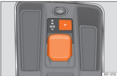
**Abb. 119** In der Mittelkonsole: Wahlschalter
