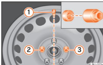
**Abb. 242** Radwechsel: Reifenventil ① und Einbauort der Anti-Diebstahl-Radschraube ② oder ③.
