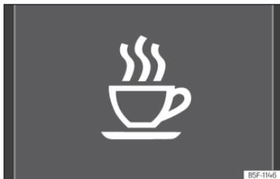
**Abb. 12** Im Display des Kombi-Instruments: Symbol der Müdigkeitserkennung.
