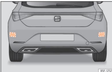
**Abb. 126** Bereich hinter dem Fahrzeug: Bereiche der Radarsensoren.
