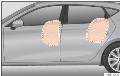
**Abb. 37** Komplettaufgeblasener Seitenairbag auf der linken Fahrzeugseite.
