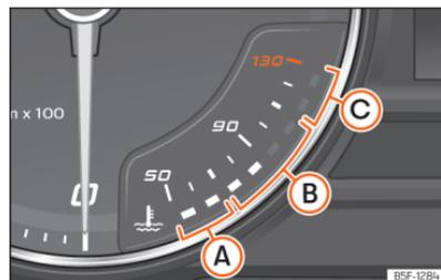
**Abb. 10** Analoges Kombi-Instrument: Motorkühlmitteltemperatur-Anzeige.
