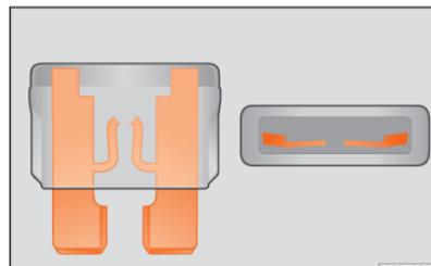
**Abb. 218** Darstellung einer durchgebrannten Sicherung.
