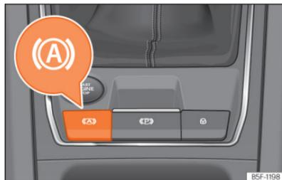
**Abb. 148** Im unteren Bereich der Mittelkonsole: Funktionstaste Auto Hold.
