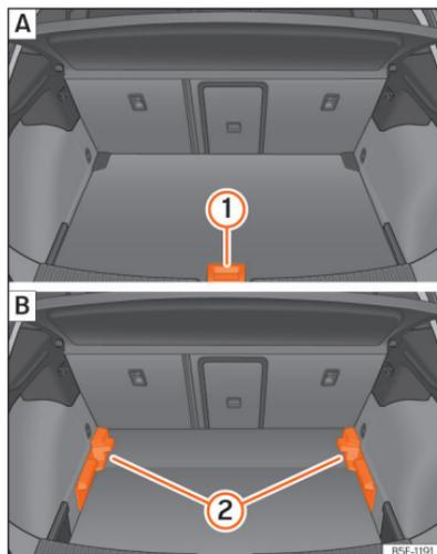
**Abb. 182** Variabler Gepäckraumboden: **A** Hochstellung; **B** Tiefstellung.
