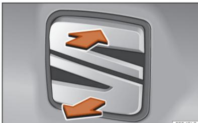
Abb. 78 Heckklappe: Öffnen von außen
