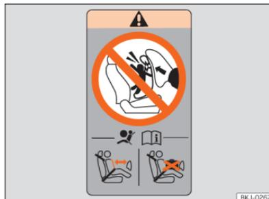
**Abb. 43** Airbag-Label: am hinteren Rahmen der Beifahrertür.
