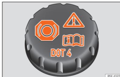
Abb. 224 Motorraum: Deckel des Bremsflüssigkeitsbehälters
