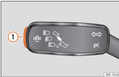
**Abb. 121** Am Blinker- und Fernlichthebel: Taste für die Fahrerassistenzsysteme (modellabhängig).
