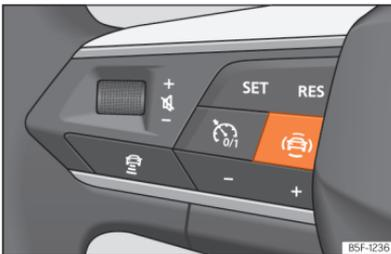
**Abb. 122** Linke Seite des Multifunktionslenkrads: Taste für die Fahrerassistenzsysteme (modellabhängig).
