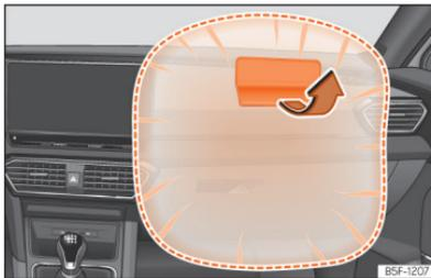
**Abb. 31** Beifahrerairbag in der Instrumententafel
