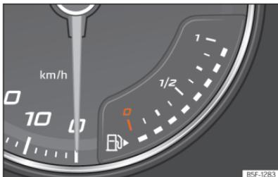
**Abb. 6** Analoges Kombi-Instrument: Kraftstoffvorratsanzeige.
