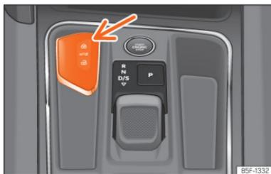
Abb. 67 Mittelkonsole: Aufnahme für den Fahrzeugschlüssel
