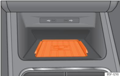
**Abb. 173** In der Mittelkonsole: Aufnahme für die Mobiltelefonkopplung.
