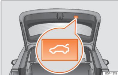
**Abb. 79** Heckklappe: Taste zum Schließen der Heckklappe.
