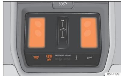
**Abb. 103** Ausschnitt aus Dachhimmel: Innenbeleuchtung vorn.
