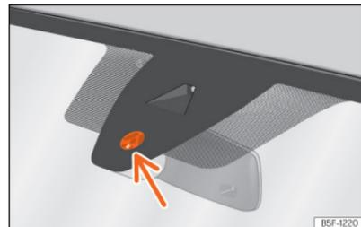
**Abb. 107** Sensitive Fläche des Regensensors.
