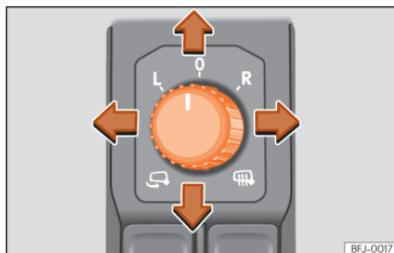
Abb. 109 Ausschnitt der Fahrertür: Außenspiegelbedienung.
