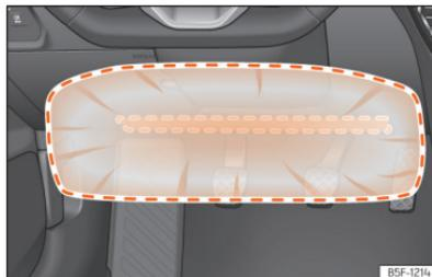
**Abb. 40** Auf der Fahrerseite: Wirkungsbereich des Knieairbags.
