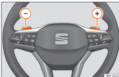
**Abb. 120** Lenkrad: die Hebel für Automatikgetriebe.
