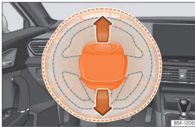
**Abb. 30** Einbauort Fahrerairbag: im Lenkrad.
