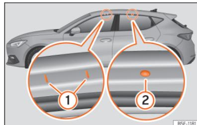
**Abb. 196** Befestigungspunkte der Längsträger für den Dachgepäckträger [Leon].
