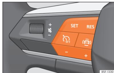
**Abb. 130** Am Multifunktionslenkrad: Tasten zur Bedienung des Geschwindigkeitsbegrenzers.
