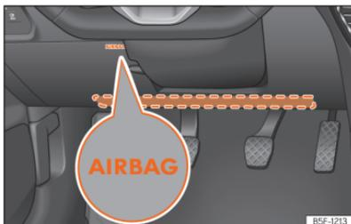
**Abb. 39** Auf der Fahrerseite: Einbauort des Knieairbags.
