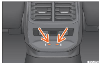
Abb. 166 Mittelkonsole hinten: USB-Anschlüsse mit Steckdosenfunktion.
