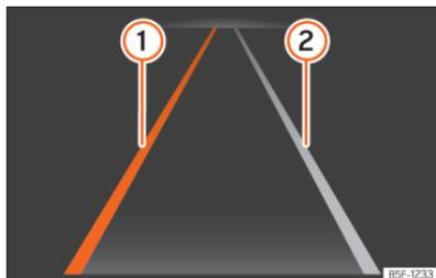
**Abb. 139** Im Display des Kombi-Instruments: Anzeigen des Spurhalteassistenten.
