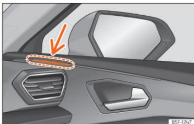
**Abb. 144** Kontrollleuchte des Spurwechselassistenten.
