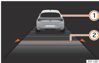
**Abb. 131** Am Bildschirm des Kombi-Instruments: ACC aktiv.
