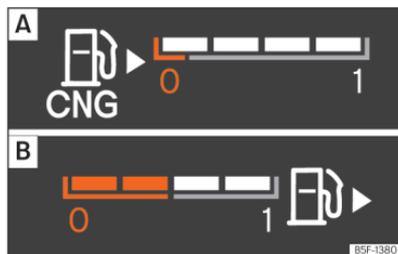
**Abb. 8** Digitales Kombi-Instrument: **A**: Erdgasvorratsanzeige. **B**: Benzinvorratsanzeige
