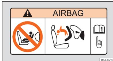
**Abb. 42** Airbag-Label: an der Sonnenblende Beifahrerseite.
