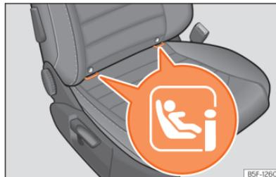
**Abb. 45** Beifahrersitz: Einbauort der Halteösen i-Size.
