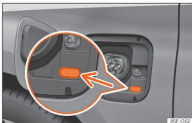
**Abb. 60** Hinter der Batterieladeklappe: Ladevorgangsanzeige.
