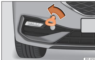
**Abb. 213** Vorderer Stoßfänger rechts: Eingeschraubte Abschleppöse
