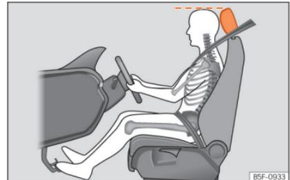
**Abb. 88** Die richtige Kopfstützeinstellung des Fahrers.
