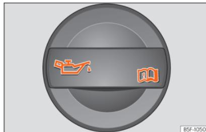
Abb. 311 Deckel der Motoröleinfüllöffnung im Motorraum
