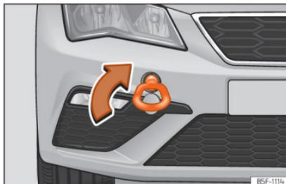
**Abb. 80** Vorderer Stoßfänger rechts: Eingeschraubte Abschleppöse
