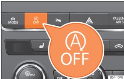
**Abb. 262** Mittelkonsole: Systemtaste Start-Stopp.
