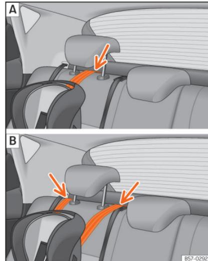
Abb. 40 Befestigungsgurt: korrekte Einstellung und korrekter Einbau
