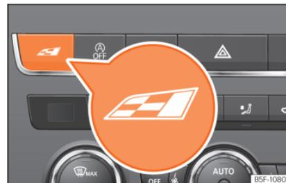
**Abb. 282** Mittelkonsole: Taste Cupra Drive Profile
