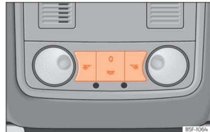
**Abb. 47** Ausschnitt aus Dachhimmel: Innenbeleuchtung vorn.
