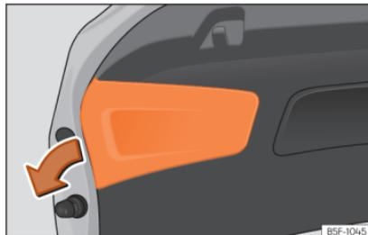
**Abb. 119** Abdeckung der Heckklappe entfernen
