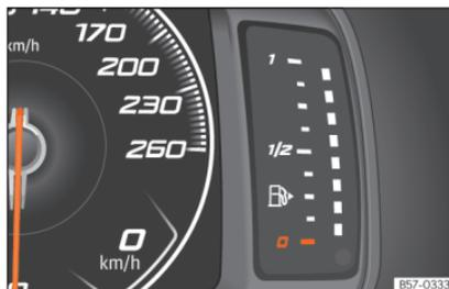
Abb. 132 Frei konfigurierbares Kombiinstrument: Kraftstoffvorratsanzeige.
