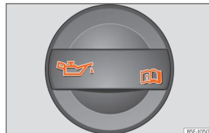
**Abb. 63** Deckel der Motoröl-Einfüllöffnung im Motorraum
