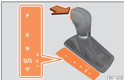
**Abb. 56** Automatisches Getriebe: Wählhebelsstellungen.
