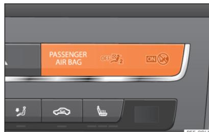
**Abb. 29** Instrumententafel: Kontrollleuchte für abgeschalteten Beifahrerairbag.
