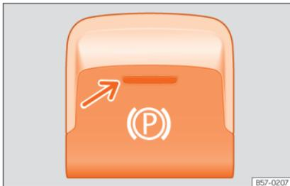
**Abb. 255** Im unteren Bereich der Mittelkonsole: Taste für die elektronische Parkbremse.
