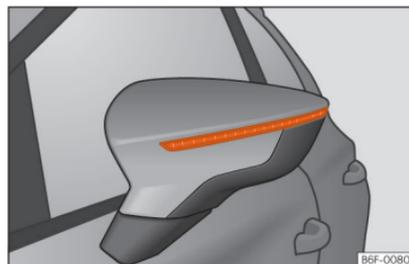
**Abb. 123** Blinker im Rückspiegel integriert
