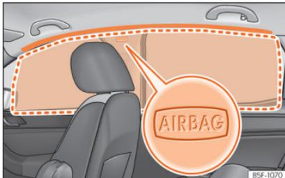
**Abb. 34** Einbauort der Kopfairbags
