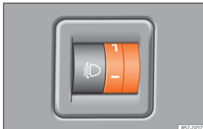
**Abb. 153** Neben dem Lenkrad: Regler für die Leuchtweitenregulierung.
