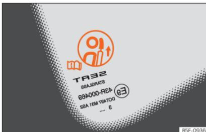
Abb. 91 Warnschild für Kopfstützenstellung
