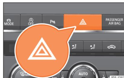
**Abb. 152** Instrumententafel: Schalter für die Warnblinkanlage
