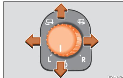
**Abb. 23** Ausschnitt der Fahrertür: Außenspiegelbedienung.
