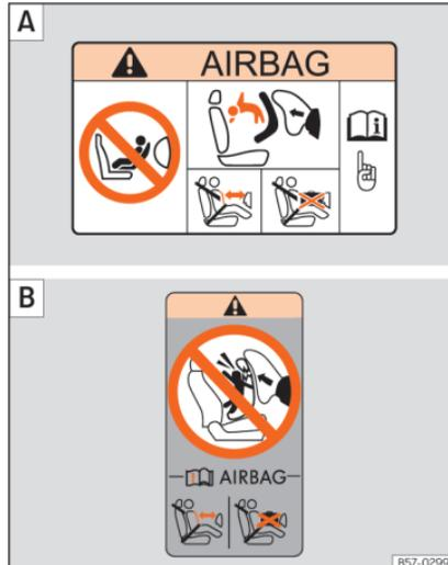
**Abb. 36** Airbagaufkleber - Version 1: an der Beifahrer-Sonnenblende **A** und am hinteren Türrahmen des Beifahrers **B**.
