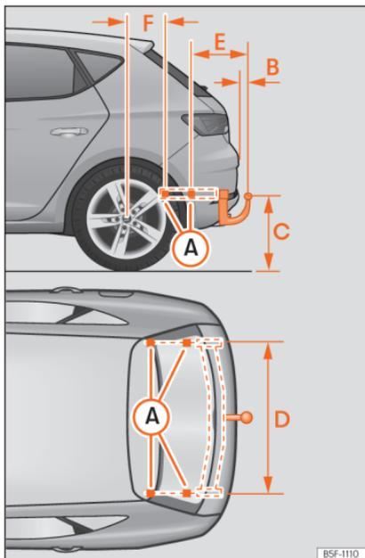
**Abb. 304** Befestigungspunkte für die Anhängervorrichtung
