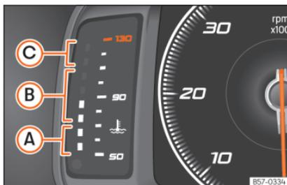
Abb. 135 Frei konfigurierbares Kombiinstrument: Motor-Kühlmitteltemperatur-Anzeige.
