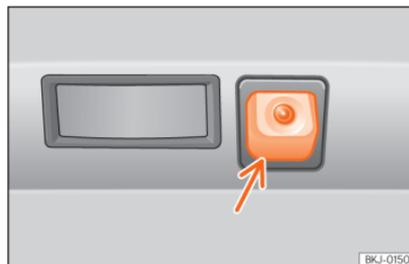
**Abb. 289** Im Stoßfänger hinten: Einbauort der Rückfahrkamera.
