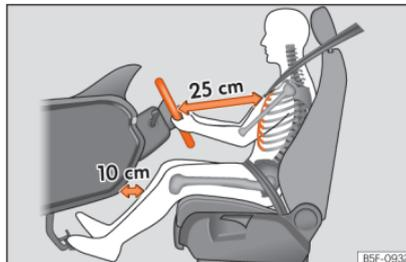
**Abb. 87** Der richtige Abstand des Fahrers zum Lenkrad.
