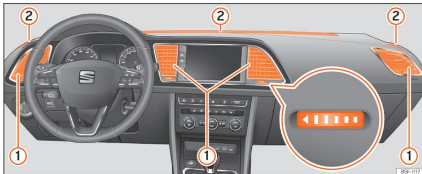
Abb. 198 Auf der Schalttafel: Luftzerstäuber.
