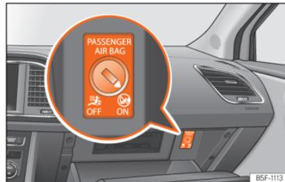
**Abb. 98** Schlüsselschalter zum Ein- und Abschalten des Beifahrerairbags.
