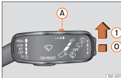
**Abb. 156** Scheibenwischerhebel: Regensensor **A** einstellen
