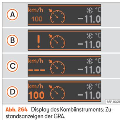
**Abb. 264** Display des Kombiinstrument: Zustandsanzeigen der GRA.
