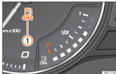
Abb. 133 Analoges Kombiinstrument: Erdgasvorratsanzeige
