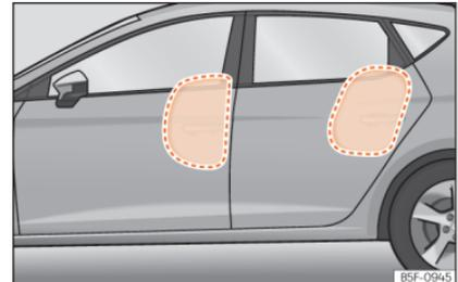
**Abb. 33** Komplett aufgeblasene Seitenairbags auf der linken Fahrzeugseite
