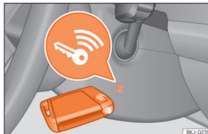
Abb. 253 Rechts an der Lenksäule: Notstart.
