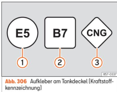
Abb. 306 Aufkleber am Tankdeckel (Kraftstoffkennzeichnung)
