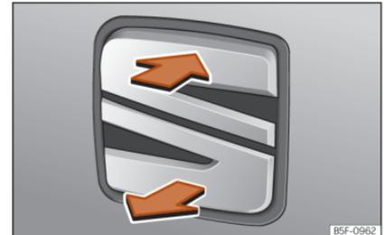
**Abb. 8** Heckklappe: Öffnen von außen
