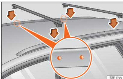
**Abb. 196** Leon ST: Befestigungspunkte der Längsstangen für Dachträger.
