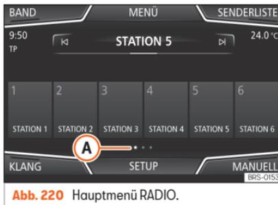
Im Hauptmenü **RADIO** können auf den nummerierten Funktionsflächen Sender des aktuell ausgewählten Frequenzbereichs gespeichert werden. Diese Funktionsflächen werden als „Speichertasten“ bezeichnet.
