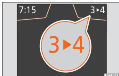
**Abb. 261** Kombi-Instrument: Ganganzeige (Handgetriebe).
