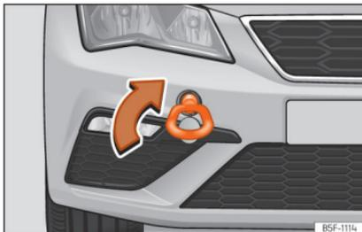
**Abb. 101** Vorderer Stoßfänger rechts: Eingeschraubte Abschleppöse
