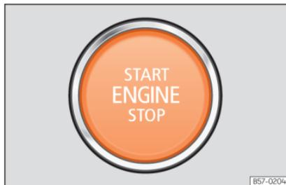
Abb. 252 Im unteren Bereich der Mittelkonsole: Starterknopf.
