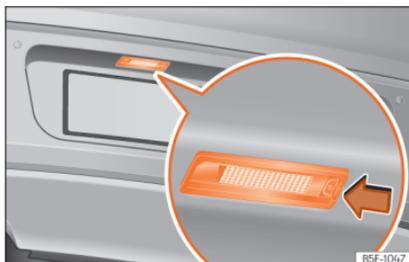
**Abb. 121** Im Stoßfänger hinten: Kennzeichenbeleuchtung.
