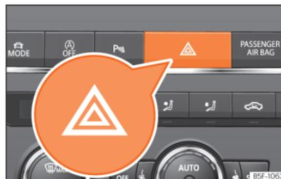
**Abb. 46** Instrumententafel: Schalter für die Warnblinkanlage
