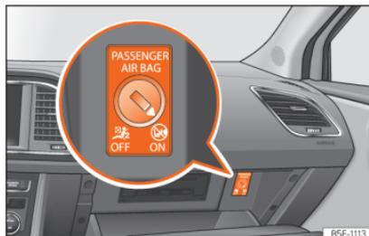
**Abb. 28** Schalter für Beifahrer-Frontairbag.
