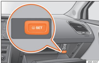
**Abb. 316** Handschuhfach: Schalter Reifenkонтроllanzeige.
