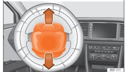
**Abb. 26** Einbauort Fahrerairbag: im Lenkrad. »
