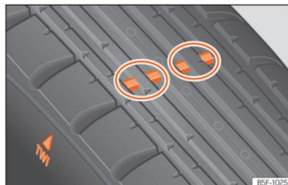
**Abb. 313** Reifenprofil: Verschleißanzeiger.
