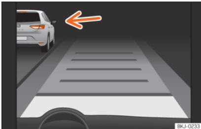
**Abb. 274** Im Display des Kombiinstrumentes: ACC aktiv, Fahrzeug auf der linken Seite erkannt
