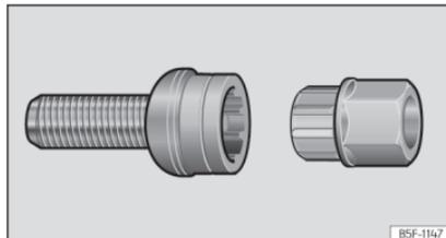
**Abb. 76** Diebstahlhemmende Radschraube mit Abdeckkappe und Adapter
