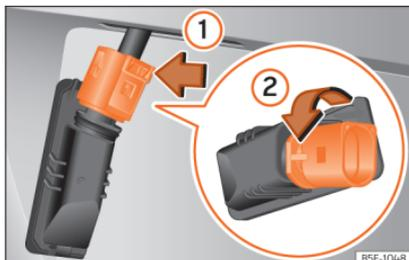
**Abb. 122** Kennzeichenleuchte: Lampenträger ausbauen.
