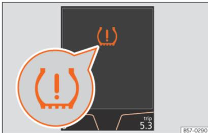
**Abb. 315** Kombi-Instrument: Warnung Reifendruckverlust.
