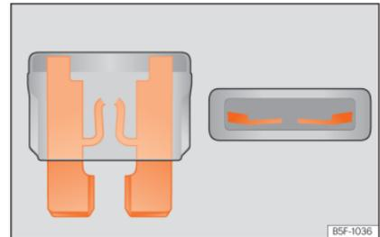
**Abb. 69** Darstellung einer durchgebrannten Sicherung.
