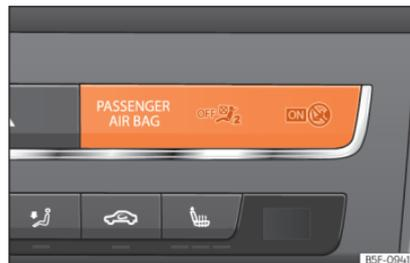
**Abb. 99** Instrumententafel: Kontrollleuchte für abgeschalteten Beifahrerairbag.
