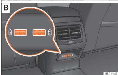
**Abb. 169** [A] Mittelkonsole: 12-Volt-Steckdose vorn. [B] Hinterer Teil der Mittelkonsole: USB-Steckdosen.
