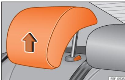
Abb. 90 Kopfstütze in Gebrauchsstellung
