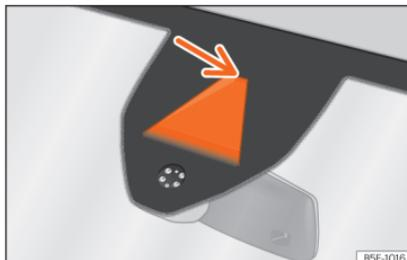
Abb. 277 Kamerasichtfenster des Spurhalteassistenten.
