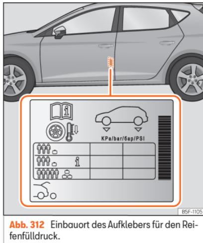
**Abb. 312** Einbauport des Aufklebers für den Reifendruck.
