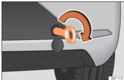
**Abb. 81** Hinterer Stoßfänger rechts: Eingeschraubte Abschleppöse
