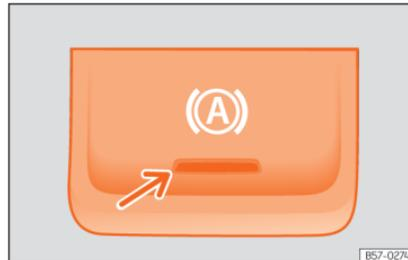
**Abb. 263** Im unteren Bereich der Mittelkonsole: Funktionstaste Auto-Hold.
