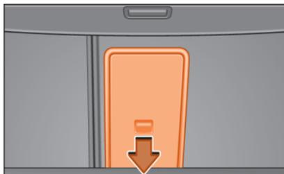
**Abb. 184** Im Gepäckraum: Öffnung der Durchladeeinrichtung.
