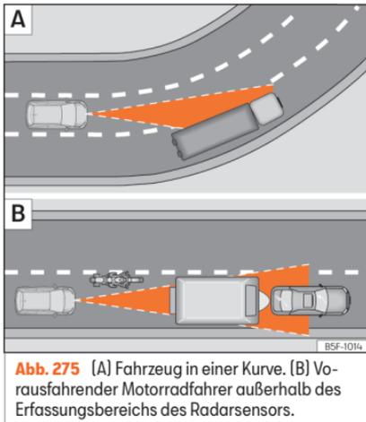
**Abb. 275** (A) Fahrzeug in einer Kurve. (B) Vorausfahrender Motorradfahrer außerhalb des Erfassungsbereichs des Radarsensors.
