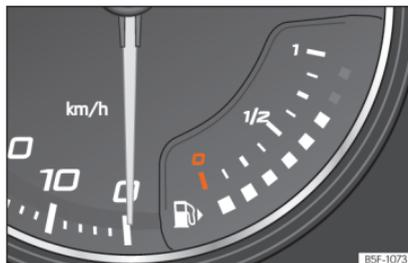
Abb. 131 Analoges Kombiinstrument: Kraftstoffvorratsanzeige
