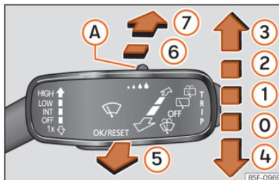
**Abb. 48** Bedienung von Windschutz- und Heckscheibenwischer
