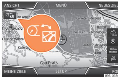
**Abb. 128** Infotainment-System: Taste zur Kartenübertragung
