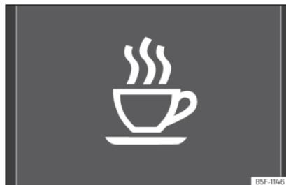
**Abb. 129** Im Display des Kombiinstruments: Symbol der Müdigkeitserkennung.
