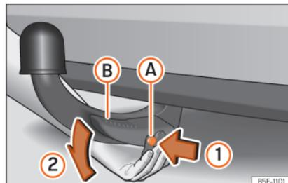
Abb. 301 Abnehmbaren Kugelkopf lösen
