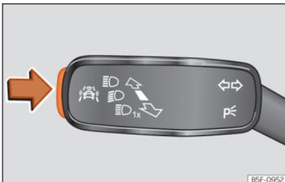
**Abb. 138** Am Blinker- und Fernlichthebel: Taste für die Fahrerassistenzsysteme.
