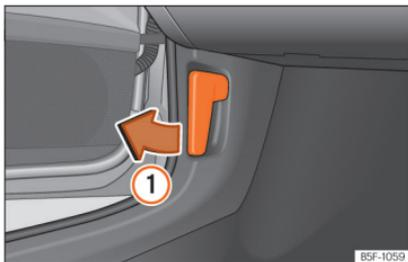
Abb. 12 Entriegelungshebel im Fahrerfußraum.
