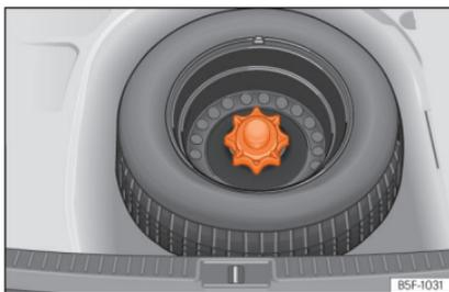
**Abb. 317** Notrad: hochgeklappter Ladeboden.
