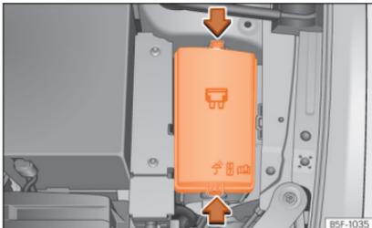
**Abb. 68** Im Motorraum: Abdeckung des Sicherungskastens.
