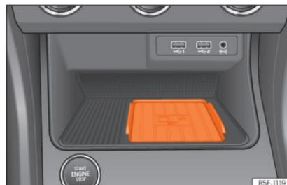
Abb. 250 In der Mittelkonsole: Aufnahme für die Mobiltelefonkopplung.
