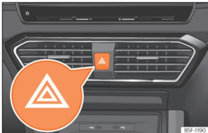
**Abb. 104** Instrumententafel: Schalter für Warnblinkanlage.
