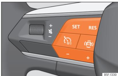
**Abb. 175** Am Multifunktionslenkrad: Tasten zum Bedienen der Geschwindigkeitsregelanlage
