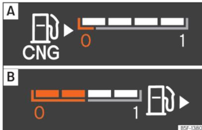
**Abb. 69** Frei konfigurierbares Kombiinstrument: **A**: Erdgasvorratsanzeige. **B**: Benzinvorratsanzeige
