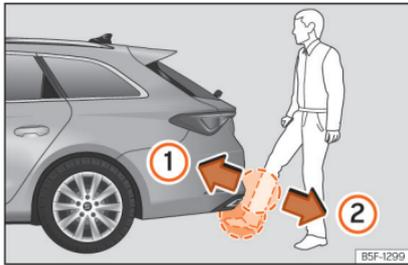
**Abb. 96** Heckklappe mit sensorgesteuerter Öffnung (Easy Open).
