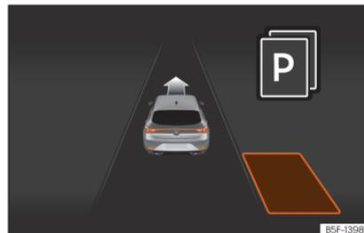
**Abb. 198** Am Bildschirm des Kombi-Instruments: Anzeige des Parklenkassistenten mit eingeschränkter Sicht.
