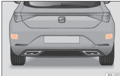
**Abb. 172** Heckansicht des Fahrzeugs: Bereiche der Radarsensoren.
