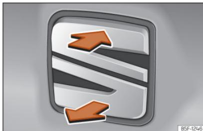
**Abb. 93** Heckklappe: Öffnen von außen.
