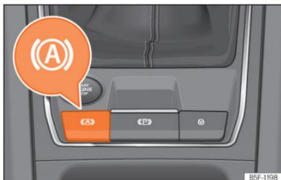
**Abb. 197** Im unteren Teil der Mittelkonsole: Taste für die Auto Hold-Funktion.
