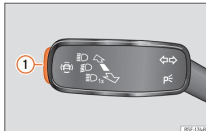
**Abb. 72** Am Blinker- und Fernlichthebel: Taste für die Fahrerassistenzsysteme (modellabhängig).
