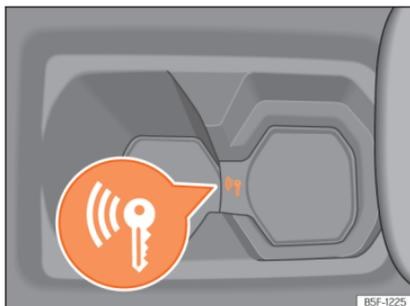
**Abb. 164** In der Mittelkonsole: Notstart.
