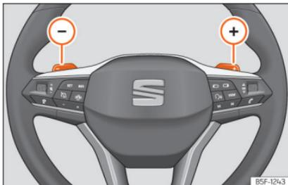
**Abb. 168** Lenkrad: Hebel für Automatikgetriebe.
