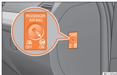
**Abb. 20** Schlüsselschalter zum Ein- und Abschalten des Beifahrerairbags.
