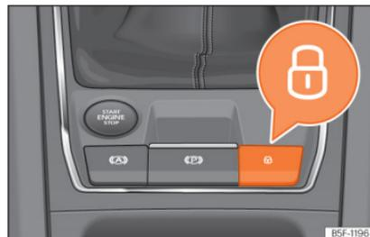
Abb. 87 In der Mittelkonsole: Zentralverriegelungstaster
