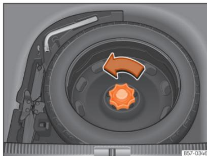
**Abb. 244** Im Gepäckraum: hochgeklappter Ladeboden.
