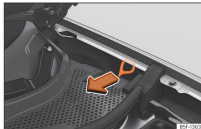
**Abb. 216** Zwischen dem linken Kotflügel und dem Scharnier der Frontklappe: Ziehgriff für manuelle Notentriegelung des Ladesteckers.
