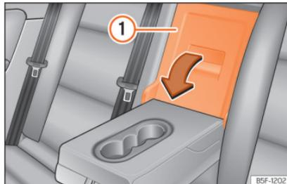
**Abb. 137** An der Rücksitzlehne: Öffnung der Durchladeeinrichtung.
