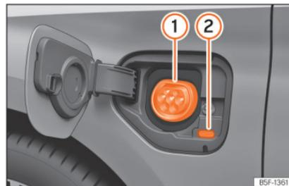
**Abb. 213** Hinter der Batterie-Ladepole vorn links: Ladedose
