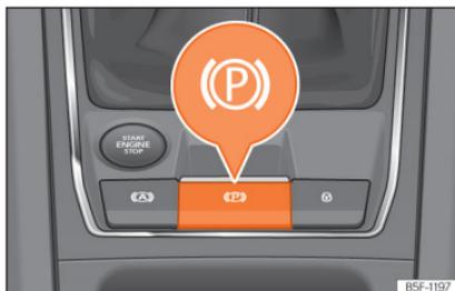
**Abb. 196** Im unteren Teil der Mittelkonsole: Taste für elektronische Parkbremse.
