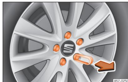
**Abb. 41** Rad: Radschrauben mit Deckel.
