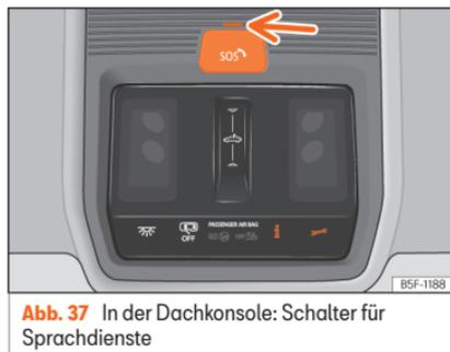
**Abb. 37** In der Dachkonsole: Schalter für Sprachdienste
