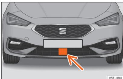
**Abb. 169** Am vorderen Stoßfänger: Radarsensor.
