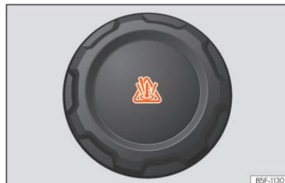
Abb. 234 Motorraum: Deckel des Motorkühlmittelausgleichsbehälters.
