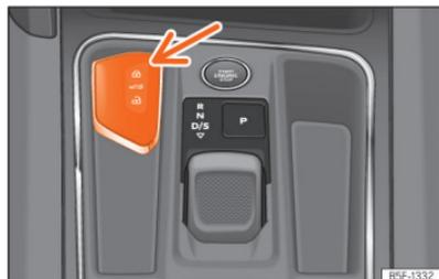
Abb. 82 Mittelkonsole: Aufnahme für den Fahrzeugschlüssel
