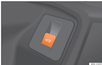
**Abb. 95** An der Fahrertür: Taste zum Öffnen und Schließen der Heckklappe.
