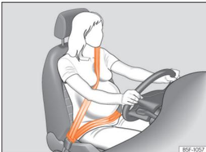
**Abb. 17** Gurtbandverlauf bei schwangeren Frauen.
