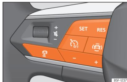
**Abb. 180** Am Multifunktionslenkrad: Tasten zur ACC-Bedienung »
