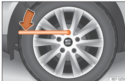
**Abb. 43** Radwechsel: Radschrauben lockern.
