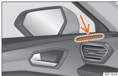
**Abb. 189** Kontrollleuchte des Spurwechselassistenten.
