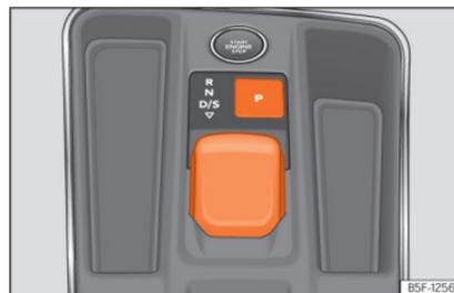
Abb. 167 In der Mittelkonsole: Wahlschalter.
