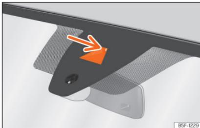
**Abb. 171** An der Windschutzscheibe: Kamerasichtfenster des Spurhalteassistenten.
