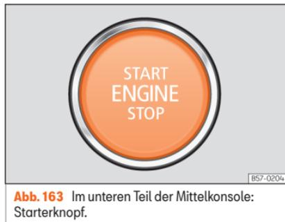
**Abb. 163** Im unteren Teil der Mittelkonsole: Starterknopf.
