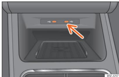
Abb. 161 Mittelkonsole: USB-Eingang.
