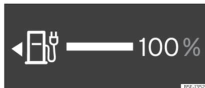
**Abb. 66** Frei konfigurierbares Kombiinstrument: Anzeige des Batterieładezustands.
