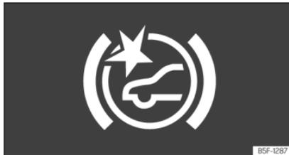
Abb. 177 Am Bildschirm des Kombi-Instruments: Anzeigen der Vorwarnung.
