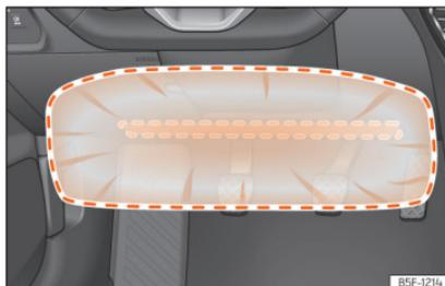
**Abb. 23** Auf der Fahrerseite: Wirkungsbereich des Knieairbags.
