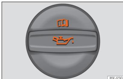
**Abb. 231** Deckel der Motoröl-Einfüllöffnung im Motorraum
