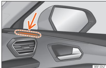
**Abb. 190** Kontrollleuchte des Spurwechselassistenten.
