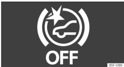
**Abb. 179** Am Bildschirm des Kombi-Instruments: Anzeige, dass Front Assist ausgeschaltet ist.
