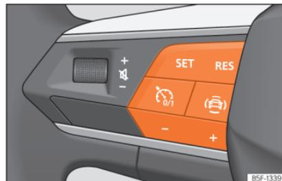
**Abb. 176** Am Multifunktionslenkrad: Tasten zum Bedienen des Geschwindigkeitsbegrenzers
