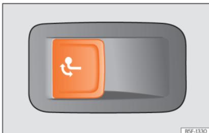
**Abb. 207** Im Gepäckraum links: Taste zur Entriegelung der Anhängerkupplung.
