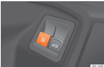
**Abb. 220** Fahrertür: Tankklappenentriegelung.
