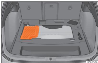
**Abb. 237** Plug-in-Hybridfahrzeuge (PHEV): Einbauort der Batterie im Kofferraum
