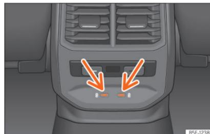
Abb. 162 Mittelkonsole hinten: USB-Anschlüsse mit Steckdosenfunktion.
