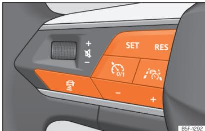
**Abb. 188** Linke Seite des Multifunktionslenkrads: Tasten zur Bedienung von Travel Assist.
