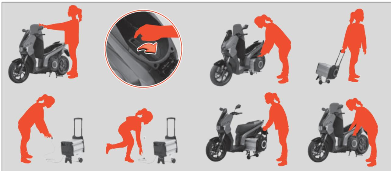
Fig. 31 Extracción de la batería
