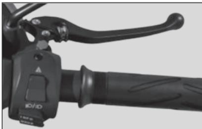
Fig. 5 Leva del freno
