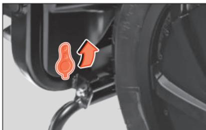
**Fig. 32** Lado izquierdo del eScooter: pestillo de seguridad
