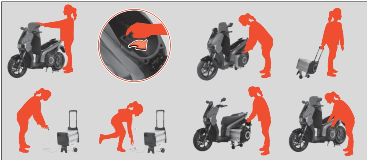
Bild 31 Demontera batteriet
