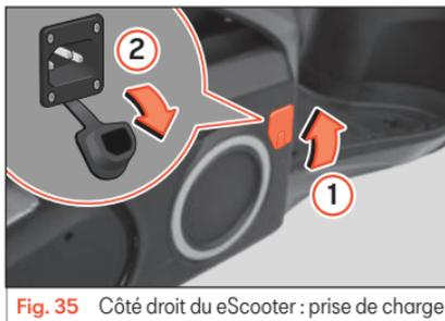
Fig. 35 Côté droit de l'eScooter : prise de charge
