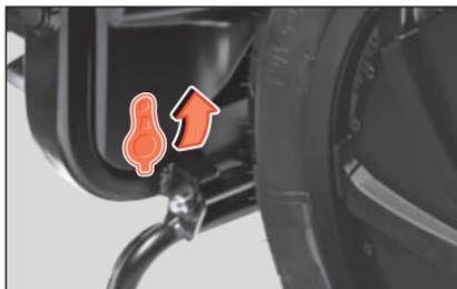
**Abb. 32** Linke Seite des eScooters: Sicherheitsverriegelung
