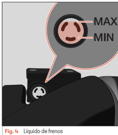
Fig. 4 Líquido de frenos
