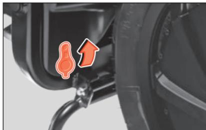
**Fig. 32** Lato sinistro dell'eScooter: fermo di sicurezza
