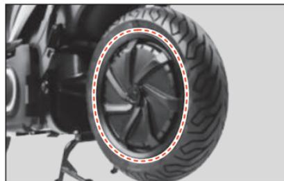
Fig. 26 Motore (ruota posteriore)
