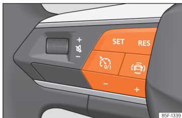
Abb. 173 Am Multifunktionslenkrad: Tasten zum Bedienen der Geschwindigkeitsregelanlage
