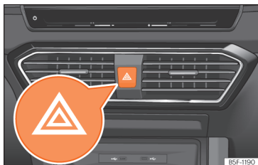
Abb. 103 Instrumententafel: Schalter für Warnblinkanlage.
