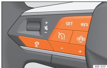
Abb. 179 Am Multifunktionslenkrad: Tasten zur ACC-Bedienung
