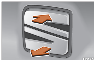
Abb. 92 Heckklappe: Öffnen von außen.
