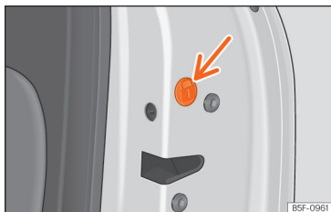
Abb. 90 Notfallsperre der Tür.
