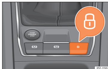
Abb. 86 In der Mittelkonsole: Zentralverriegelungstaster
