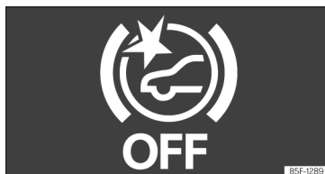
Abb. 178 Am Bildschirm des Kombi-Instruments: Anzeige, dass Front Assist ausgeschaltet ist.
