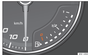
Abb. 67 Analoges Kombi-Instrument: Kraftstoffvorratsanzeige
