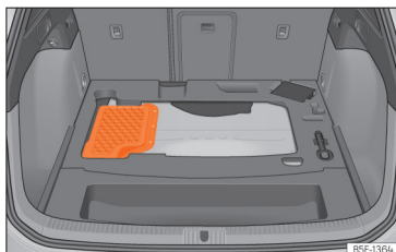
Abb. 231 Einbauort der Batterie im Kofferraum
