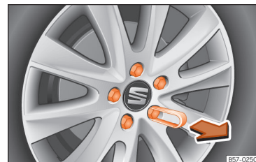
Abb. 41 Rad: Radschrauben mit Deckel.
