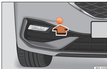
Abb. 51 Auf der rechten Seite des vorderen Stoßfängers: Abdeckung entfernen.
