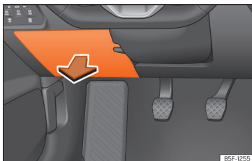
Abb. 55 Auf der Fahrerseite in der Instrumententafel: Abdeckung des Sicherungskasten.
