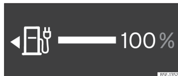
Abb. 66 Freiconfigurierbares Kombiinstrument: Anzeige des Batterieladezustands.
