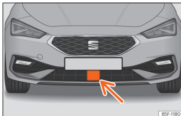
Abb. 167 Am vorderen Stoßfänger: Radarsensor.
