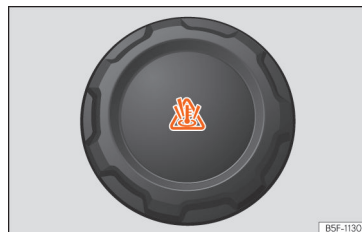
Abb. 228 Motorraum: Deckel des Motorkühlmittelausgleichsbehälters.
