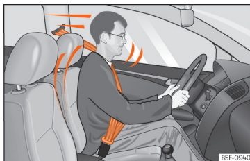
Abb. 11 Richtig angegurte Fahrer werden bei einem plötzlichen Bremsmanöver nicht nach vorne geschleudert.
