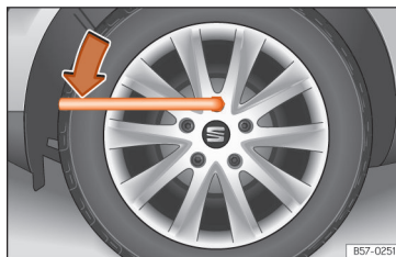
Abb. 43 Radwechsel: Radschrauben lockern.
