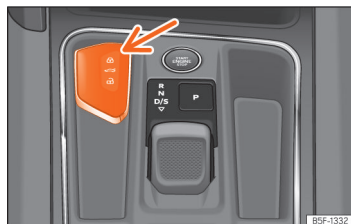
Abb. 81 Mittelkonsole: Aufnahme für den Fahrzeugschlüssel
