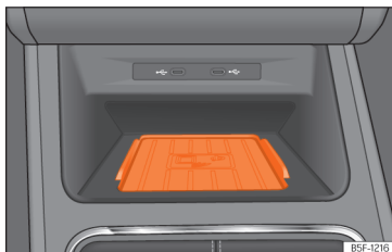
Abb. 158 In der Mittelkonsole: Aufnahme für die Mobiltelefonkopplung.
