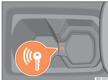
Abb. 162 In der Mittelkonsole: Notstart.
