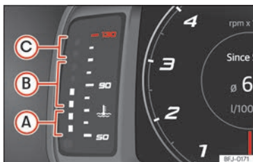
Abb. 6 Digitales Kombi-Instrument SEAT Digital Cockpit: Motorkühlmitteltemperatur-Anzeige.
