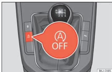
Abb. 85 Mittelkonsole: Systemtaste Start-Stopp.
