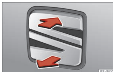
Abb. 55 Heckklappe: Öffnen von außen
