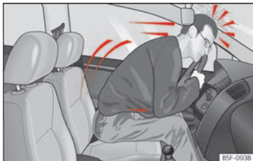
Abb. 19 Der nicht angegurte Fahrer wird nach vorn geschleudert.
