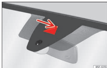
Abb. 96 An der Frontscheibe: Kamerasichtfenster des Spurhalteassistenten.
