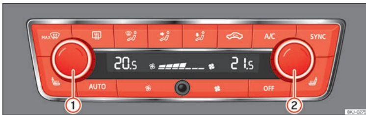
Abb. 80 In der Mittelkonsole: Bedienelemente der Climatronic.
