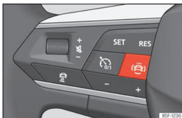
Abb. 93 Linke Seite des Multifunktionslenkrs: Taste für die Fahrerassistenzsysteme (modellabhängig).
