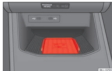
Abb. 135 In der Mittelkonsole: Aufnahme für die Mobiltelefonkopplung.
