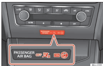
Abb. 28 Schalttafel-Mitteil: Kontrollleuchte für abgeschalteten Beifahrerairbag.
