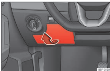
Abb. 159 Auf der Fahrerseite in der Schalttafel: Abdeckung des Sicherungskastens.
