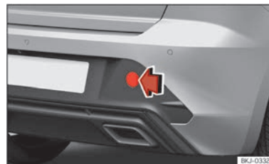
Abb. 157 Auf der rechten Seite des hinteren Stoßfängers: Abdeckung entfernen.
