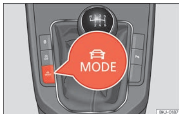
Abb. 91 Neben dem Schalthebel: Taste MODE.
