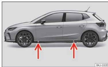
Abb. 188 Aufnahmepunkte für den Wagenheber.
