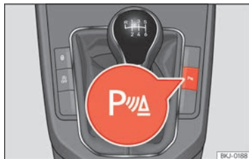
Abb. 121 Mittelkonsole: Taste für Einparkhilfe (je nach Ausführung).
