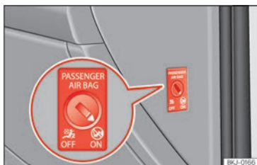
Abb. 27 Schlüsselschalter zum Ein- und Abschalten des Beifahrerairbags.
