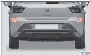
Abb. 97 Bereich hinter dem Fahrzeug: Bereiche der Radarsensoren.
