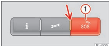
Abb. 42 In der Dachkonsole: Schalter für Sprachdienste
