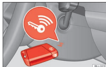
Abb. 84 Rechts an der Lenksäule: Notstart.
