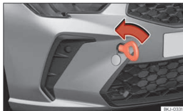
Abb. 156 Vorderer Stoßfänger rechts: eingeschraubte Abschleppöse
