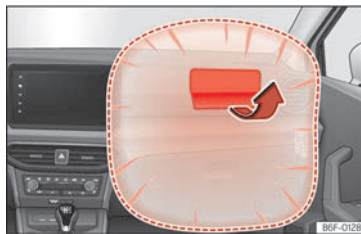
Abb. 26 Beifahrerairbag in der Schalttafel.
