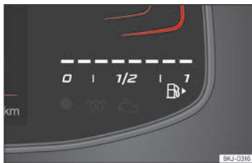
Abb. 3 Kombi-Instrument Basic: Kraftstoffvorratsanzeige.
