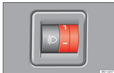
Abb. 72 Neben dem Lenkrad: Regler für die Leuchtweitenregulierung.
