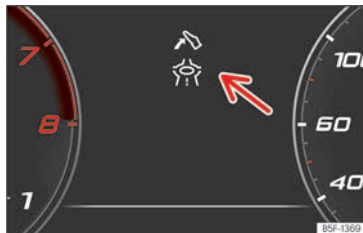
Abb. 102 Anzeige des Assistenten für eine ökologische Fahrweise (schematische Darstellung).
