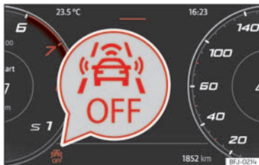
Abb. 112 Auf dem Display des Kombi-Instruments: Anzeige, dass Front Assist ausgeschaltet ist.
