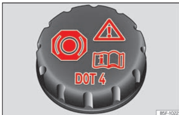
Abb. 171 Motorraum: Deckel des Bremsflüssigkeitsbehälters.
