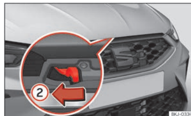
Abb. 168 Hebel unter der Motorraumklappe.
