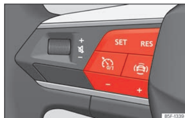
Abb. 101 Am Multifunktionslenkrad: Tasten zur Bedienung des Geschwindigkeitsbegrenzers.
