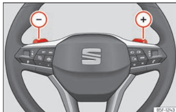
Abb. 89 Lenkrad: die Hebel für Automatikgetriebe.
