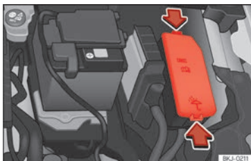
Abb. 160 Im Motorraum: Abdeckung des Sicherungskastens.
