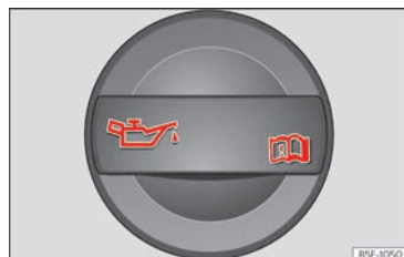
Abb. 176 Deckel der Motoröl-Einfüllöffnung im Motorraum.
