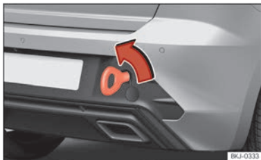
Abb. 158 Auf der rechten Seite des hinteren Stoßfängers: eingeschraubte Abschleppöse.
