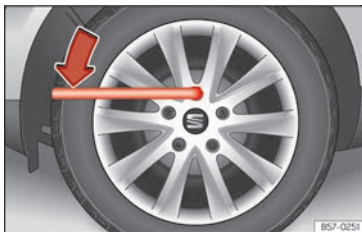
Abb. 186 Radwechsel: Radschrauben lockern.
