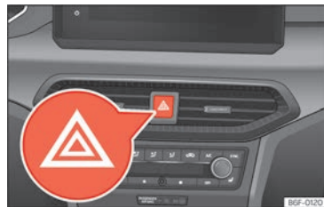
Abb. 41 Schalttafel: Schalter für die Warnblinkanlage
