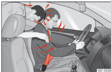
Abb. 20 Der nicht angegurte Mitfahrer auf dem Rücksitz wird nach vorn auf den angegurten Fahrer geschleudert.
