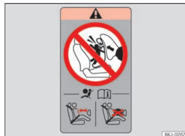
Abb. 34 Airbag-Label: auf dem Unterteil der Beifahrertürverkleidung.
