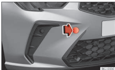
Abb. 155 Auf der rechten Seite des vorderen Stoßfängers: Abdeckung entfernen.
