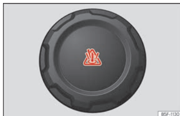
Abb. 170 Frontraum: Verschlussdeckel des Kühlmittelausgleichsbehälters.
