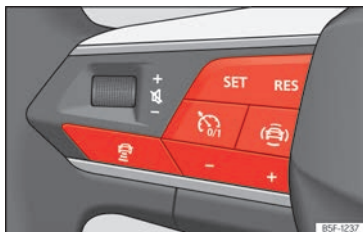
Abb. 104 Am Multifunktionslenkrad: Tasten zur ACC-Bedienung.
