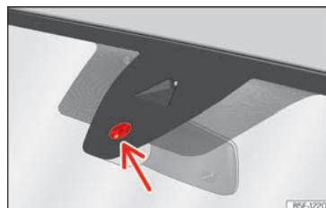
Abb. 76 Sensitive Fläche des Regensensors.
