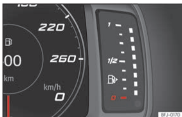
Abb. 4 Kombi-Instrument SEAT Digital Cockpit: Kraftstoffvorratsanzeige.
