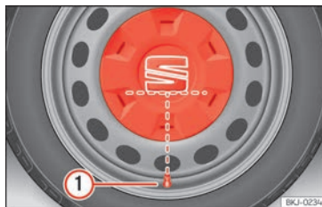
Abb. 182 Korrekte Anbringung der Radvollblende für Stahlfelgen.
