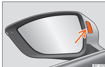
Abb. 177 Kontrollleuchte des Spurwechselassistenten.
