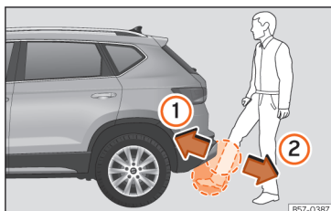
Abb. 89 Heckklappe mit sensorgesteuerter Öffnung (Easy Open).
