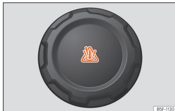
Abb. 215 Motorraum: Deckel des Motorkühlmittelausgleichsbehälters.
