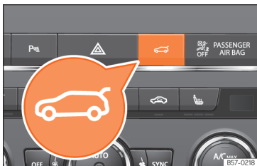
Abb. 88 Mittelkonsole: Taste zum Öffnen und Schließen der Heckklappe.
