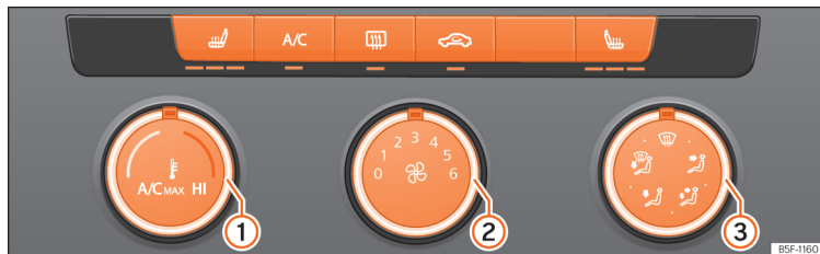
Abb. 135 In der Mittelkonsole: Bedienungselemente für die Klimaanlage.
