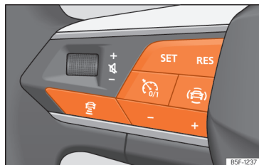
Abb. 168 Am Multifunktionslenkrad: Tasten zur ACC-Bedienung
