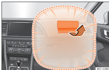
Abb. 15 Beifahrerairbag in der Instrumententafel
