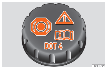
Abb. 216 Motorraum: Deckel des Bremsflüssigkeitsbehälters.
