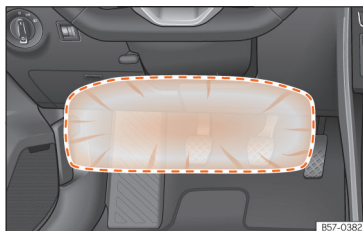
Abb. 19 Auf der Fahrerseite: Wirkungsbereich des Knieairbags.
