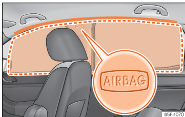
Abb. 22 Einbauort der Kopfairbags
