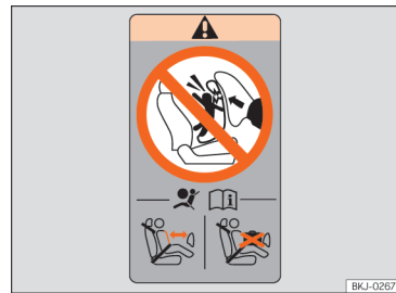
Abb. 25 Airbagaufkleber: Im hinteren Rahmen der Beifahrertür
