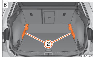
Abb. 119 Variabler Gepäckraumboden: A Hochstellung; B Tiefstellung.
