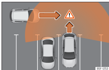
Abb. 181 Schematische Abbildung des Ausparkassistenten: Überwachter Bereich des ausparkenden Fahrzeugs.
