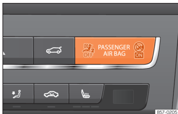
Abb. 17 Instrumententafel: Kontrollleuchte für Abschaltung des Beifahrerairbags.
