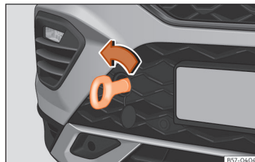
Abb. 46 Auf der rechten Seite des vorderen Stoßfängers: eingeschaubte Abschleppöse.
