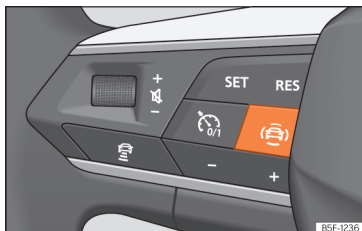
Abb. 66 Linke Seite des Multifunktionslenkads: Taste für die Fahrerassistenzsysteme (modellabhängig).
