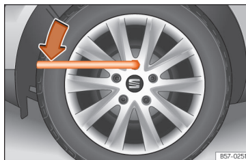
Abb. 36 Radwechsel: Radschrauben lockern.
