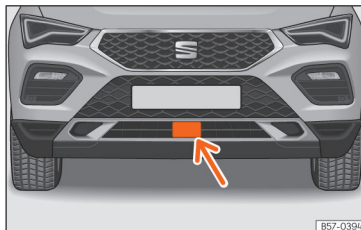
Abb. 157 Am vorderen Stoßfänger: Radarsensor.
