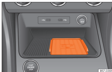
Abb. 145 In der Mittelkonsole: Aufnahme für die Mobiltelefonkopplung.
