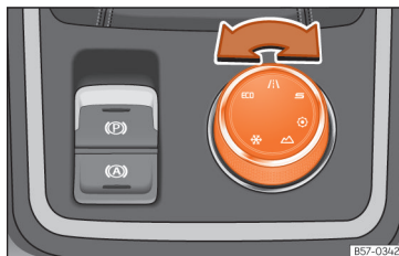
Abb. 156 Mittelkonsole: Drehknopf (Driving Experience button).
