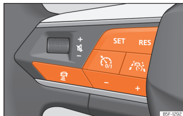
Abb. 176 Linke Seite des Multifunktionslenkads: Tasten zur Bedienung von Travel Assist.
