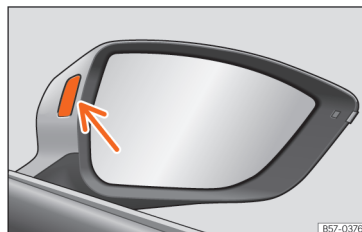
Abb. 178 Kontrollleuchte des Spurwechselassistenten.
