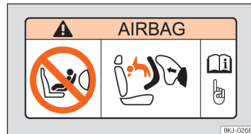
Abb. 24 Airbagaufkleber: an der Sonnenblende auf der Beifahrerseite
