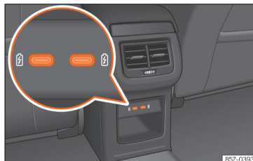
Abb. 147 Mittelkonsole hinten: USB-Anschlüsse mit Steckdosenfunktion.
