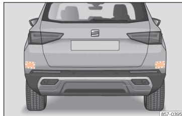
Abb. 160 Heckansicht des Fahrzeugs: Bereiche der Radarsensoren.
