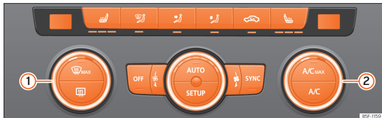
Abb. 134 In der Mittelkonsole: Bedienelemente der Climatronic.
