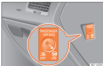
Abb. 16 Schlüsselschalter zum Ein- und Abschalten des Beifahrerairbags.
