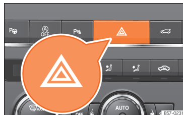
Abb. 99 Instrumententafel: Schalter für Warnblinkanlage.
