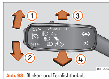
Abb. 98 Blinker- und Fernlichthebel.
