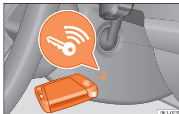
Abb. 149 Rechts an der Lenksäule: Notstart.
