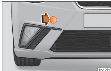
Abb. 47 Stoßfänger vorn rechts: Abdeckung entfernen.
