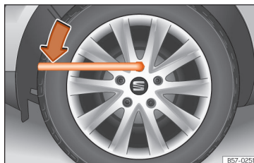
Abb. 38 Radwechsel: Radschrauben lockern.
