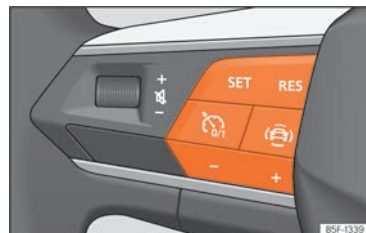
Abb. 114 Am Multifunktionslenkrad: Tasten zur Bedienung der Geschwindigkeitsregelanlage.
