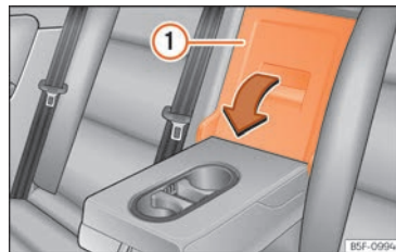
Abb. 180 An der Rücksitzlehne: Öffnung der Durchladeeinrichtung.
