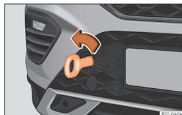
Abb. 198 Vorderer Stoßfänger rechts: Eingeschraubte Abschleppöse
