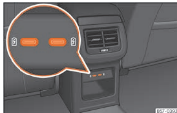
Abb. 161 Mittelkonsole hinten: USB-Anschlüsse mit Steckdosenfunktion.
