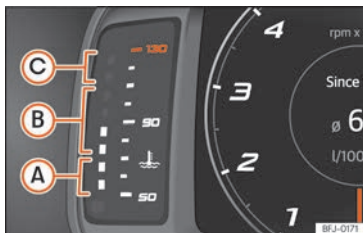
Abb. 8 Digitales Kombi-Instrument SEAT Digital Cockpit: Motorkühlmitteltemperatur-Anzeige.
