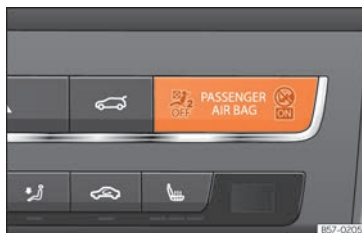
Abb. 30 Instrumententafel: Kontrollleuchte für abgeschalteten Beifahrerairbag.
