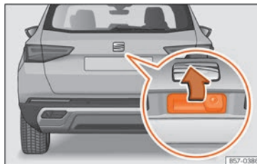
Abb. 59 Heckklappe: Öffnen von außen
