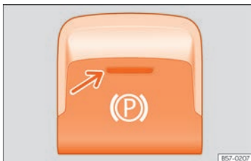
Abb. 134 Im unteren Bereich der Mittelkonsole: Taste für die elektronische Parkbremse.
