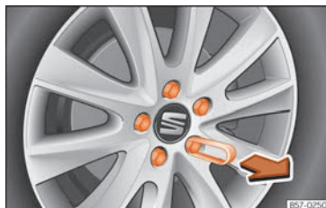
Abb. 224 Rad: Radschrauben mit Deckel.
