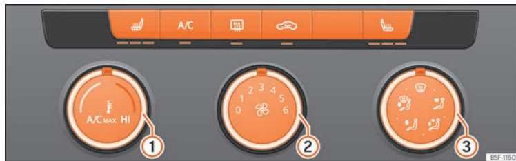
Abb. 93 In der Mittelkonsole: Bedienelemente der manuellen Klimaanlage.
