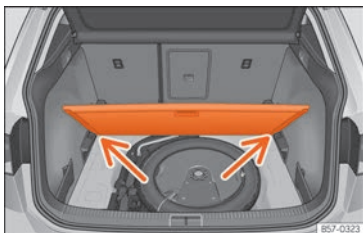
Abb. 174 Variabler Gepäckraumboden: geneigte Stellung.
