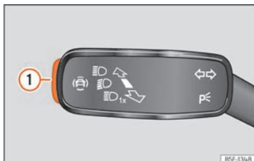
Abb. 106 Am Blinker- und Fernlichthebel: Taste für die Fahrerassistenzsysteme (modellabhängig).
