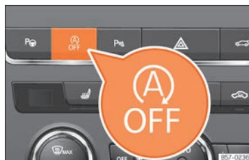
Abb. 99 Mittelkonsole: Systemtaste Start-Stopp.
