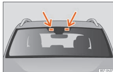
Abb. 95 Bereiche für das Anbringen elektronischen Zubehörs
