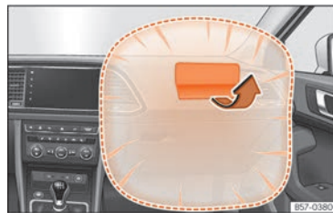
Abb. 28 Beifahrerairbag in der Instrumententafel
