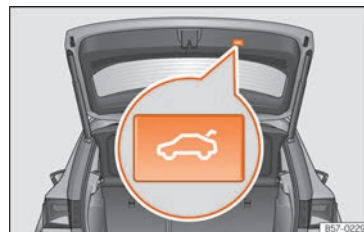
Abb. 60 Heckklappe: Taste zum Schließen der Heckklappe.
