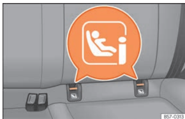
Abb. 39 Rücksitz: Einbauort der Halteösen ISOFIX oder i-Size.
