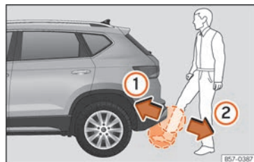
Abb. 62 Heckklappe mit sensorgesteuerter Öffnung [Easy Open].
