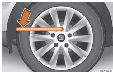
Abb. 226 Radwechsel: Radschrauben lockern
