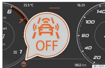
Abb. 126 Auf dem Display des Kombi-Instruments: Anzeige, dass Front Assist ausgeschaltet ist.
