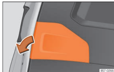
Abb. 205 Geöffnete Heckklappe: Abdeckung entfernen.
