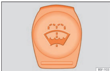
Abb. 212 Im Motorraum: Blauer Deckel des Scheibenwaschbehälters.
