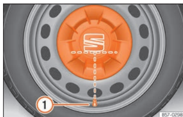
Abb. 223 Korrekte Anbringung der Radvollblende für Stahlfelgen.
