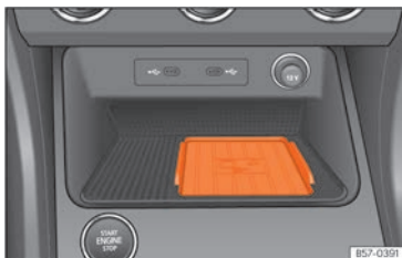
Abb. 168 In der Mittelkonsole: Aufnahme für die Mobiltelefonkopplung.
