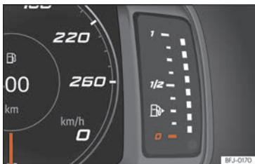
Abb. 6 Kombi-Instrument SEAT Digital Cockpit: Kraftstoffvorratsanzeige.
