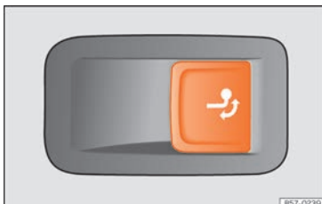
Abb. 184 Auf der rechten Seite im Gepäckraum: Taste zur Entriegelung der Anhängerkupplung.
