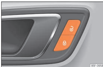
Abb. 54 An der Fahrertür: Zentralverriegelungstaster.
