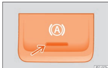
Abb. 135 Im unteren Bereich der Mittelkonsole: Funktionstaste Auto Hold.
