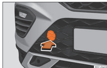
Abb. 197 Auf der rechten Seite des vorderen Stoßfängers: Abdeckung entfernen.
