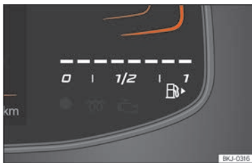
Abb. 5 Kombi-Instrument Basic: Kraftstoffvorratsanzeige.
