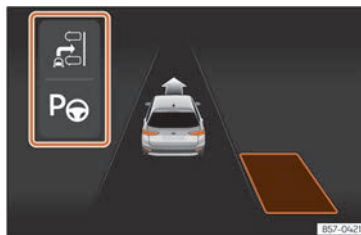
Abb. 142 Am Bildschirm des Kombi-Instruments: Anzeige des Parklenkassistenten mit eingeschränkter Sicht.
