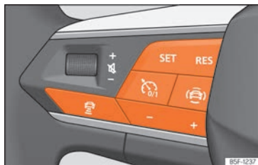
Abb. 118 Am Multifunktionslenkrad: Tasten zur ACC-Bedienung.
