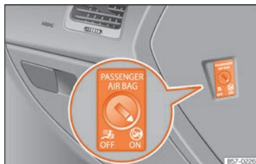
Abb. 29 Schlüsselschalter zum Ein- und Abschalten des Beifahrerairbags.
