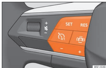
Abb. 115 Am Multifunktionslenkrad: Tasten zur Bedienung des Geschwindigkeitsbegrenzers.
