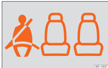
Abb. 20 Kombi-Instrument: Gurtstatusanzeige für die hinteren Sitzplätze.
