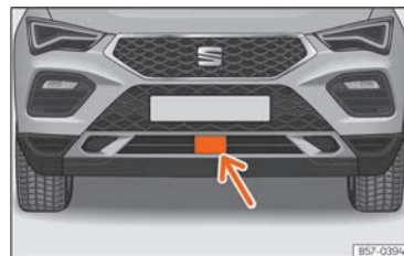
Abb. 108 Im vorderen Stoßfänger: Radarsensor.
