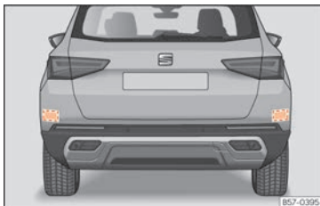
Abb. 111 Bereich hinter dem Fahrzeug: Bereiche der Radarsensoren.
