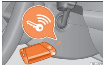
Abb. 98 Rechts an der Lenksäule: Notstart.
