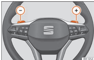
Abb. 103 Lenkrad: die Hebel für Automatikgetriebe.
