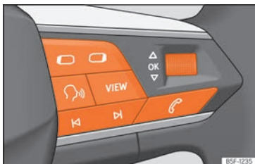
Abb. 12 Rechte Seite des Multifunktionslenkrads: Bedienelemente für die Menüs und Informationsanzeigen im Kombi-Instrument (modellabhängig).
