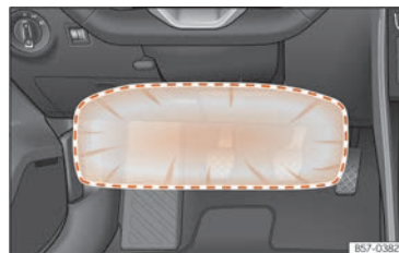
Abb. 35 Auf der Fahrerseite: Wirkungsbereich des Knieairbags.
