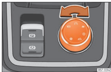
Abb. 105 Mittelkonsole: Drehknopf (Driving Experience button).
