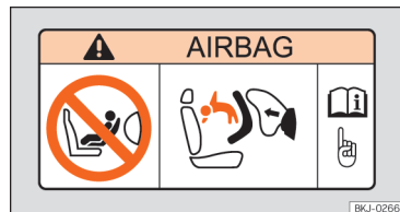
Abb. 37 Airbag-Label: an der Sonnenblende Beifahrerseite.
