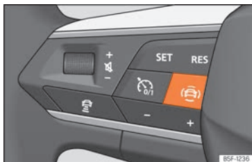
Abb. 107 Linke Seite des Multifunktionslenkrs: Taste für die Fahrerassistenzsysteme (modellabhängig).
