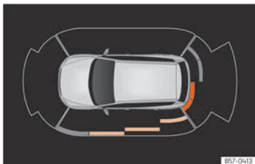
Abb. 139 Anzeige der Einparkhilfe auf dem Bildschirm des Infotainment-Systems.
