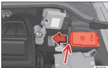
Abb. 57 Im Motorraum: Abdeckung des Sicherungskastens.
