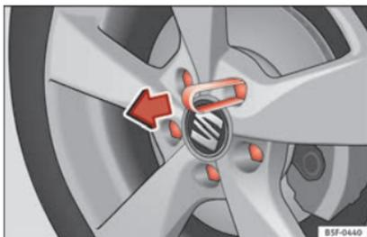
Abb. 62 Rad: Radschrauben mit Deckel.
