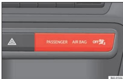
**Abb. 85** Instrumententafel-Mittelteil: Kontrollleuchte für abgeschalteten Beifahrer-Frontairbag.
