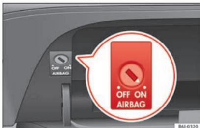
**Abb. 84** Im Handschuhfach: Schlüsselschalter zum Ein- und Abschalten des Beifahrer-Airbags
