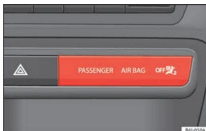
**Abb. 43** Kontrollämpchen für Abschaltung des und Beifahrerairbags.
