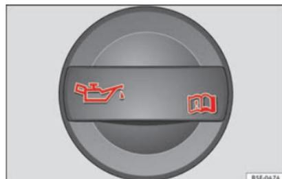
**Abb. 52** Deckel der Motoröl-Einfüllöffnung im Motorraum
