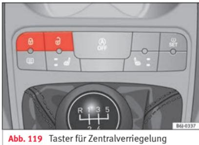
Abb. 119 Taster für Zentralverriegelung
