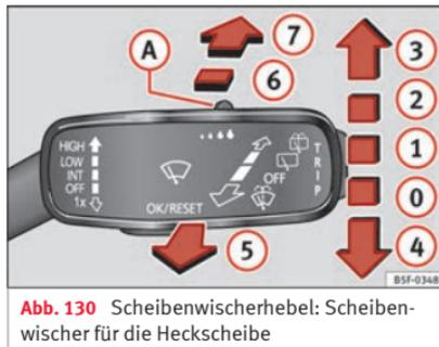
Abb. 130 Scheibenwischerhebel: Scheibenwischer für die Heckscheibe
