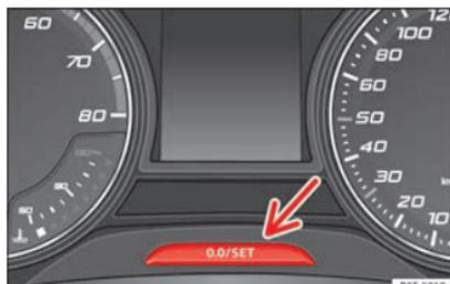
**Abb. 114** Kombi-Instrument: Kilometerzähler und Rückstelltaste.
