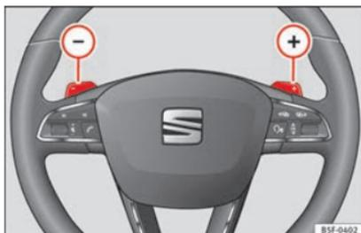
Abb. 160 Lenkrad mit Schaltwippen für Automatikgetriebe.
