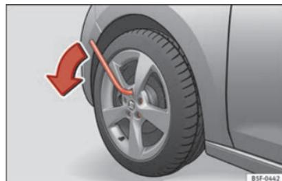
Abb. 64 Rad: Radschrauben lockern.
