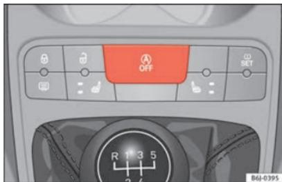
**Abb. 162** Ansicht des Tasters für den Start-Stopp-Betrieb
