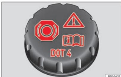
**Abb. 54** Motorraum: Deckel des Bremsflüssigkeitsbehälters
