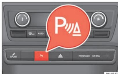
Abb. 165 Mittelkonsole: Taste für Einparkhilfe.
