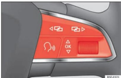
**Abb. 37** Rechte Seite Multifunktions-Lenkrad: Steuertasten.
