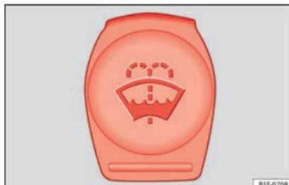
**Abb. 55** Im Motorraum: Deckel des Scheibenwaschbehälters.
