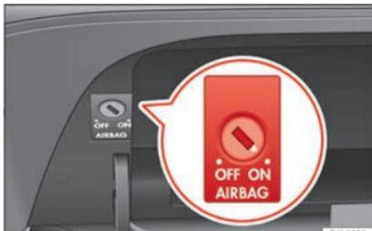
Abb. 18 Schalter für Beifahrer-Frontairbag.
