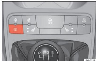
**Abb. 128** Mittelkonsole: Schalter für Heckscheibenbeheizung.
