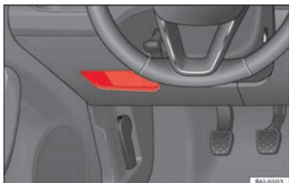
Abb. 56 Auf der Fahrerseite in der Instrumententafel: Abdeckung des Sicherungskastens.
