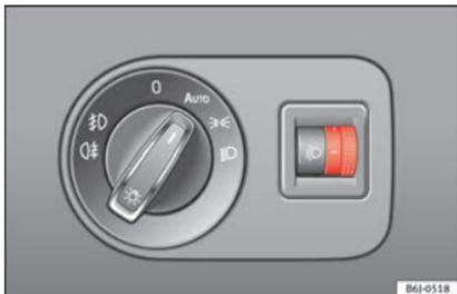
**Abb. 127** Instrumententafel: Regler für Leuchtweitenregulierung.
