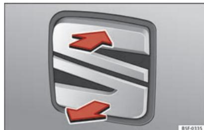
Abb. 3 Heckklappe: Öffnen von außen
