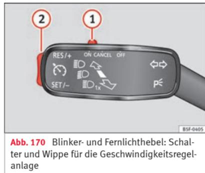
**Abb. 170** Blinker- und Fernlichthebel: Schalter und Wippe für die Geschwindigkeitsregelanlage
