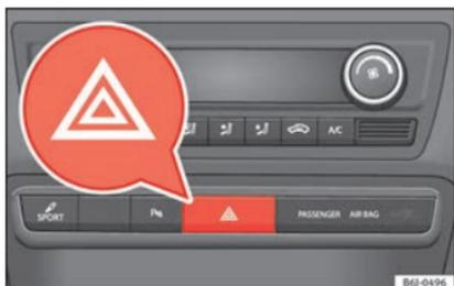
**Abb. 31** Instrumententafel: Schalter für die Warnblinkanlage
