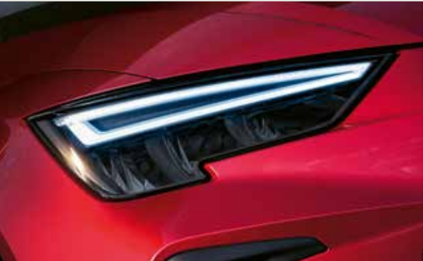
Voll-LED-Scheinwerfer mit dem neuen LED Tagfahrlicht HIGH
