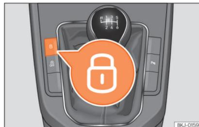
Abb. 134 Taster für Zentralverriegelung
