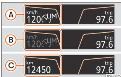
**Abb. 226** Am Bildschirm des Kombi-Instruments: Anzeige des Zustands des Geschwindigkeitsbegrenzers.
