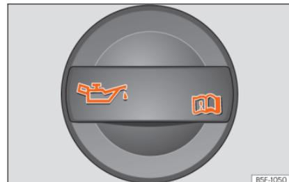
**Abb. 59** Deckel der Motoröl-Einfüllöffnung im Motorraum
