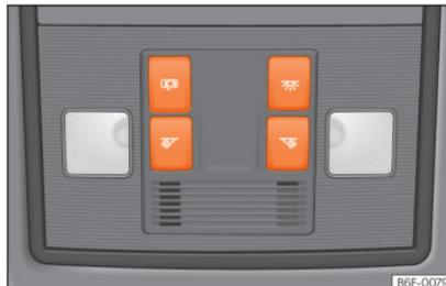
**Abb. 44** Ausschnitt aus Dachhimmel: Innenbeleuchtung vorn.
