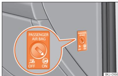
**Abb. 24** Schalter für Beifahrer-Frontairbag.
