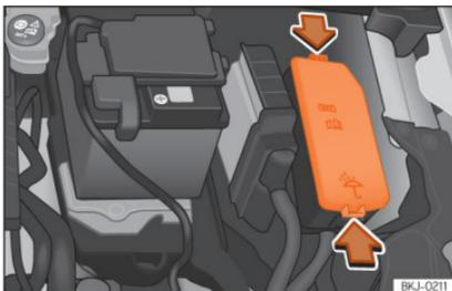
**Abb. 64** Im Motorraum: Abdeckung des Sicherungskastens.
