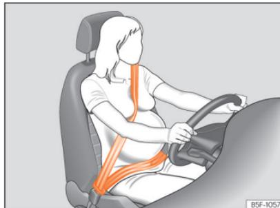
**Abb. 93** Gurtbandverlauf bei schwangeren Frauen.
