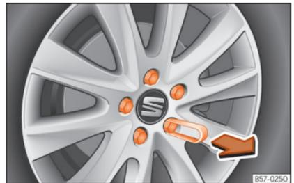
**Abb. 71** Rad: Radschrauben mit Deckel.
