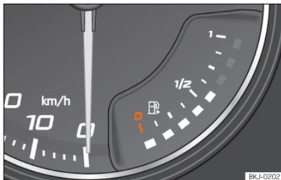
**Abb. 121** Analoges Kombi-Instrument: Kraftstoffvorratsanzeige
