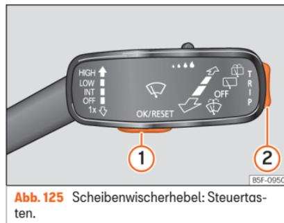
**Abb. 125** Scheibenwischerhebel: Steuertasten.
