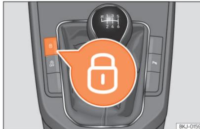
Abb. 5 Mittelkonsole: Zentralverriegelungstaster.
