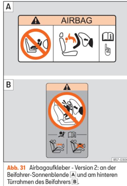
**Abb. 31** Airbagaufkleber - Version 2: an der Beifahrer-Sonnenblende [A] und am hinteren Türrahmen des Beifahrers [B].
