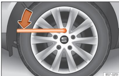
**Abb. 72** Radwechsel: Radschrauben lockern
