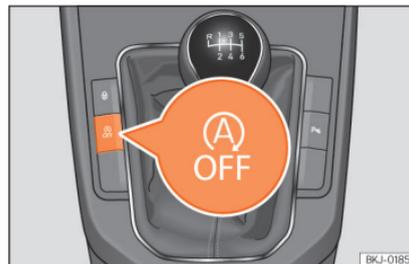
**Abb. 224** Mittelkonsole: Systemtaste Start-Stopp.
