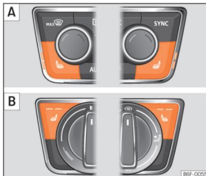
**Abb. 149** In der Mittelkonsole: Regler für die Sitzheizung der Vordersitze. **A**: Ausführung mit Climatronic. **B**: Ausführung mit manueller Klimaanlage.
