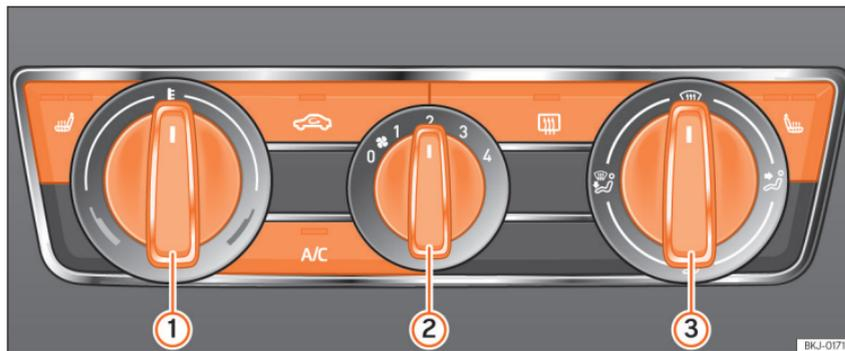
**Abb. 169** Bedienelemente Klimaanlage in der Instrumententafel.
