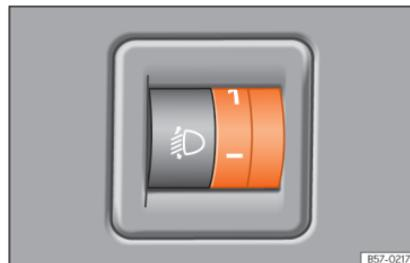
**Abb. 143** Instrumententafel: Regler für Leuchtweitenregulierung.
