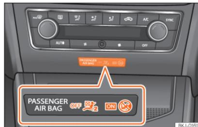
**Abb. 25** Instrumententafel-Mittelteil: Kontrollleuchte für abgeschalteten Beifahrer-Frontairbag.
