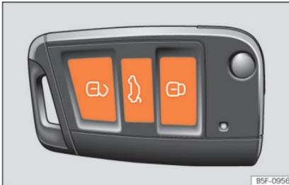
Abb. 4 Funkschlüssel: Tasten
