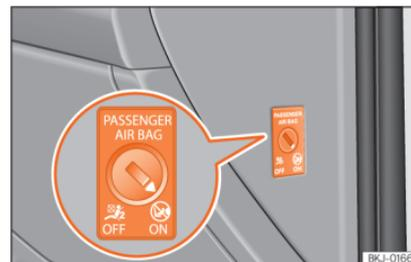
Abb. 94 Schlüsselschalter zum Ein- und Abschalten des Beifahrerairbags.
