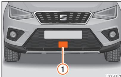
**Abb. 230** Im vorderen Stoßfänger: Radarsensor.
