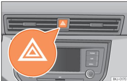
**Abb. 43** Instrumententafel: Schalter für die Warnblinkanlage
