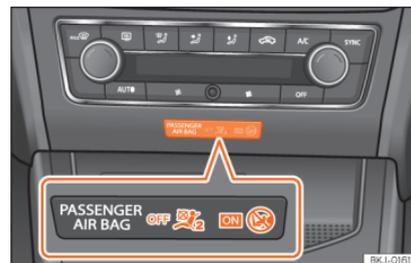
Abb. 95 Instrumententafel-Mittelteil: Kontrollleuchte für abgeschalteten Beifahrer-Frontairbag.
