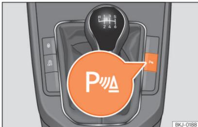
**Abb. 254** Mittelkonsole: Taste für Einparkhilfe (je nach Ausführung).
