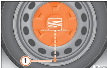
**Abb. 70** Korrekte Anbringung der Radvollblende für Stahlfelgen.
