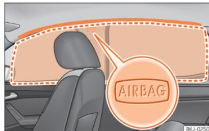
**Abb. 28** Einbauteil und Entfaltungsbereich des Kopfairbags.
