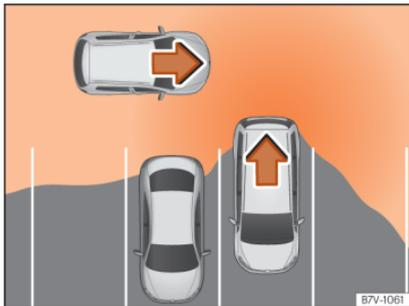
**Abb. 245** Schematische Abbildung des Ausparkassistenten: Überwacher Bereich des ausparkenden Fahrzeugs.
