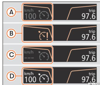
**Abb. 225** Bildschirm des Kombi-Instruments: Zustandsanzeigen der GRA.
