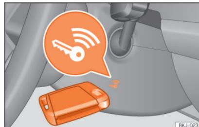
**Abb. 216** Rechts an der Lenksäule: Notstart.
