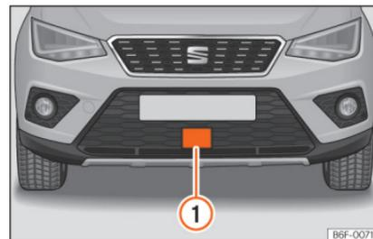
**Abb. 235** Im vorderen Stoßfänger: Radarsensor.
