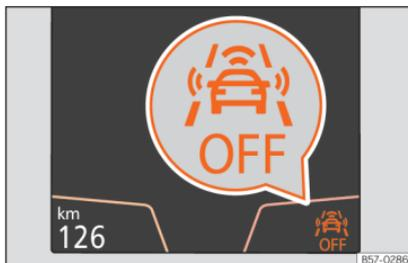
**Abb. 231** Auf dem Bildschirm des Kombi-Instruments: Anzeige, dass Front Assist ausgeschaltet ist.
