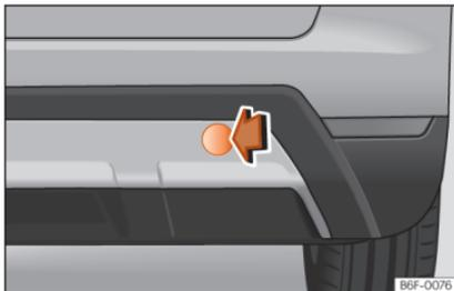
**Abb. 99** Hinterer Stoßfänger rechts: Abdeckkappe-Deckel.
