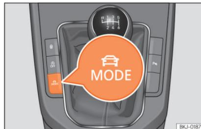
**Abb. 246** Neben dem Schalthebel: Taste **MODE**.
