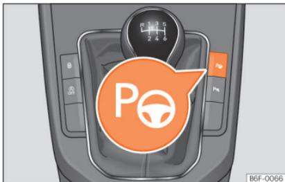
**Abb. 247** In der Mittelkonsole: Taste zum Einschalten des Parklenkassistenten.
