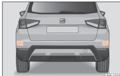
Abb. 242 Bereich hinter dem Fahrzeug: Bereiche der Radarsensoren.
