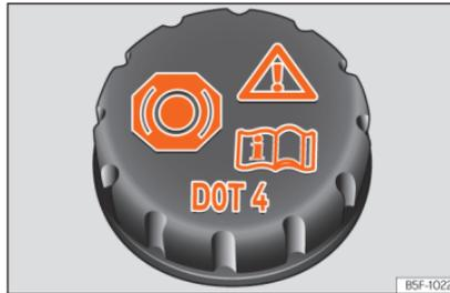
**Abb. 61** Motorraum: Deckel des Bremsflüssigkeitsbehälters
