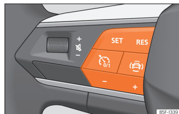
Abb. 101 Am Multifunktionslenkrad: Tasten zur Bedienung der Geschwindigkeitsregelanlage.
