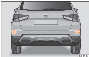
Abb. 98 Bereich hinter dem Fahrzeug: Bereiche der Radarsensoren.
