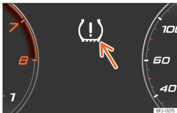
Abb. 200 Kombi-Instrument: Warnung Reifendruckverlust.
