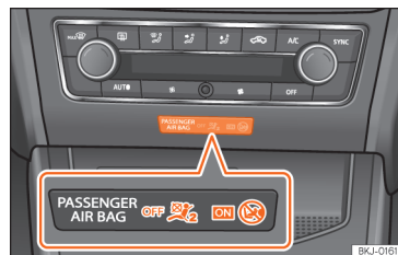
Abb. 31 Instrumententafel-Mittelteil: Kontrollleuchte für abgeschalteten Beifahrer-Frontairbag.
