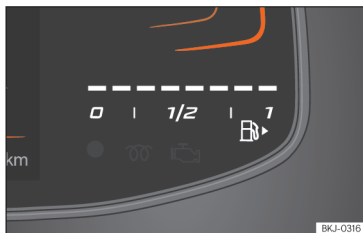
Abb. 5 Kombi-Instrument Basic: Kraftstoffvorratsanzeige.
