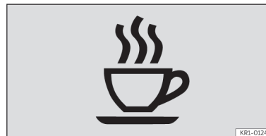
Abb. 7 Am Bildschirm des Kombi-Instruments: Symbol des Müdigkeitsmonitors.
