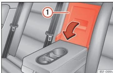
Abb. 178 An der Rücksitzlehne: Öffnung der Durchladeeinrichtung.
