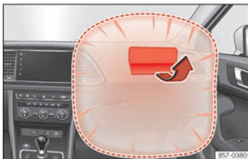
Abb. 25 Beifahrerairbag in der Schalttafel.
