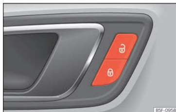
Abb. 51 An der Fahrertür: Zentralverriegelungstaster.
