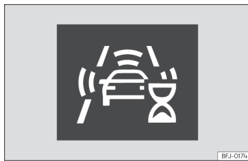
Abb. 122 Im Display des Kombi-Instruments: Anzeige der ersten Selbstkalibrierung des Systems.
