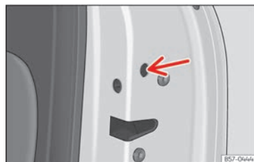
Abb. 54 Notverriegelung der Tür.
