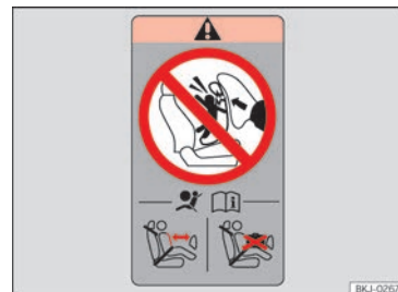
Abb. 35 Airbag-Label: am hinteren Rahmen der Beifahrertür.
