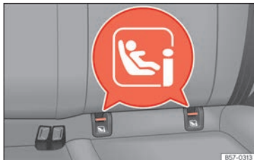
Abb. 36 Rücksitz: Einbauort der Halteösen ISOFIX oder i-Size.
