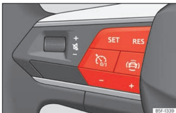
Abb. 111 Am Multifunktionslenkrad: Tasten zur Bedienung der Geschwindigkeitsregelanlage.
