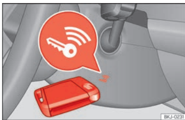
Abb. 95 Rechts an der Lenksäule: Notstart.
