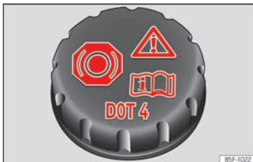
Abb. 210 Motorraum: Deckel des Bremsflüssigkeitsbehälters.
