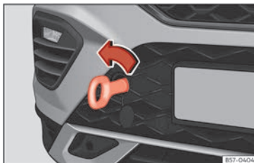
Abb. 197 Vorderer Stoßfänger rechts: eingeschraubte Abschleppöse
