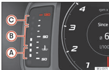
Abb. 6 Digitales Kombi-Instrument SEAT Digital Cockpit: Motorkühlmitteltemperatur-Anzeige.
