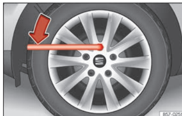
Abb. 224 Radwechsel: Radschrauben lockern.
