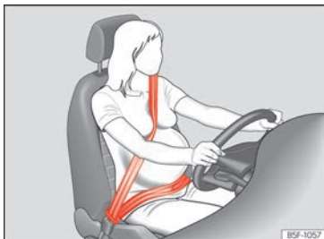
Abb. 23 Gurtbandverlauf bei schwangeren Frauen.
