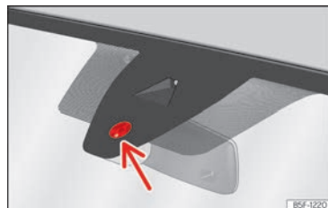
Abb. 85 Sensitive Fläche des Regensensors.
