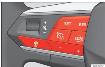
Abb. 115 Am Multifunktionslenkrad: Tasten zur ACC-Bedienung.
