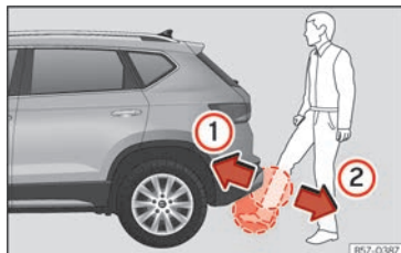
Abb. 59 Heckklappe mit sensorgesteuerter Öffnung [Easy Open].
