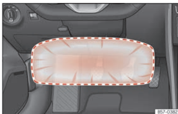
Abb. 32 Auf der Fahrerseite: Wirkungsbereich des Knieairbags.
