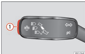
Abb. 103 Am Blinker- und Fernlichthebel: Taste für die Fahrerassistenzsysteme (modellabhängig).
