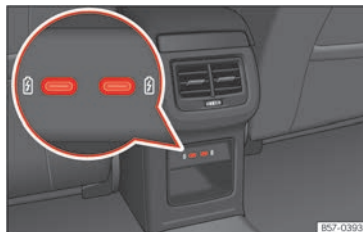
Abb. 159 Mittelkonsole hinten: USB-Anschlüsse mit Steckdosenfunktion.
