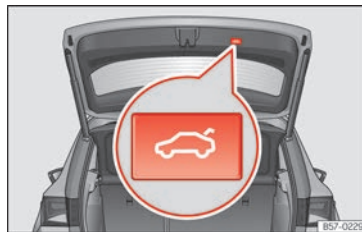
Abb. 58 Heckklappe: Taste zum Schließen der Heckklappe.
