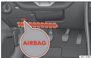
Abb. 31 Auf der Fahrerseite: Einbauort des Knieairbags.
