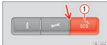
Abb. 42 In der Dachkonsole: Schalter für Sprachdienste
