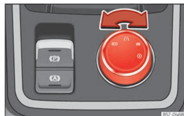
Abb. 102 Mittelkonsole: Drehschalter (Driving Experience button).
