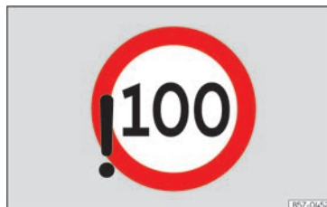
Abb. 9 Am Bildschirm des Kombi-Instruments: Überschreitung der zulässigen Höchstgeschwindigkeit festgestellt (Abbildung).
