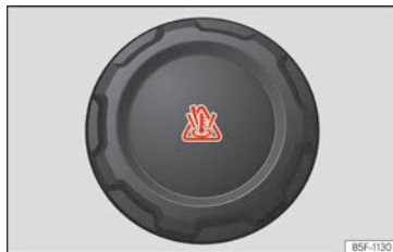
Abb. 209 Frontraum: Verschlussdeckel des Kühlmittelausgleichsbehälters.
