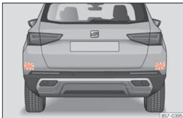
Abb. 108 Bereich hinter dem Fahrzeug: Bereiche der Radarsensoren.
