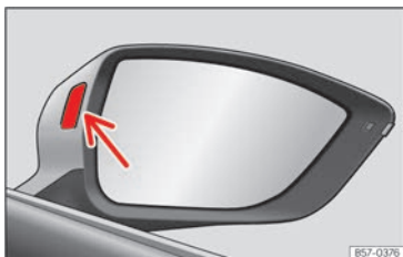
Abb. 128 Kontrollleuchte des Spurwechselassistenten.
