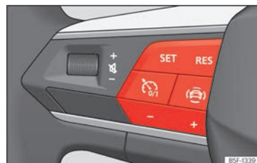
Abb. 112 Am Multifunktionslenkrad: Tasten zur Bedienung des Geschwindigkeitsbegrenzers.
