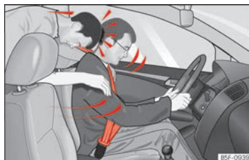
Abb. 19 Der nicht angegurte Mitfahrer auf dem Rücksitz wird nach vorn auf den angegurten Fahrer geschleudert.
