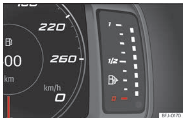
Abb. 4 Kombi-Instrument SEAT Digital Cockpit: Kraftstoffvorratsanzeige.
