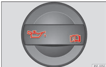
Abb. 215 Deckel der Motoröl-Einfüllöffnung im Motorraum.
