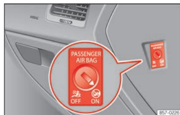
Abb. 26 Schlüsselschalter zum Ein- und Abschalten des Beifahrerairbags.
