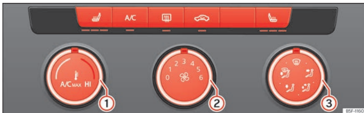
Abb. 90 In der Mittelkonsole: Bedienelemente der manuellen Klimaanlage.
