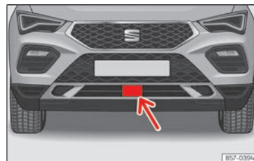
Abb. 105 Im vorderen Stoßfänger: Radarsensor.
