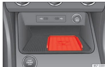
Abb. 166 In der Mittelkonsole: Aufnahme für die Mobiltelefonkopplung.
