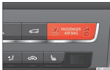
Abb. 27 Schalttafel: Kontrollleuchte für abgeschalteten Beifahrerairbag.
