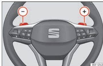
Abb. 100 Lenkrad: die Hebel für Automatikgetriebe.
