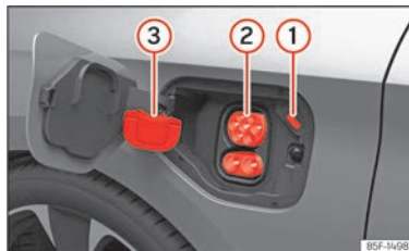
Abb. 60 Hinter der Batterieladeklappe hinten rechts: Ladedose.
