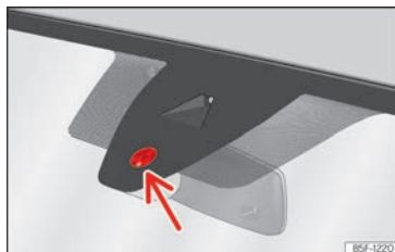
Abb. 110 Sensitive Fläche des Regensensors.
