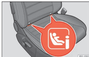
Abb. 41 Beifahrersitz: Einbauort der Halteösen i-Size.
