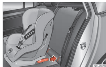
Abb. 42 Rücksitz: Einbau des Kindersitzes mit dem ISOFIX-System.
