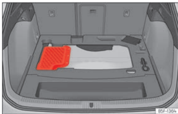
Abb. 241 Plug-in-Hybridfahrzeuge (PHEV): Einbauort der Batterie im Gepäckraum.
