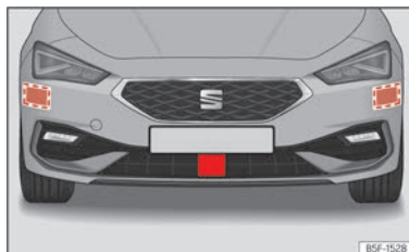
Abb. 127 Im vorderen Stoßfänger: Radarsensoren vorn und seitlich.
