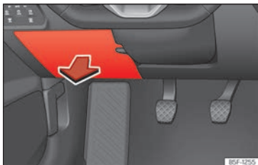
Abb. 226 Auf der Fahrerseite in der Schalttafel: Abdeckung des Sicherungskastens.
