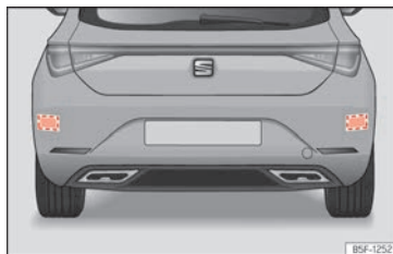
Abb. 130 Bereich hinter dem Fahrzeug: Bereiche der Radarsensoren.
