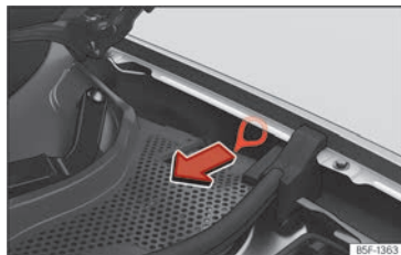
Abb. 63 Zwischen dem linken Kotflügel und dem Scharnier der Frontklappe: Ziehgriff für manuelle Notentriegelung des Ladesteckers.
