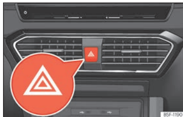
Abb. 48 Schalttafel: Schalter für die Warnblinkanlage
