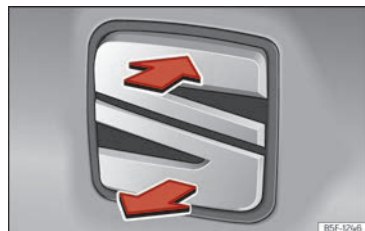
Abb. 80 Heckklappe: Öffnen von außen
