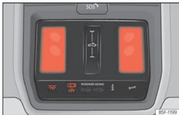
Abb. 106 Ausschnitt aus Dachhimmel: Innenbeleuchtung vorn.
