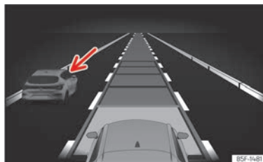
Abb. 138 Am Bildschirm des Kombi-Instruments: ACC aktiv, Fahrzeug auf der linken Seite erkannt.
