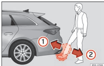
Abb. 83 Heckklappe mit sensorgesteuerter Öffnung (Easy Open).
