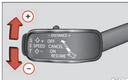
**Abb. 201** Auf der linken Seite der Lenksäule: dritter Hebel für die Betätigung der automatischen Distanzregelung.
