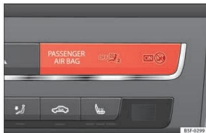
Abb. 95 Kontrolllampchen für Abschaltung des und Beifahrerairbags.
