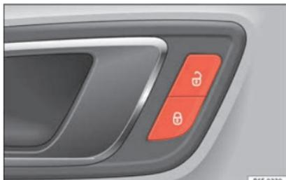
Abb. 2 Fahrertür: Taste Zentralverriegelung.
