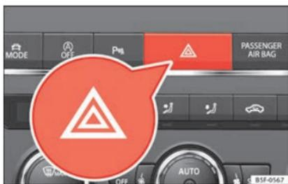
Abb. 37 Instrumententafel: Schalter für die Warnblinkanlage
