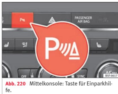
Abb. 220 Mittelkonsole: Taste für Einparkhilfe.
