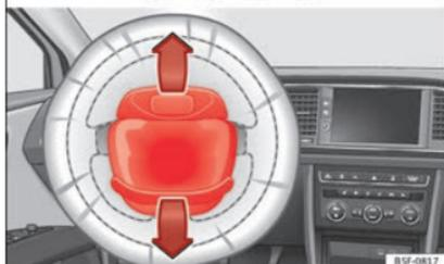
Abb. 20 Einbauort Fahrerairbag: im Lenkrad.
