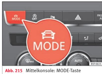
Abb. 215 Mittelkonsole: MODE-Taste
