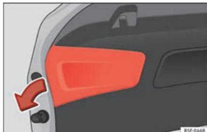
**Abb. 115** Abdeckung der Gepäckraumklappe entfernen
