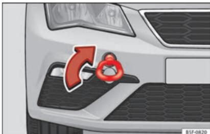
**Abb. 97** Vorderer Stoßfänger rechts: Eingeschraubte Abschleppöse
