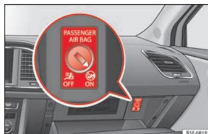
Abb. 22 Schalter für Beifahrer-Frontairbag.
