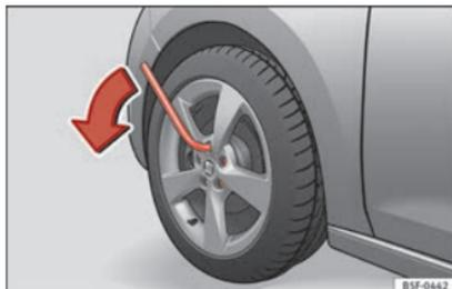
**Abb. 72** Rad: Radschrauben lockern.
