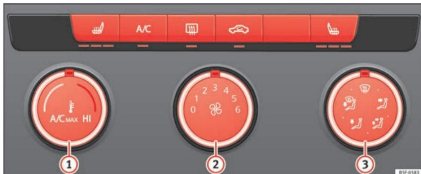
**Abb. 56** In der Mittelkonsole: Bedienelemente der manuellen Klimaanlage.
