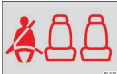
**Abb. 87** Kombi-Instrument: Anzeige, dass der Platz hinten rechts besetzt und der entsprechende Sicherheitsgurt angelegt ist.
