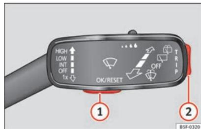
**Abb. 42** Scheibenwischerhebel: Steuertasten.
