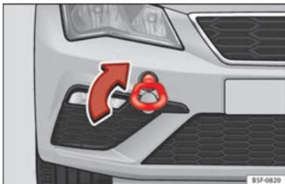
**Abb. 75** Vorderer Stoßfänger rechts: Eingeschraubte Abschleppöse
