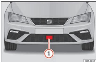
**Abb. 199** Im vorderen Stoßfänger: Radarsensor.
