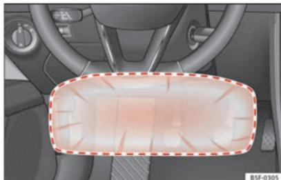
**Abb. 24** Auf der Fahrerseite: Wirkungsbereich des Knieairbags.
