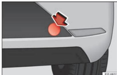
**Abb. 98** Hinterer Stoßfänger rechts: Abdeckkappe-Deckel.
