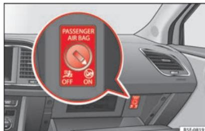
Abb. 94 Schalter für Beifahrer-Frontairbag.
