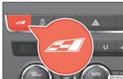
**Abb. 216** Mittelkonsole: Taste Cupra Drive Profile
