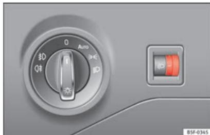
Abb. 140 Neben dem Lenkrad: Regler für die Leuchtweitenregulierung.
