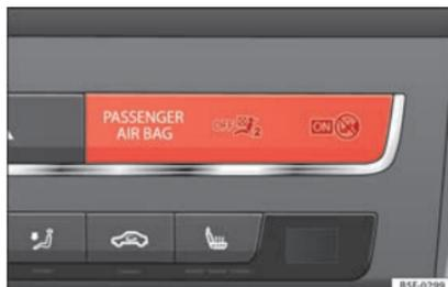
**Abb. 93** Kontrollleuchte in der Instrumententafel für abgeschalteten Beifahrer-Frontairbag.
