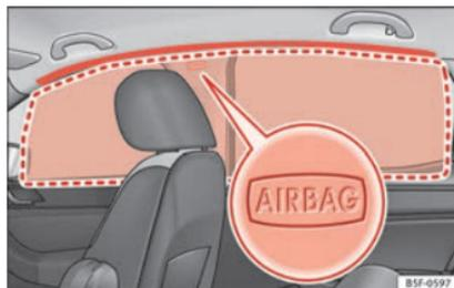
Abb. 27 Einbauort der Kopfairbags
