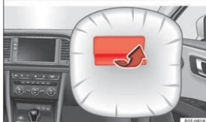
Abb. 21 Beifahrerairbag in der Instrumententafel
