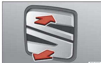
**Abb. 5** Heckklappe: Öffnen von außen
