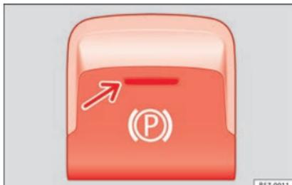
**Abb. 188** Im unteren Bereich der Mittelkonsole: Taste für die elektronische Parkbremse.
