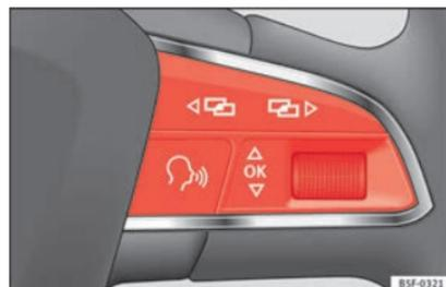
**Abb. 43** Rechte Seite Multifunktions-Lenkrad: Steuertasten.
