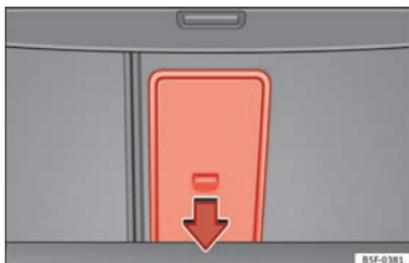
**Abb. 172** Im Gepäckraum: Öffnung der Durchladeeinrichtung.
