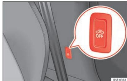
**Abb. 135** Taste für Innenraum-/Abschleppschutzüberwachung
