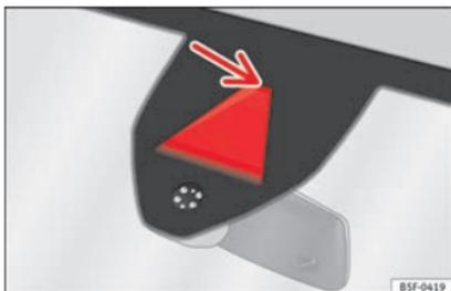
Abb. 214 Kamerasichtfenster des Spurhalteassistenten.
