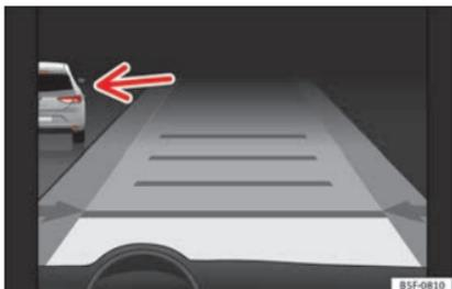
**Abb. 204** Im Display des Kombiinstrumentes: ACC aktiv, Fahrzeug auf der linken Seite erkannt
