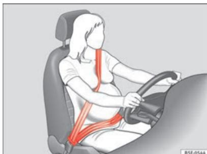
**Abb. 92** Gurtbandverlauf bei schwangeren Frauen.
