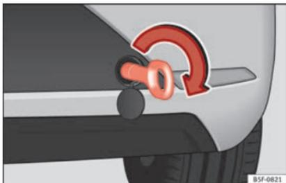
**Abb. 76** Hinterer Stoßfänger rechts: Eingeschraubte Abschleppöse
