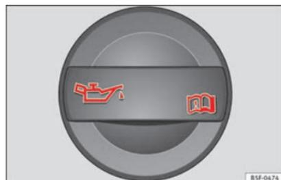
**Abb. 60** Deckel der Motoröl-Einflüllöffnung im Motorraum
