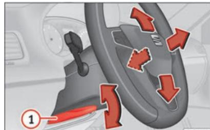
**Abb. 19** Hebel auf der linken unteren Seite der Lenksäule.
