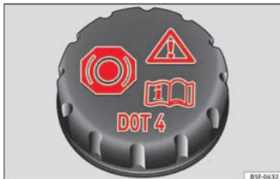
**Abb. 62** Motorraum: Deckel des Bremsflüssigkeitsbehälters
