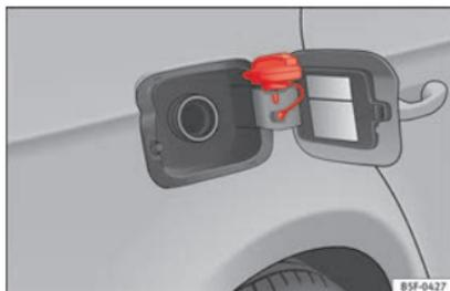
**Abb. 58** Tankklappe mit aufgestecktem Tankverschluss.
