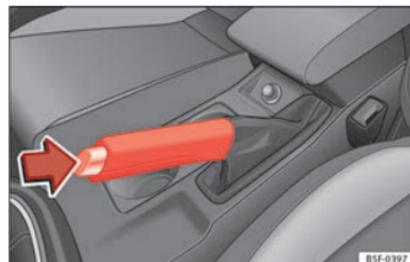
**Abb. 189** Handbremse zwischen den Vordersitzen.
