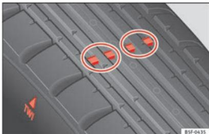
Abb. 244 Reifenprofil: Verschleißanzeiger.
