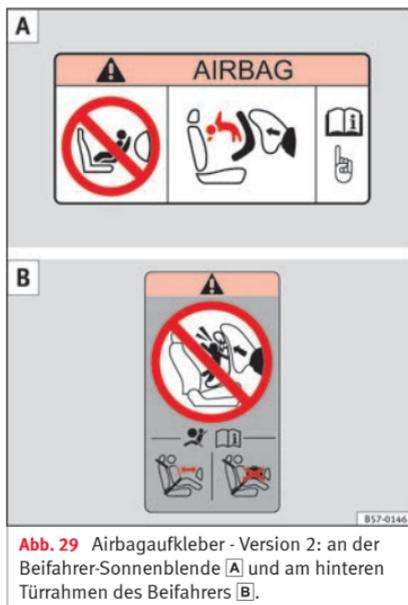
Auf der Sonnenblende und/oder dem hinteren Türrahmen der Beifahrerseite ist ein Aufkleber mit wichtiger Information zum Beifahrer-Airbag angebracht.
