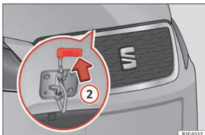
Abb. 9 Hebel unter der Motorraumklappe.
