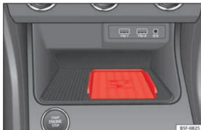
**Abb. 127** Mittelkonsole: Connectivity Box
