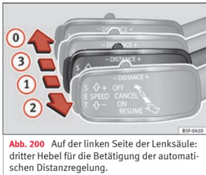
**Abb. 200** Auf der linken Seite der Lenksäule: dritter Hebel für die Betätigung der automatischen Distanzregelung.
