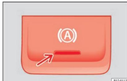
**Abb. 195** Im unteren Bereich der Mittelkonsole: Funktionstaste Auto-Hold.
