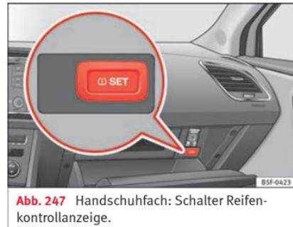
Abb. 247 Handschuhfach: Schalter Reifenkontrollanzeige.
