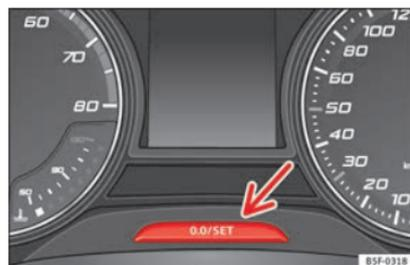
**Abb. 121** Kombi-Instrument: Kilometerzähler und Rückstelltaste.
