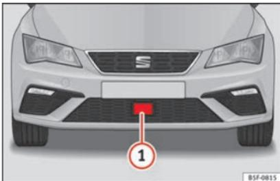
**Abb. 208** Im vorderen Stoßfänger: Radarsensor.
