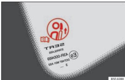
Abb. 86 Warnschild für Kopfstützenstellung
