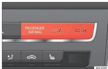
**Abb. 51** Kontrolllampchen für Abschaltung des und Beifahrerairbags.
