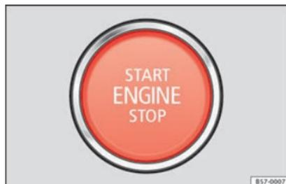
**Abb. 187** Im unteren Bereich der Mittelkonsole: Starterknopf.
