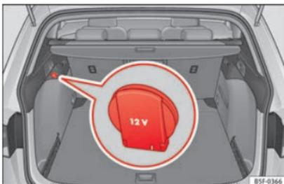
Abb. 158 Detail an der Seiteninnenverkleidung des Kofferraums: Steckdose 12 V (gilt nur für das Modell LEON ST).
