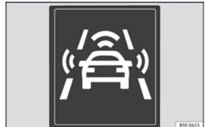
**Abb. 210** Im Display des Kombiinstrumentes: Anzeige der Vorwarnung.
