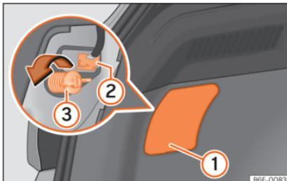
**Abb. 57** Gepäckraum: Zugang zur Befestigungsschraube der Heckleuchte.
