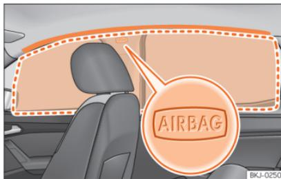
**Abb. 20** Einbauort und Entfaltungsbereich des Kopfairbags.
