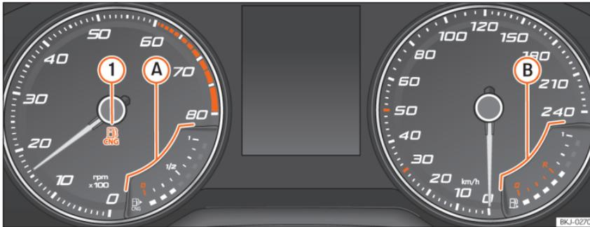
**Abb. 71** Analoges Kombi-Instrument: Erdgasvorratsanzeige
