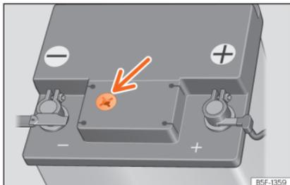
**Abb. 205** Sichtfenster an der Oberseite der 12-Volt-Fahrzeugbatterie (Prinzipdarstellung).
