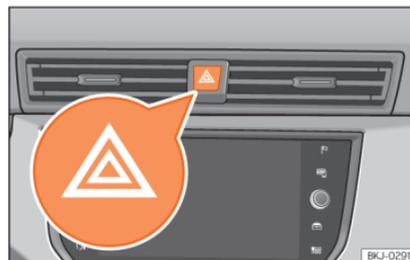
**Abb. 100** Instrumententafel: Schalter für Warnblinkanlage.
