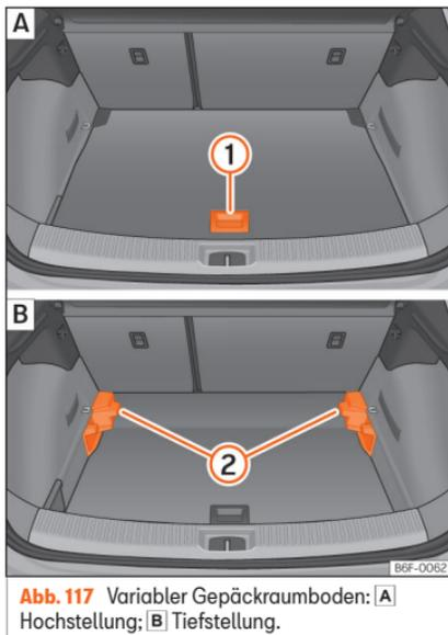
**Abb. 117** Variabler Gepäckraumboden: **A** Hochstellung; **B** Tiefstellung.
