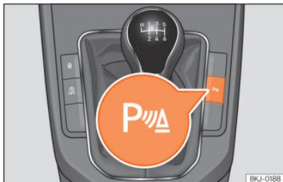
**Abb. 176** Mittelkonsole: Taste für Einparkhilfe (je nach Ausführung).
