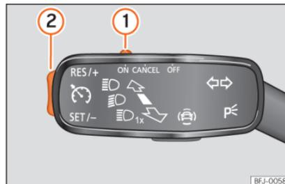
**Abb. 151** Am Blinkerhebel: Bedienelemente zur Bedienung der GRA.
