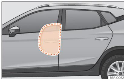
**Abb. 19** Komplettaufgeblasener Seitenairbag auf der linken Fahrzeugseite.
