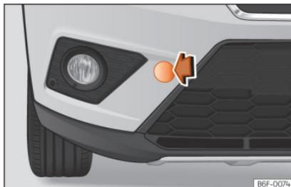
**Abb. 44** Stoßfänger vorn rechts: Abdeckung entfernen.
