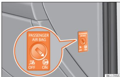
**Abb. 16** Schlüsselschalter zum Ein- und Abschalten des Beifahrerairbags.
