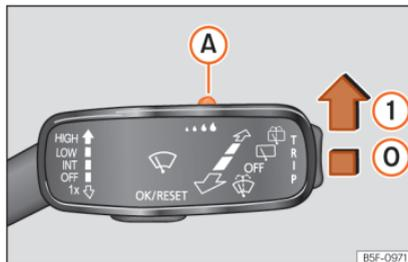
**Abb. 104** Scheibenwischerhebel: Regensensor einstellen (A).
