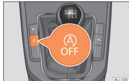
**Abb. 138** Mittelkonsole: Taste des Start-Stopp-Systems.
