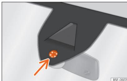
**Abb. 105** Sensitive Fläche des Regensensors.
