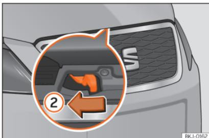
**Abb. 197** Hebel unter der Motorraumklappe.
