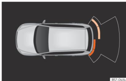
**Abb. 179** Anzeige der Parkhilfe auf dem Bildschirm des Easy Connect Systems.
