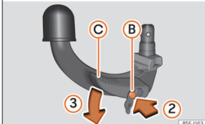
**Abb. 183** Ruheposition der Anhängerkupplung
