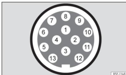
**Abb. 181** Schematische Darstellung: Zuweisung der Steckverbinderstifte für Anhängerstrom.
