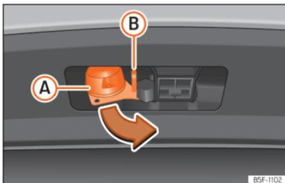
**Abb. 190** 13-polige Steckverbindung drehen
