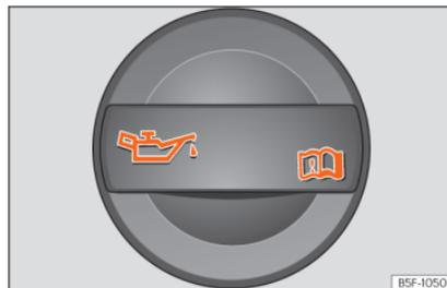
Abb. 200 Deckel der Motoröl-Einfüllöffnung im Motorraum
