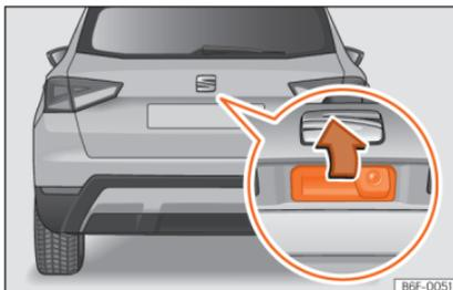
**Abb. 94** Heckklappe: Haltegriff
