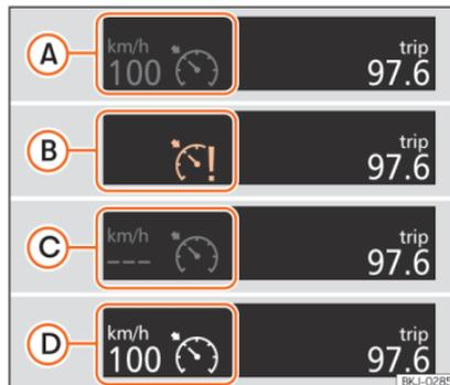
**Abb. 150** Bildschirm des Kombi-Instruments: Zustandsanzeigen der GRA.
