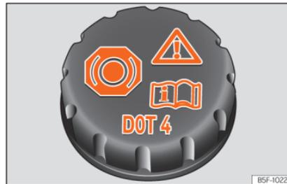
**Abb. 203** Motorraum: Deckel des Bremsflüssigkeitsbehälters.
