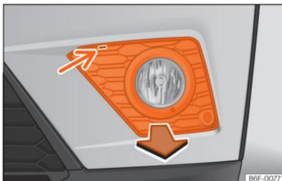
**Abb. 55** Nebelscheinwerfer: Gitter herausziehen
