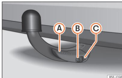
Abb. 187 Anhängerkupplung ordnungsgemäß befestigt
