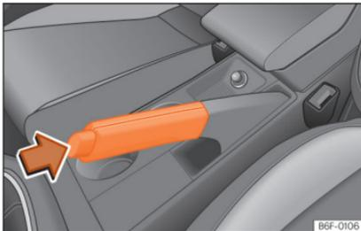
**Abb. 168** Handbremse zwischen den Vordersitzen.
