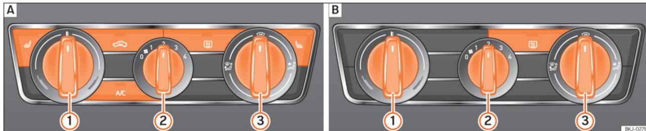
Abb. 127 In der Mittelkonsole: **A** Bedienungselemente der manuellen Klimaanlage; **B** Bedienungselemente des Heiz- und Frischluftsystems.
