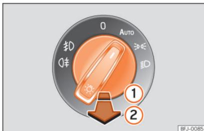
Abb. 98 Instrumententafel: Lichtschalter.
