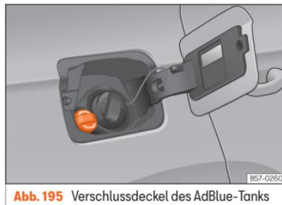
**Abb. 195** Verschlussdeckel des AdBlue-Tanks
