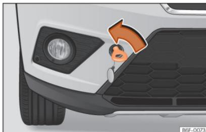
**Abb. 45** Stoßfänger vorn rechts: eingeschraubte Abschleppöse.
