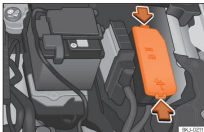
**Abb. 49** Im Motorraum: Abdeckung des Sicherungskastens.
