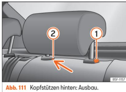
**Abb. 111** Kopfstützen hinten: Ausbau.
