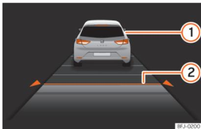
**Abb. 160** Am Bildschirm des Kombi-Instruments: ACC aktiv.
