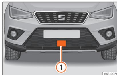
**Abb. 145** Am vorderen Stoßfänger: Radarsensor.
