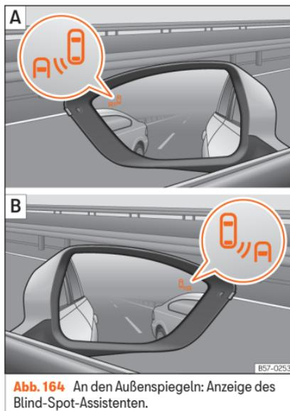
**Abb. 164** An den Außenspiegeln: Anzeige des Blind-Spot-Assistenten.
