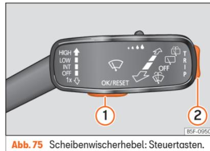
**Abb. 75** Scheibenwischerhebel: Steuertasten.
