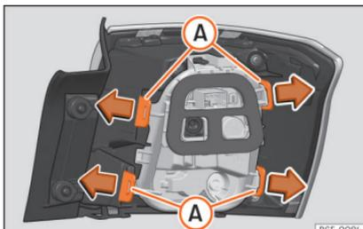
**Abb. 58** Befestigungslaschen Rückseite Heckleuchte.
