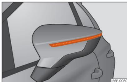
**Abb. 61** Blinker im Rückspiegel integriert
