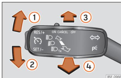
Abb. 99 Blinker- und Fernlichthebel.
