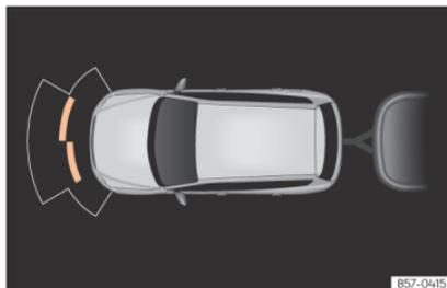
**Abb. 178** Bildschirmanzeige der Einparkhilfe im Anhängerbetrieb.
