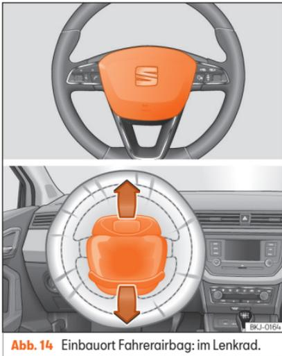
Abb. 14 Einbauort Fahrerairbag: im Lenkrad.
