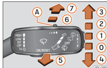
**Abb. 103** Bedienung von Windschutz- und Heckscheibenwischer
