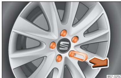
**Abb. 33** Rad: Radschrauben mit Deckel.
