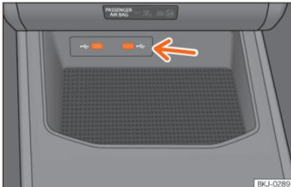
**Abb. 134** Mittelkonsole: USB-Eingang.
