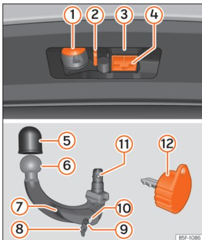
**Abb. 182** Halterung der Anhängervorrichtung / Anhängerkupplung / Schlüssel
