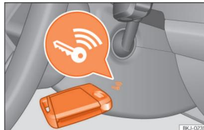
**Abb. 137** Rechts an der Lenksäule: Notstart.
