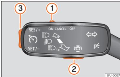
**Abb. 154** Am Blinkerhebel: Tasten zur Bedienung des Geschwindigkeitsbegrenzers.
