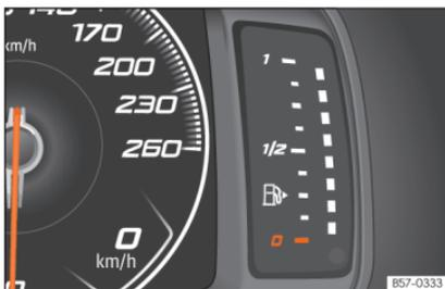
**Abb. 70** Frei konfigurierbares Kombiinstrument: Kraftstoffvorratsanzeige
