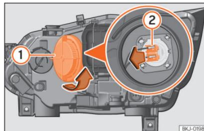
**Abb. 51** Im Motorraum: Glühlampe Fernlicht.
