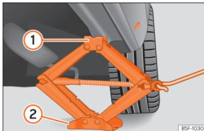
**Abb. 38** Längsholm: Wagenheber ansetzen.
