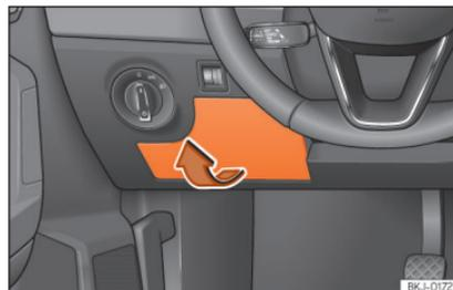
**Abb. 48** Auf der Fahrerseite in der Instrumententafel: Abdeckung des Sicherungskastens.
