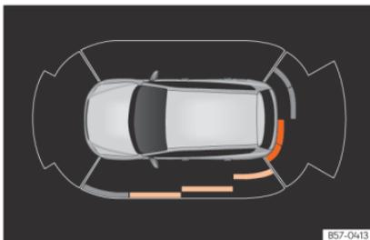
**Abb. 177** Anzeige der Parkhilfe auf dem Bildschirm des Easy Connect Systems.
