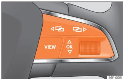
**Abb. 74** Rechte Seite des Multifunktionslenkrads: Bedienelemente für die Menüs und Informationsanzeigen im Kombi-Instrument.
