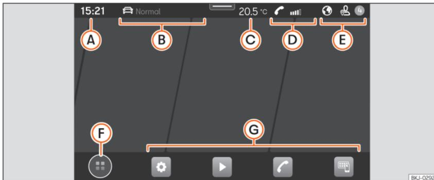
**Abb. 76** Schematische Darstellung: Übersicht möglicher Funktionsflächen am Bildschirm
