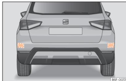
**Abb. 147** Heckansicht des Fahrzeugs: Bereiche der Radarsensoren.
