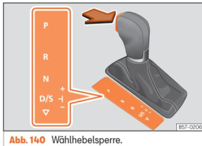
Abb. 140 Wählhebelsperre.
