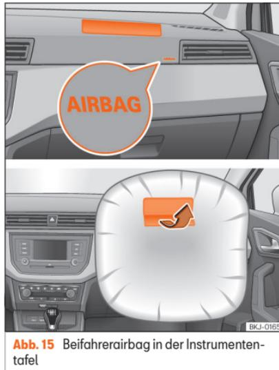
Abb. 15 Beifahrerairbag in der Instrumententafel
