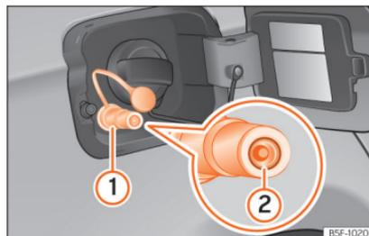
**Abb. 193** Geöffnete Tankklappe: Gas-Einfüllstutzen ①, Dichting des Einfüllstutzens ②.
