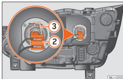
**Abb. 53** Im Motorraum: Glühlampe Abblendlicht.
