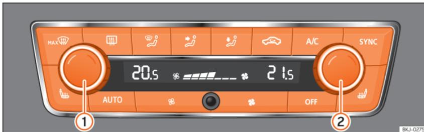
**Abb. 126** In der Mittelkonsole: Bedienungselemente der Climatronic.
