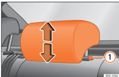
**Abb. 110** Kopfstützen hinten: Kopfstützeinstellung.
