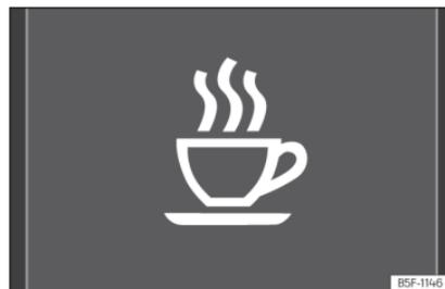
**Abb. 68** Am Bildschirm des Kombi-Instruments: Symbol für Müdigkeitserkennung.
