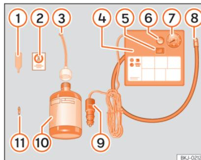
**Abb. 31** Prinzipdarstellung: Bestandteile des Pannensets.
