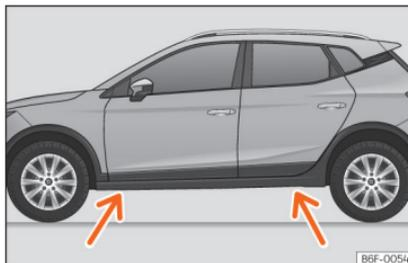
**Abb. 37** Aufnahmepunkte für den Wagenheber.
