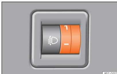
**Abb. 101** Neben dem Lenkrad: Regler für die Leuchtweitenregulierung.
