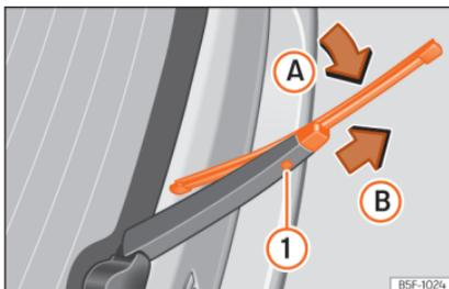
**Abb. 41** Scheibenwischerblatt der Heckscheibe auswechseln.
