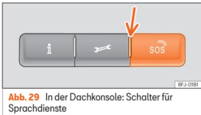
**Abb. 29** In der Dachkonsole: Schalter für Sprachdienste
