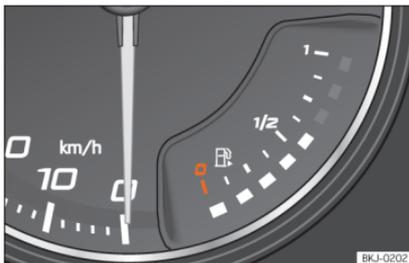
**Abb. 69** Analoges Kombi-Instrument: Kraftstoffvorratsanzeige
