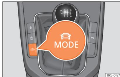
**Abb. 144** Neben dem Schalthebel.: Taste **MODE**.
