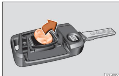
**Abb. 85** Fahrzeugschlüssel: Batterie herausnehmen.
