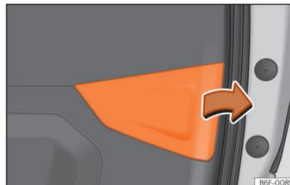
**Abb. 59** Offene Heckklappe: Abdeckung entfernen.
