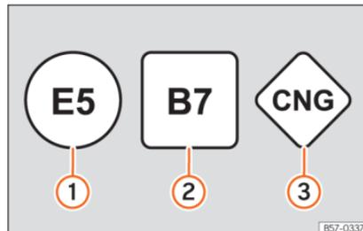
**Abb. 194** Kraftstoffkennzeichnung nach EU-Richtlinie 2014/94/EU
