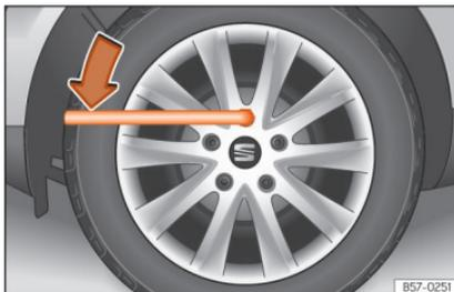
**Abb. 35** Radwechsel: Radschrauben lockern.
