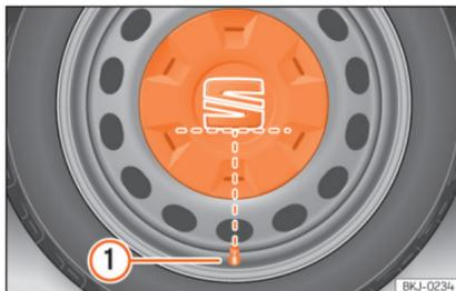
**Abb. 32** Korrekte Anbringung der Radvollblende für Stahlfelgen.
