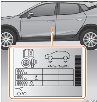
**Abb. 206** Einbauport des Aufklebers für den Reifendruck.
