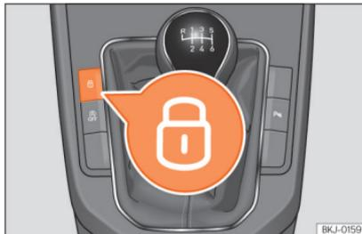
**Abb. 87** Mittelkonsole: Zentralverriegelungsschalter.
