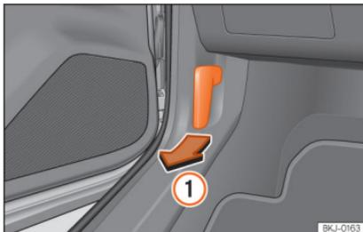
**Abb. 196** Entriegelungshebel im Fahrerfußraum.
