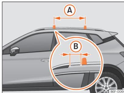
**Abb. 120** Befestigungspunkte der Längsträger für den Dachgepäckträger.
