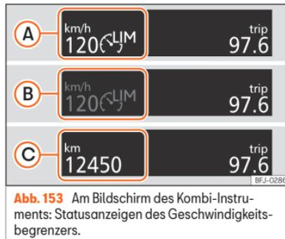
**Abb. 153** Am Bildschirm des Kombi-Instruments: Statusanzeigen des Geschwindigkeitsbegrenzers.
