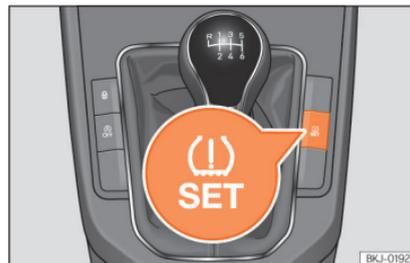
Abb. 209 Mittelkonsole: Taste für die Reifendruckkontrollanzeige.
