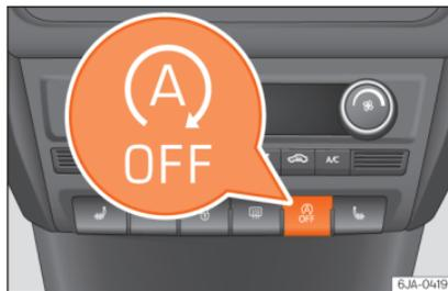
**Abb. 221** Kombiinstrument: Taste für Start-Stopp-System.
