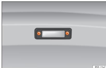
**Abb. 107** Ausbau der Kennzeichenleuchte
