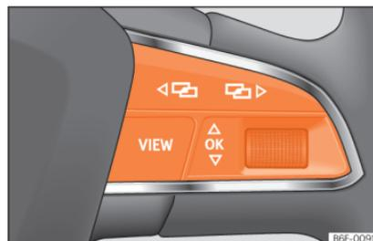
**Abb. 39** Rechte Seite Multifunktions-Lenkrad: Steuertasten.
