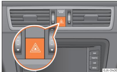
**Abb. 32** Instrumententafel: Schalter für die Warnblinkanlage
