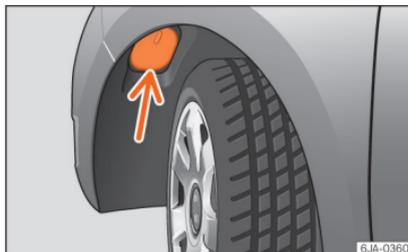
**Abb. 92** Lampe für Abblendlicht wechseln: Radkasten
