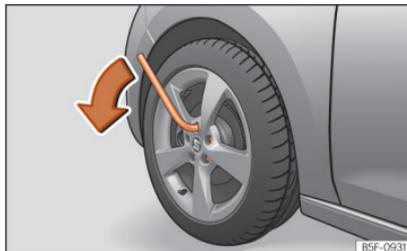
**Abb. 63** Radwechsel: Radschrauben lockern
