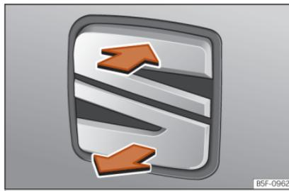
**Abb. 7** Heckklappe: Öffnen von außen
