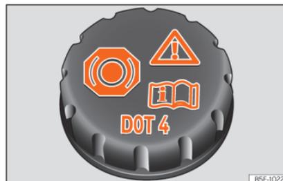
**Abb. 53** Motorraum: Deckel des Bremsflüssigkeitsbehälters
