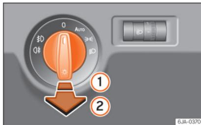
Abb. 132 Kombiinstrument: Lichtschalter
