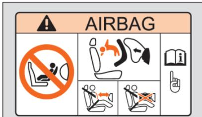
Abb. 25 Sonnenblende auf der Beifahrerseite: Airbagaufkleber.
