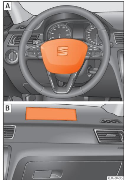
**Abb. 18** Fahrerairbag im Lenkrad und Beifahrerairbag in der Instrumententafel
