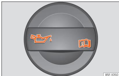
Abb. 51 Deckel der Motoröl-Einfüllöffnung im Motorraum
