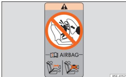
Abb. 26 Im hinteren Rahmen der Beifahrertür: Aufkleber mit Angaben zum Airbag.
