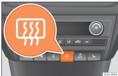
Abb. 137 Schalter für Heckscheibenheizung
