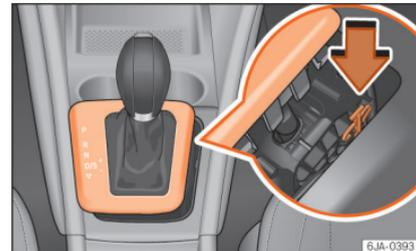
Abb. 45 Notentriegeln der Wählhebelsperre
