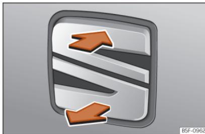
**Abb. 126** Heckklappe: Öffnen von außen
