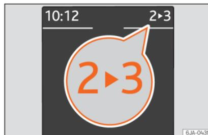
**Abb. 219** Kombi-Instrument: Ganganzeige (Handgetriebe).
