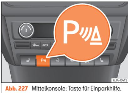
Abb. 227 Mittelkonsole: Taste für Einparkhilfe.
