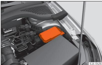
**Abb. 56** Im Motorraum: Abdeckung des Sicherungskastens.
