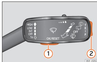
**Abb. 38** Scheibenwischerhebel: Steuertasten.
