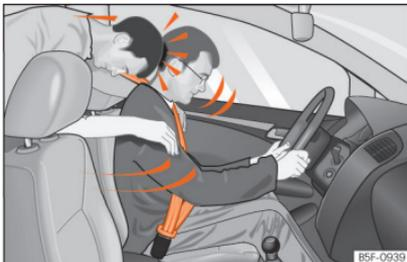
**Abb. 78** Der nicht angegurte Mitfahrer auf dem Rücksitz wird nach vorne auf den angegurten Fahrer geschleudert.
