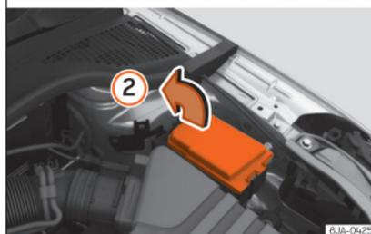
**Abb. 88** Im Motorraum: Abdeckung des Sicherungskastens - Variante 2
