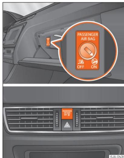
**Abb. 82** Schalter für Beifahrer-Frontairbag/Kontrollleuchte für Abschaltung des Beifahrerairbags
