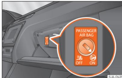
**Abb. 20** Schalter für Beifahrer-Frontairbag.
