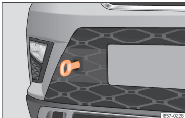
Abb. 80 Vorderer Stoßfänger rechts: Eingeschraubte Abschleppöse
