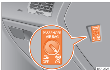
Abb. 98 Schlüsselschalter zum Ein- und Abschalten des Beifahrerairbags.
