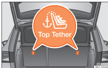
Abb. 40 Lage der Top Tether-Ösen im hinteren Teil des Rücksitzes
