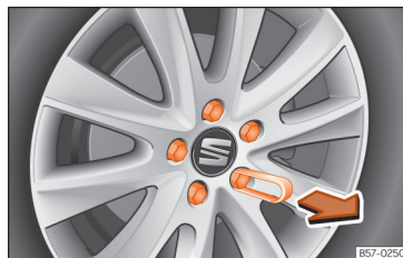
Abb. 75 Rad: Radschrauben mit Deckel.
