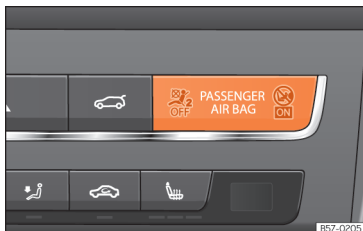
Abb. 99 Instrumententafel: Kontrollleuchte für abgeschalteten Beifahrerairbag.
