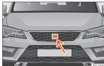
Abb. 260 Im Frontbereich hinter dem SEAT-Emblem: Radarsensor.
