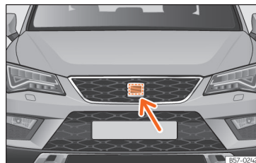
Abb. 255 Im Frontbereich hinter dem SEAT-Emblem: Radarsensor.
