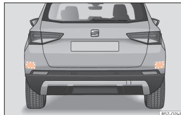
Abb. 272 Bereich hinter dem Fahrzeug: Bereiche der Radarsensoren.
