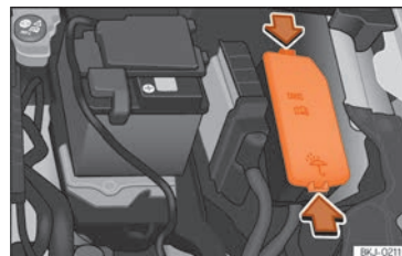
Abb. 162 Im Motorraum: Abdeckung des Sicherungskastens.
