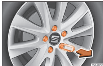
Abb. 188 Rad: Radschrauben mit Deckel.
