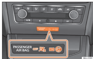
Abb. 30 Instrumententafel-Mittelteil: Kontrollleuchte für abgeschalteten Beifahrer-Frontairbag.
