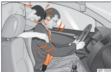
Abb. 22 Der nicht angegurte Mitfahrer auf dem Rücksitz wird nach vorn auf den angegurten Fahrer geschleudert.
