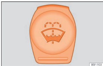
Abb. 176 Im Motorraum: Blauer Deckel des Scheibenwaschbehälters.
