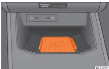
Abb. 138 In der Mittelkonsole: Aufnahme für die Mobiltelefonkopplung.
