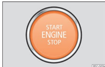
Abb. 85 Im unteren Bereich der Mittelkonsole: Starterknopf.
