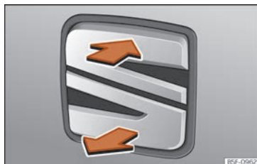
Abb. 57 Heckklappe: Öffnen von außen
