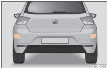
Abb. 99 Bereich hinter dem Fahrzeug: Bereiche der Radarsensoren.
