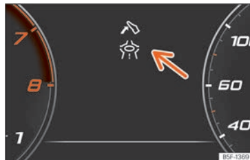
Abb. 104 Anzeige des Assistenten für eine ökologische Fahrweise (schematische Darstellung).
