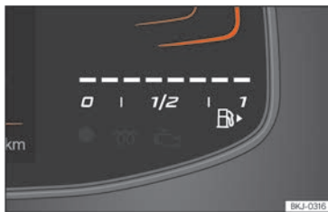
Abb. 5 Kombi-Instrument Basic: Kraftstoffvorratsanzeige.
