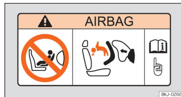
Abb. 35 Airbag-Label: an der Sonnenblende Beifahrerseite.
