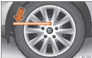
Abb. 190 Radwechsel: Radschrauben lockern
