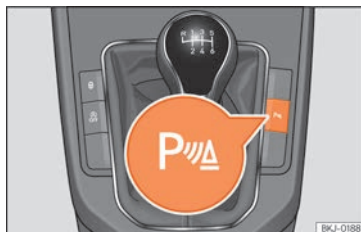
Abb. 123 Mittelkonsole: Taste für Einparkhilfe (je nach Ausführung).
