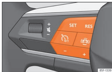
Abb. 102 Am Multifunktionslenkrad: Tasten zur Bedienung der Geschwindigkeitsregelanlage.
