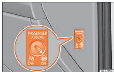
Abb. 29 Schlüsselschalter zum Ein- und Abschalten des Beifahrerairbags.
