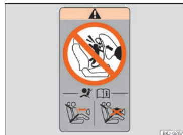
Abb. 36 Airbag-Label: am hinteren Rahmen der Beifahrertür.
