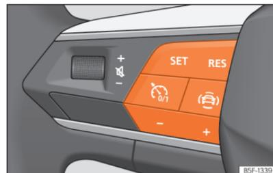
**Abb. 103** Am Multifunktionslenkrad: Tasten zur Bedienung der Geschwindigkeitsregelanlage.
