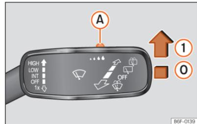
**Abb. 78** Scheibenwischerhebel: Regensensor (A) einstellen.
