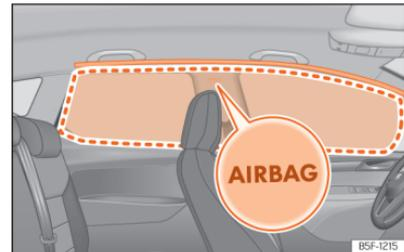
**Abb. 34** Einbauort und Entfaltungsbereich des Kopfairbags.
