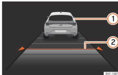
**Abb. 105** Am Bildschirm des Kombi-Instruments: ACC aktiv.
