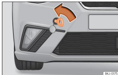
**Abb. 157** Vorderer Stoßänger rechts: Eingeschraubte Abschleppöse
