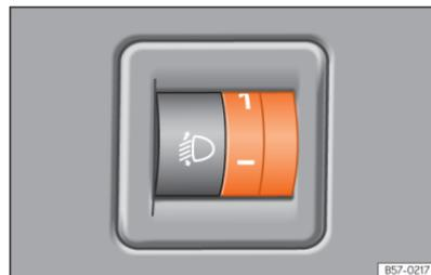
**Abb. 75** Neben dem Lenkrad: Regler für die Leuchtweitenregulierung.
