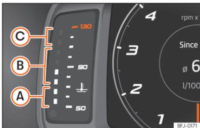
**Abb. 9** Digitales Kombi-Instrument SEAT Digital Cockpit: Motorkühlmitteltemperatur-Anzeige.
