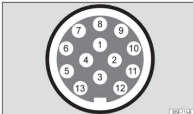
**Abb. 143** Schematische Darstellung: Zuweisung der Steckverbinderstifte für Anhängerstrom.
