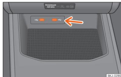
**Abb. 129** Mittelkonsole: USB-Eingang.
