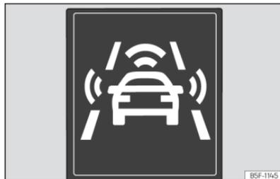
**Abb. 110** Im Display des Kombi-Instruments: Vorwarnhinweise.
