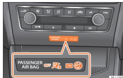
**Abb. 31** Instrumententafel-Mittelteil: Kontrollleuchte für abgeschalteten Beifahrer-Frontairbag.
