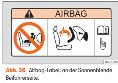
**Abb. 36** Airbag-Label: an der Sonnenblende Beifahrerseite.
