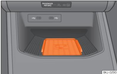
**Abb. 136** In der Mittelkonsole: Aufnahme für die Mobiltelefonkopplung.
