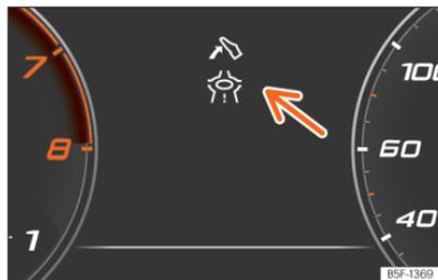
**Abb. 12** Anzeige des Assistenten für eine ökologische Fahrweise (schematische Darstellung).
