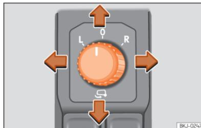
**Abb. 81** Ausschnitt der Fahrertür: Außenspiegelbedienung.
