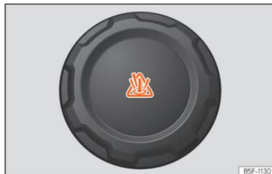
**Abb. 173** Frontraum: Verschlussdeckel des Kühlmittelausgleichsbehälters.
