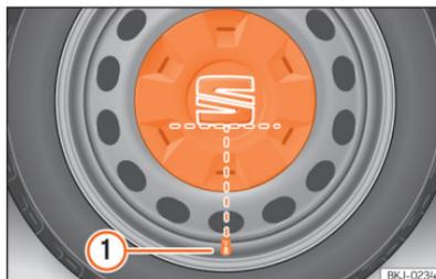
**Abb. 185** Korrekte Anbringung der Radvollblende für Stahlfelgen.
