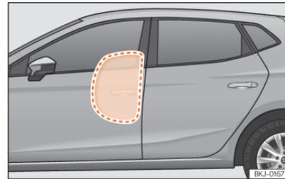
**Abb. 33** Komplettaufgeblasener Seitenairbag auf der linken Fahrzeugseite.
