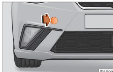
**Abb. 156** Auf der rechten Seite des vorderen Stoßängers: Abdeckung entfernen.
