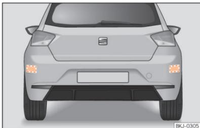
**Abb. 100** Bereich hinter dem Fahrzeug: Bereiche der Radarsensoren.
