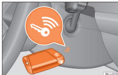
Abb. 87 Rechts an der Lenksäule: Notstart.
