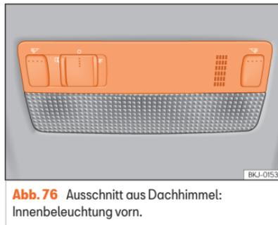
**Abb. 76** Ausschnitt aus Dachhimmel: Innenbeleuchtung vorn.
