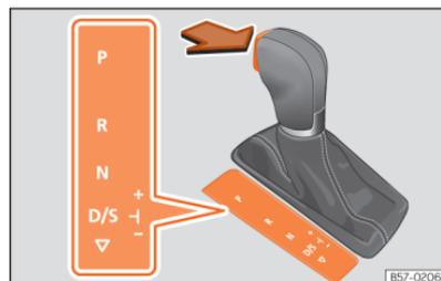
Abb. 90 Wählhebelsperre.
