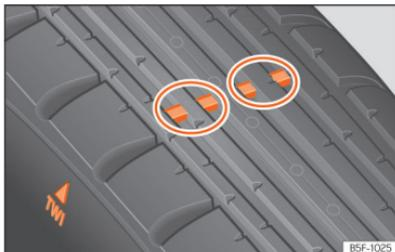
**Abb. 182** Reifenprofil: Verschleißanzeiger.
