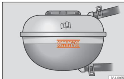
**Abb. 172** Im Frontraum: Markierung am Kühlmittelausgleichsbehälter.
