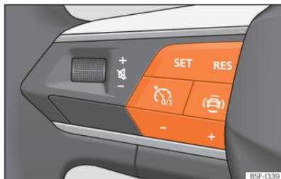
**Abb. 104** Am Multifunktionslenkrad: Tasten zur Bedienung des Geschwindigkeitsbegrenzers.
