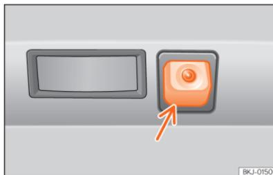
**Abb. 102** Im Stoßfänger hinten: Einbaulage der Rückfahrkamera.
