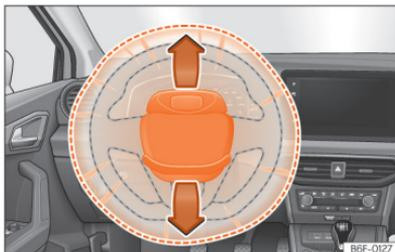
**Abb. 28** Einbaulage Fahrerairbag: im Lenkrad.
