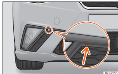
**Abb. 165** Nebelscheinwerfer: Gitter abnehmen
