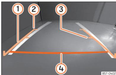
**Abb. 123** Bildschirm des Infotainment-Systems: Orientierungslinien.
