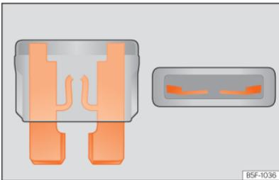
**Abb. 162** Darstellung einer durchgebrannten Sicherung.
