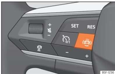
**Abb. 96** Linke Seite des Multifunktionslenkrads: Taste für die Fahrerassistenzsysteme (modellabhängig).
