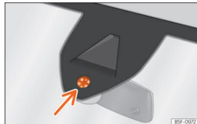
**Abb. 79** Sensitive Fläche des Regensensors.
