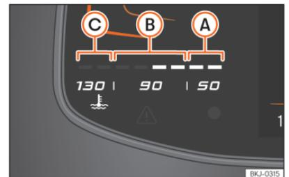
Abb. 8 Digitales Kombi-Instrument Basic: Motorkühlmitteltemperatur-Anzeige.
