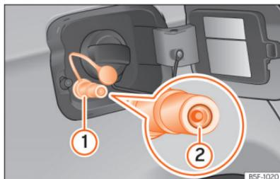
**Abb. 148** Geöffnete Tankklappe: Gas-Einfüllstutzen (1), Dichtring des Einfüllstutzens (2).
