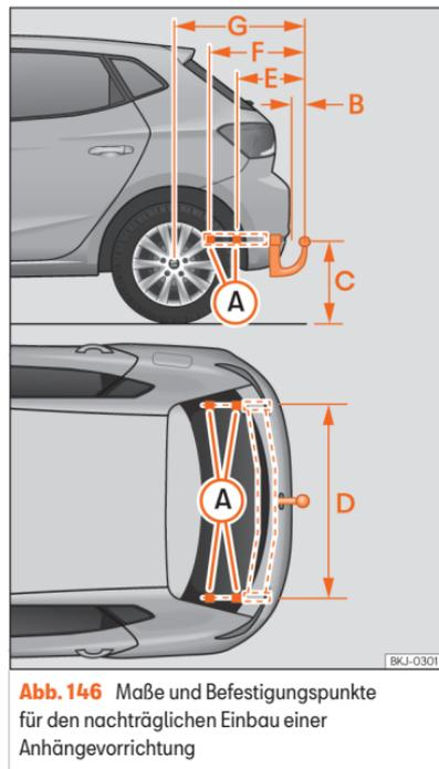
**Abb. 146** Maße und Befestigungspunkte für den nachträglichen Einbau einer Anhängervorrichtung
