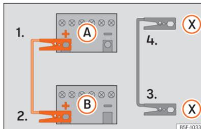
**Abb. 155** Anschlusschema für Fahrzeuge mit Start-Stopp-System.
