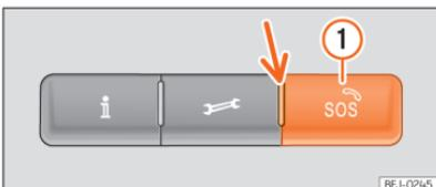
**Abb. 45** In der Dachkonsole: Schalter für Sprachdienste
