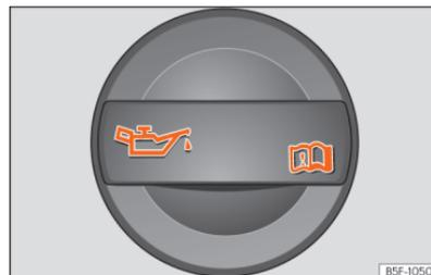
Abb. 179 Deckel der Motoröl-Einfüllöffnung im Motorraum.
