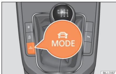
**Abb. 94** Neben dem Schalthebel: Taste MODE.
