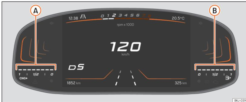
Abb. 7 Kombiinstrument: Erdgasvorratsanzeige
