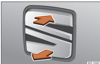
**Abb. 58** Heckklappe: Öffnen von außen
