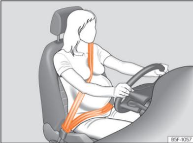
**Abb. 27** Gurtbandverlauf bei schwangeren Frauen.
