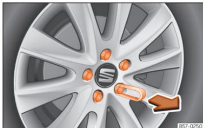
**Abb. 187** Rad: Radschrauben mit Deckel.
