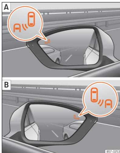
**Abb. 116** Kontrollleuchte des Spurwechselassistenten.
