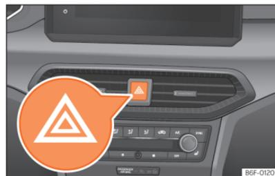
**Abb. 44** Instrumententafel: Schalter für die Warnblinkanlage
