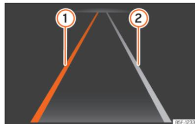
**Abb. 113** Im Display des Kombi-Instruments: Anzeigen des Spurhalteassistenten.
