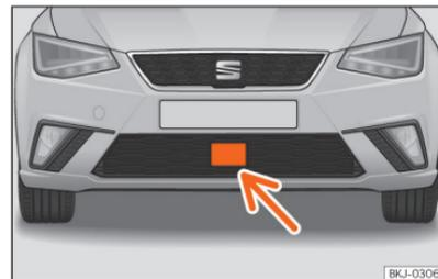
**Abb. 97** Im vorderen Stoßfänger: Radarsensor.
