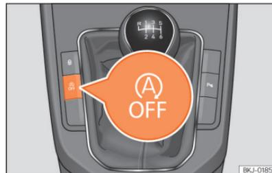
**Abb. 88** Mittelkonsole: Systemtaste Start-Stopp.
