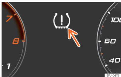
**Abb. 193** Kombi-Instrument: Warnung Reifendruckverlust.
