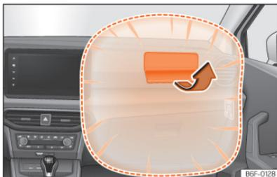
**Abb. 29** Beifahrerairbag in der Instrumententafel
