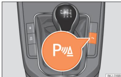
**Abb. 121** Mittelkonsole: Taste für Einparkhilfe (je nach Ausführung).
