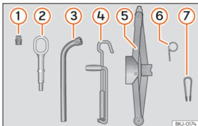
**Abb. 150** Im Gepäckraum unter dem Gepäckraumboden: Bordwerkzeug.
