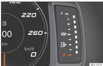
**Abb. 6** Kombi-Instrument SEAT Digital Cockpit: Kraftstoffvorratsanzeige.
