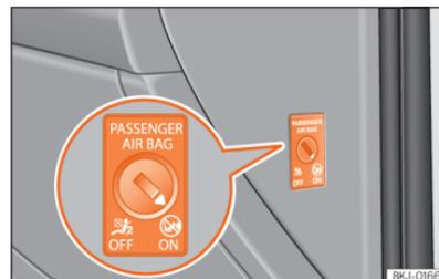
**Abb. 30** Schlüsselschalter zum Ein- und Abschalten des Beifahrerairbags.
