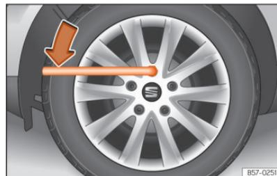
**Abb. 189** Radwechsel: Radschrauben lockern
