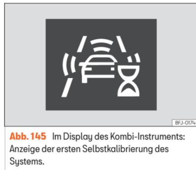
**Abb. 145** Im Display des Kombi-Instruments: Anzeige der ersten Selbstkalibrierung des Systems.
