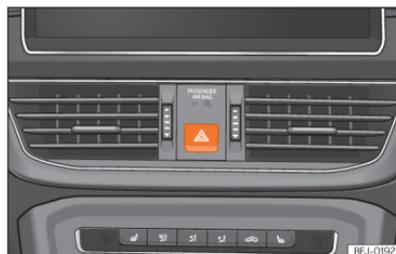
**Abb. 49** Instrumententafel: Schalter für die Warnblinkanlage
