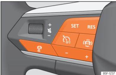
**Abb. 140** Am Multifunktionslenkrad: Tasten zur ACC-Bedienung.
