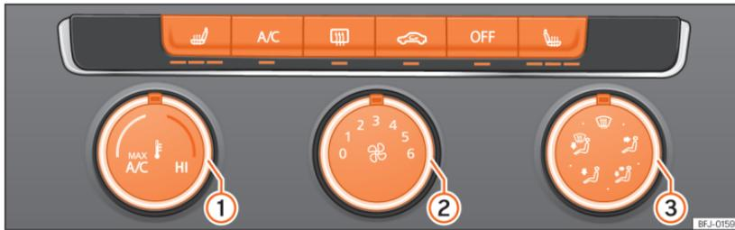
**Abb. 113** In der Mittelkonsole: Bedienelemente der manuellen Klimaanlage.
