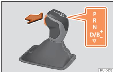
Abb. 124 Wählhebelsperre (Hybridfahrzeuge).
