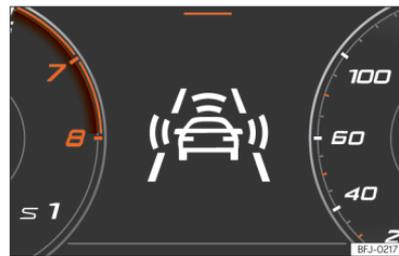
**Abb. 144** Im Display des Kombi-Instruments: Vorwarnhinweise.
