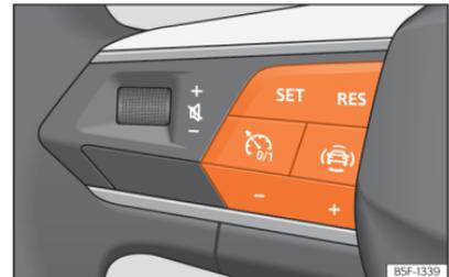
**Abb. 137** Am Multifunktionslenkrad: Tasten zur Bedienung der Geschwindigkeitsregelanlage.
