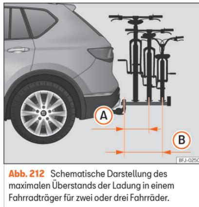
**Abb. 212** Schematische Darstellung des maximalen Überstands der Ladung in einem Fahrradträger für zwei oder drei Fahrräder.
