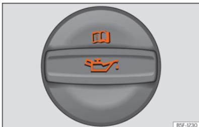
Abb. 242 Deckel der Motoröl-Einfüllöffnung im Motorraum.
