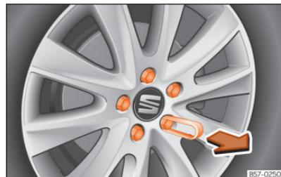
Abb. 250 Rad: Radschrauben mit Deckel.
