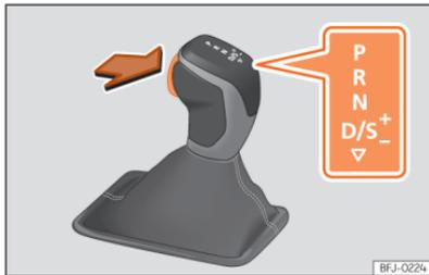
Abb. 123 Wählhebelsperre.
