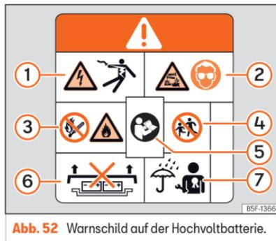
Abb. 52 Warnschild auf der Hochvoltbatterie.
