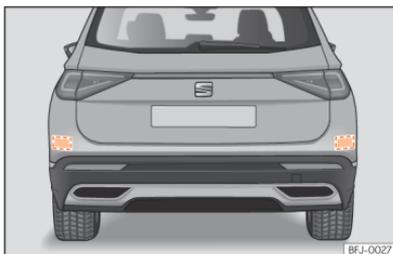
**Abb. 134** Bereich hinter dem Fahrzeug: Bereiche der Radarsensoren.
