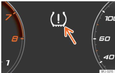
**Abb. 257** Kombi-Instrument: Warnung Reifendruckverlust.
