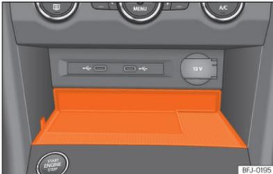
**Abb. 192** In der Mittelkonsole: Aufnahme für die Mobiltelefonkopplung.
