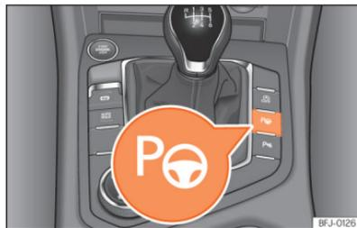
**Abb. 161** In der Mittelkonsole: Taste zum Einschalten des Parklenkassistenten.
