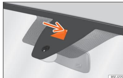
**Abb. 133** Kamerasichtfenster des Spurhalteassistenten.
