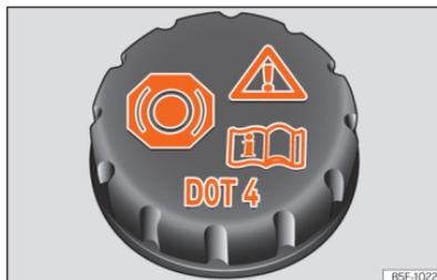
Abb. 237 Motorraum: Deckel des Bremsflüssigkeitsbehälters
