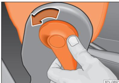
**Abb. 90** Klappbare Beifahrersitzlehne entriegeln.
