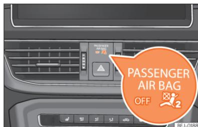
Abb. 33 Instrumententafel: Kontrollleuchte für abgeschalteten Beifahrerairbag.
