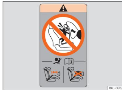
**Abb. 40** Airbag-Label: am hinteren Rahmen der Beifahrertür.
