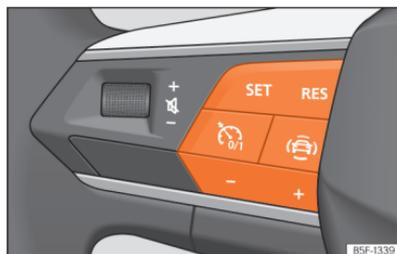
**Abb. 138** Am Multifunktionslenkrad: Tasten zur Bedienung des Geschwindigkeitsbegrenzers.
