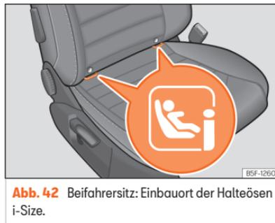
**Abb. 42** Beifahrersitz: Einbauort der Halteösen i-Size.
