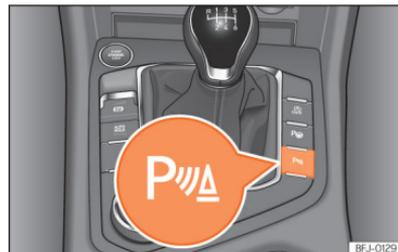
**Abb. 158** Mittelkonsole: Taste für Einparkhilfe (je nach Ausführung).
