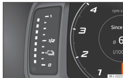
**Abb. 8** Kombi-Instrument: Anzeige des Batterieladezustands.
