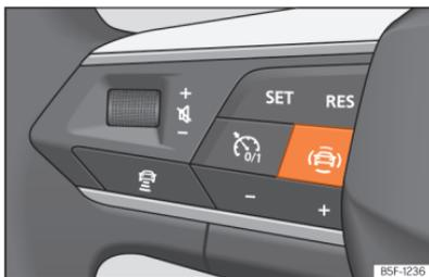
**Abb. 130** Linke Seite des Multifunktionslenkrads: Taste für die Fahrerassistenzsysteme (modellabhängig).
