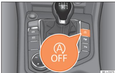
**Abb. 121** Mittelkonsole: Systemtaste Start-Stopp.
