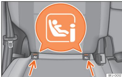
**Abb. 41** Rücksitz: Einbauort der Halteösen ISOFIX oder i-Size.
