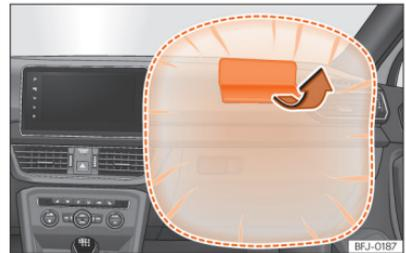
**Abb. 31** Beifahrerairbag in der Instrumententafel
