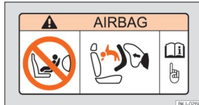
**Abb. 39** Airbag-Label: an der Sonnenblende Beifahrerseite.
