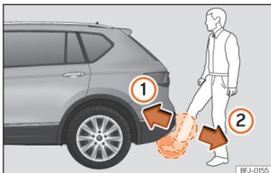
**Abb. 78** Heckklappe mit sensorgesteuerter Öffnung (Easy Open).
