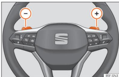
**Abb. 125** Lenkrad: die Hebel für Automatikgetriebe.
