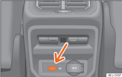
**Abb. 185** Mittelkonsole hinten: USB-Anschlüsse mit Steckdosenfunktion.
