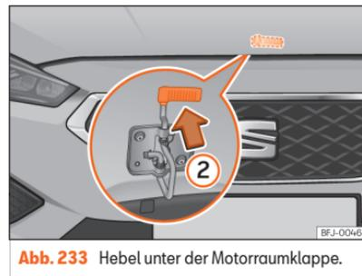
**Abb. 233** Hebel unter der Motorraumklappe.
