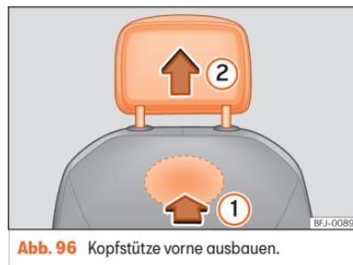
**Abb. 96** Kopfstütze vorne ausbauen.
