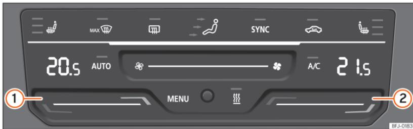
**Abb. 112** In der Mittelkonsole: Bedienelemente der Climatronic.
