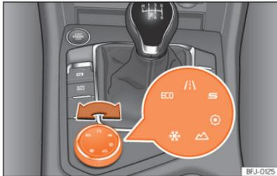
**Abb. 127** Mittelkonsole: Drehknopf [Driving Experience button].
