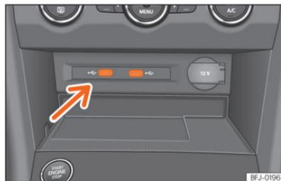
Abb. 184 Mittelkonsole: USB-Eingang.
