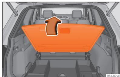
**Abb. 198** Im Gepäckraum: Variabler Gepäckraumboden hochgeklappt.
