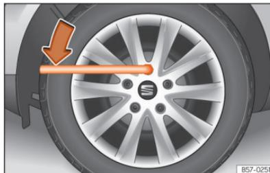
**Abb. 252** Radwechsel: Radschrauben lockern
