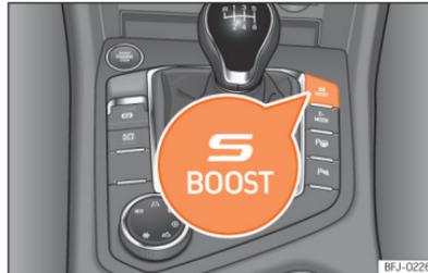
**Abb. 128** Mittelkonsole: Taste S-BOOST
