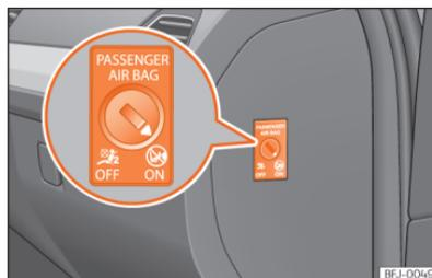
Abb. 32 Schlüsselschalter zum Ein- und Abschalten des Beifahrerairbags.
