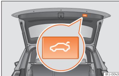
**Abb. 76** Heckklappe: Taste zum Schließen der Heckklappe.
