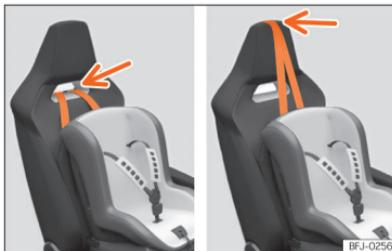
**Abb. 5** Beifahrersitz: Einstellung und Einbau unter Verwendung des Top Tether-Gurts.
