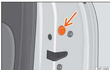
Abb. 76 Notfallsperre der Tür.
