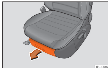
Abb. 162 Ablagefach unter dem rechten Vordersitz.
