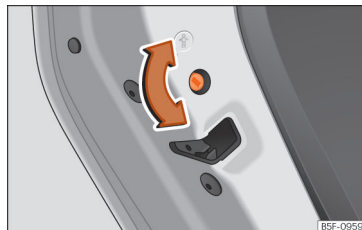
Abb. 77 Kindersicherung in der linken Tür
