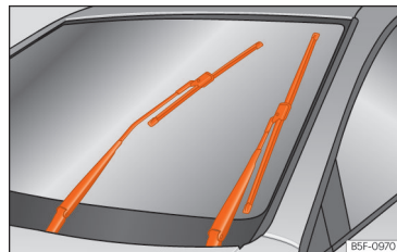
Abb. 207 Scheibenwischer in Servicestellung.
