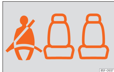
Abb. 23 Kombi-Instrument: Gurtstatusanzeige für die hinteren Sitzplätze.
