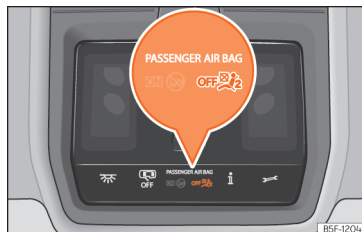
Abb. 33 In der Dachkonsole: Kontrollleuchte für Airbag Beifahrerseite aus.
