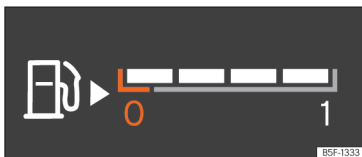
Abb. 7 Kraftstoffvorratsanzeige an verschiedenen Stellen je nach Ansicht.
