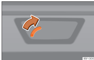
Abb. 83 Ausschnitt Gepäckraum: Notfallentriegelung (Leon Sportstourer).
