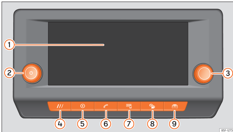
Abb. 168 Allgemeine Übersicht: Bedieneinheiten und Anzeige in der 8,25 Zoll Ausführung.
