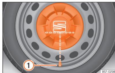
**Abb. 219** Korrekte Anbringung der Radvollblende für Stahlfelgen.
