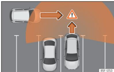
**Abb. 150** Schematische Abbildung des Ausparkassistenten: Überwachter Bereich des ausparkenden Fahrzeugs.
