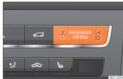
**Abb. 30** Instrumententafel: Kontrollleuchte für abgeschalteten Beifahrerairbag.
