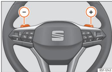
**Abb. 103** Lenkrad: die Hebel für Automatikgetriebe.
