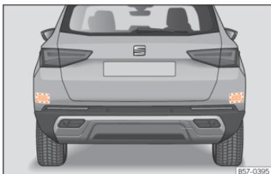
Abb. 111 Bereich hinter dem Fahrzeug: Bereiche der Radarsensoren.
