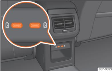
**Abb. 157** Mittelkonsole hinten: USB-Anschlüsse mit Steckdosenfunktion.
