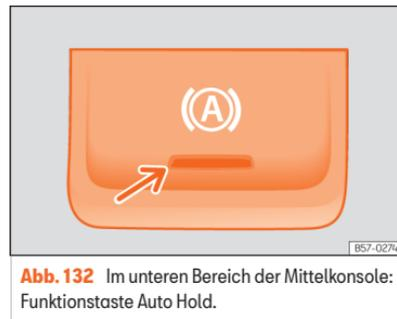
**Abb. 132** Im unteren Bereich der Mittelkonsole: Funktionstaste Auto Hold.
