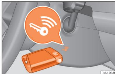
Abb. 98 Rechts an der Lenksäule: Notstart.
