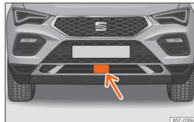
**Abb. 108** Im vorderen Stoßfänger: Radarsensor.
