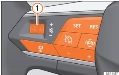
Abb. 69 Bedienelemente am Lenkrad
