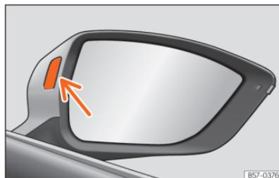
**Abb. 128** Kontrollleuchte des Spurwechselassistenten.
