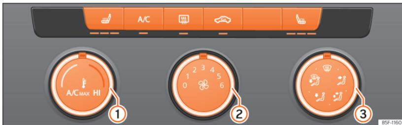
**Abb. 93** In der Mittelkonsole: Bedienelemente der manuellen Klimaanlage.
