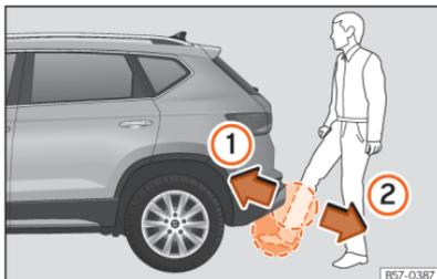
**Abb. 62** Heckklappe mit sensorgesteuerter Öffnung (Easy Open).
