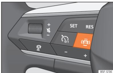
**Abb. 107** Linke Seite des Multifunktionslenkrads: Taste für die Fahrerassistenzsysteme (modellabhängig).
