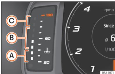
**Abb. 8** Digitales Kombi-Instrument SEAT Digital Cockpit: Motorkühlmitteltemperatur-Anzeige.
