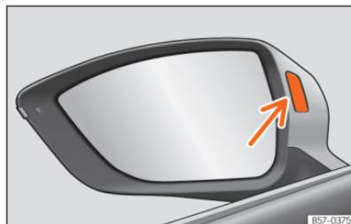
**Abb. 127** Kontrollleuchte des Spurwechselassistenten.
