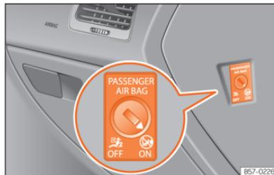
**Abb. 29** Schlüsselschalter zum Ein- und Abschalten des Beifahrerairbags.
