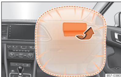
**Abb. 28** Beifahrerairbag in der Instrumententafel
