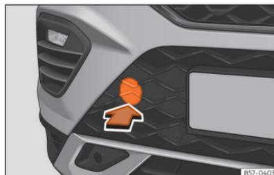
**Abb. 193** Auf der rechten Seite des vorderen Stoßängers: Abdeckung entfernen.
