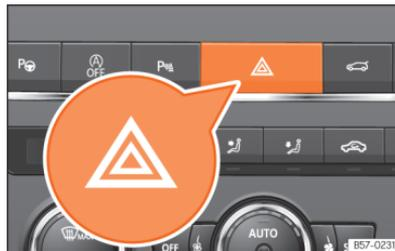
**Abb. 44** Instrumententafel: Schalter für die Warnblinkanlage
