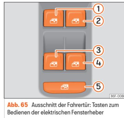
**Abb. 65** Ausschnitt der Fahrertür: Tasten zum Bedienen der elektrischen Fensterheber
