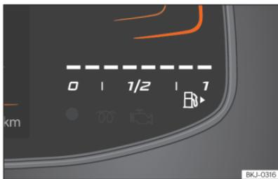
**Abb. 5** Kombi-Instrument Basic: Kraftstoffvorratsanzeige.
