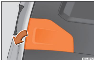
**Abb. 201** Geöffnete Heckklappe: Abdeckung entfernen.
