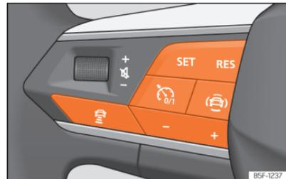
**Abb. 117** Am Multifunktionslenkrad: Tasten zur ACC-Bedienung.
