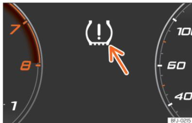
Abb. 226 Kombi-Instrument: Warnung Reifendruckverlust.
