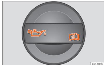
Abb. 212 Deckel der Motoröl-Einfüllöffnung im Motorraum.
