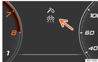
**Abb. 11** Anzeige des Assistenten für eine ökologische Fahrweise (schematische Darstellung).
