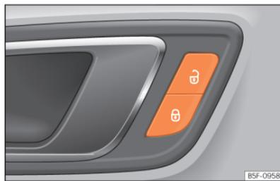
**Abb. 54** In der Fahrertür: Zentralverriegelungstaster.
