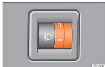
Abb. 72 Neben dem Lenkrad: Regler für die Leuchtweitenregulierung.
