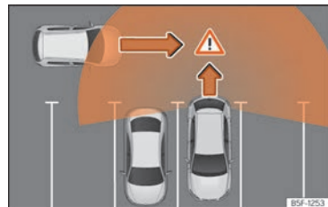
Abb. 132 Schematische Abbildung des Ausparkassistenten: Überwachter Bereich des ausparkenden Fahrzeugs.
