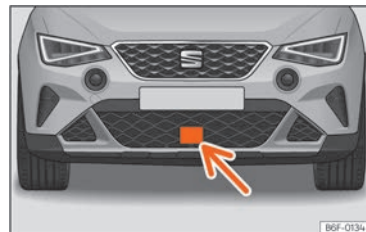
Abb. 94 Im vorderen Stoßfänger: Radarsensor.
