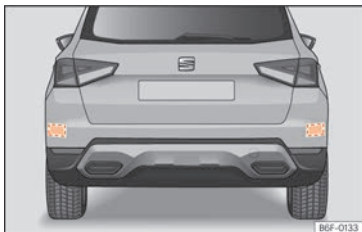
Abb. 97 Bereich hinter dem Fahrzeug: Bereiche der Radarsensoren.
