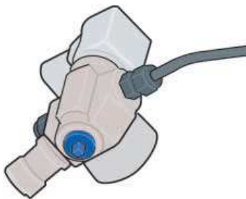
manueller Absperrhahn am Fuß des Flaschenventils.
